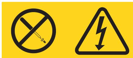
任何贴有此标签的组件内部都有危险的电压、电流和能量级别。这些组件内没有可维修的部件。如果您怀疑其中某个部件有问题，请联系技术服务人员。
