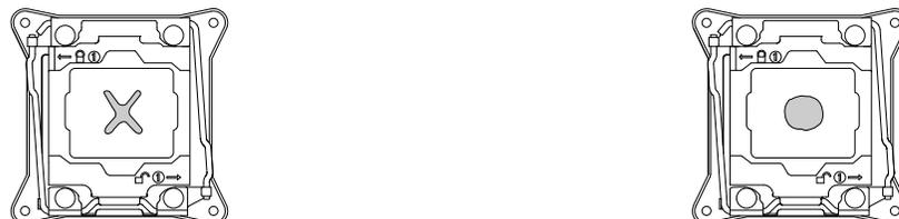
Figure 145. Application de la pâte thermoconductrice sur le dessus du microprocesseur
