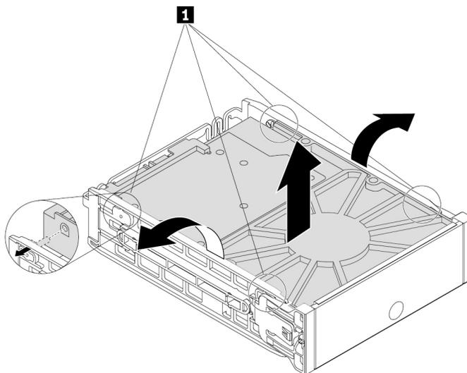
Abbildung 44. Das 3,5-Zoll-Speicherlaufwerk aus der Halterung entfernen
