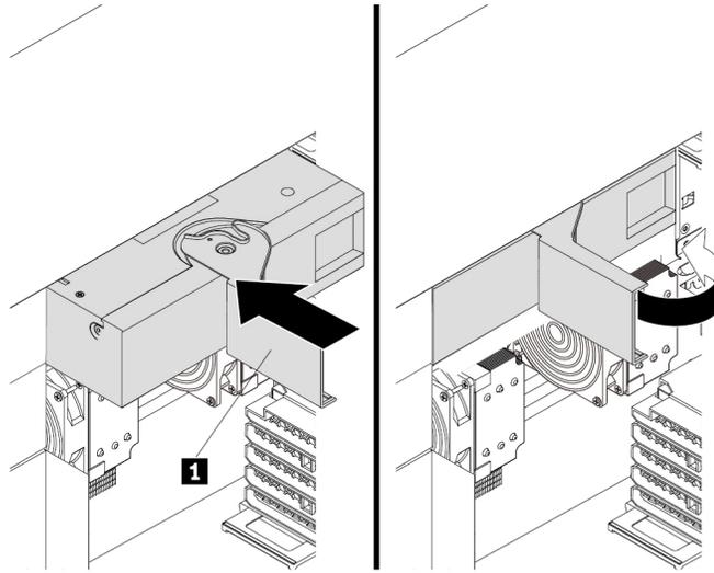
Abbildung 88. Netzteil installieren
