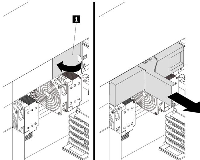
Abbildung 87. Netzteil entfernen
