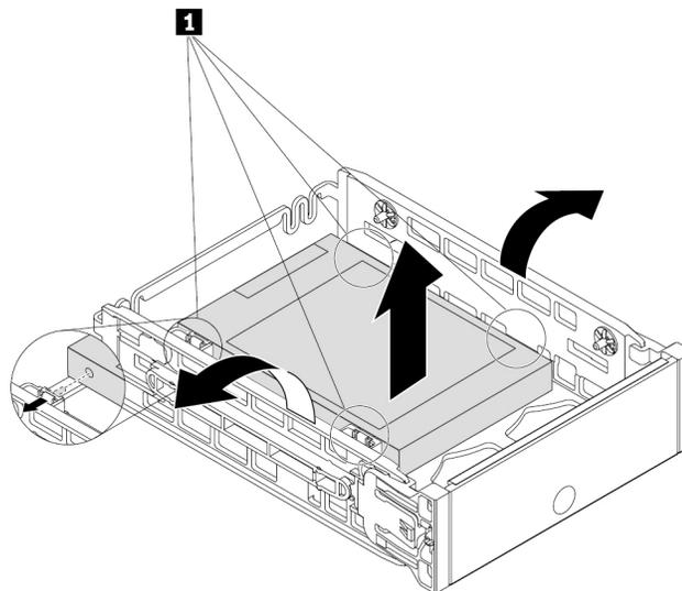
Abbildung 48. Speicherlaufwerk aus der Halterung entfernen
