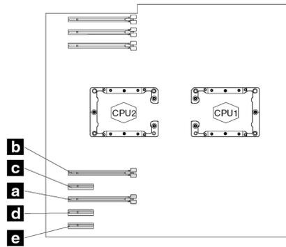
Abbildung 95. Installationsreihenfolge für PCIe-Karten für Computer mit einem Mikroprozessor
