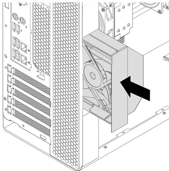
Abbildung 61. Lüftungsbaugruppe an der Rückseite installieren
