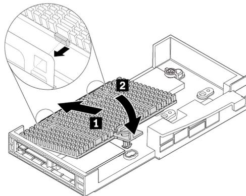
Abbildung 74. Installieren des Kühlkörpers auf der M.2-Solid-State-Laufwerkshalterung
