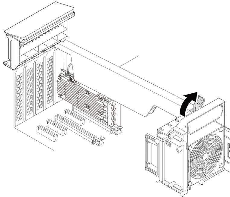
*Abbildung 116. Verriegelung in der Multifunktionsklammer öffnen*
