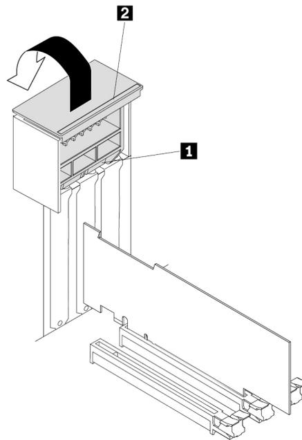
Abbildung 99. PCIe-Kartenverriegelung öffnen
