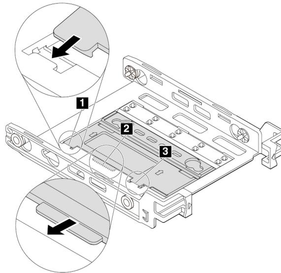
Abbildung 29. Einsetzen der Laschen in die entsprechenden Steckplätze
