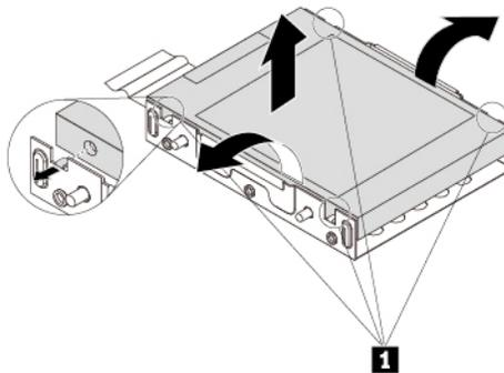
Abbildung 53. Speicherlaufwerk aus dem Adapter entfernen
