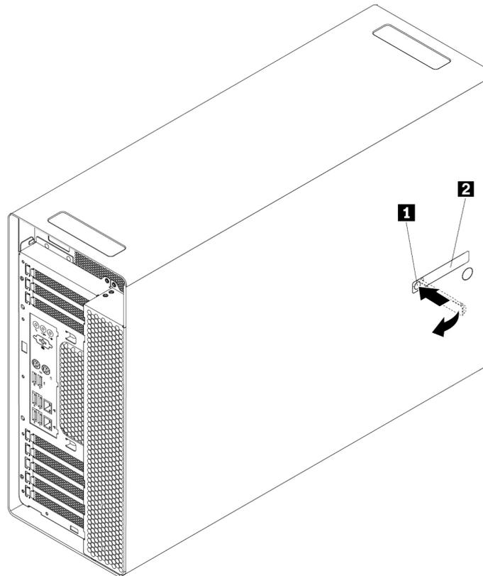
Abbildung 9. Computerabdeckung entfernen
