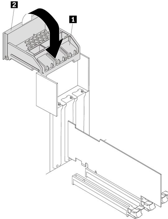
Abbildung 104. PCIe-Kartenverriegelung schließen
