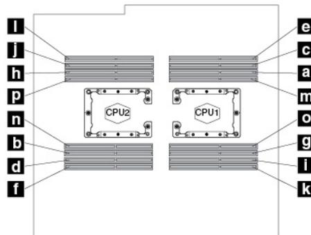
Abbildung 90. Installationsreihenfolge für Speichermodule für Computer mit zwei Mikroprozessoren
