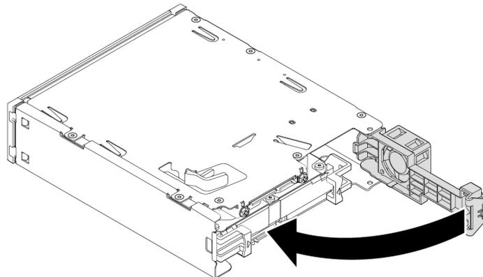
Abbildung 32. Rückwand nach innen klappen
