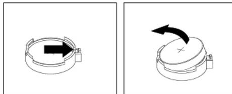
Abbildung 123. Knopfzellenbatterie entfernen
