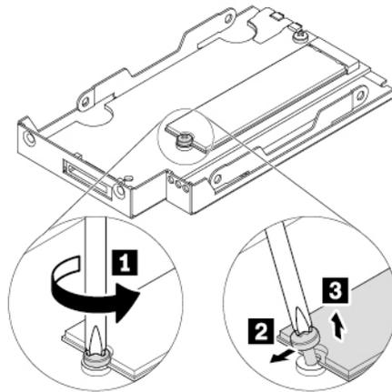
Abbildung 64. M.2-Solid-State-Laufwerk entfernen
