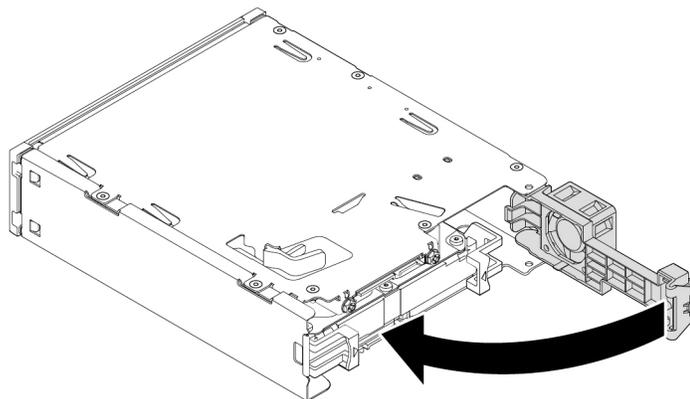
Abbildung 42. Rückwand nach innen klappen
