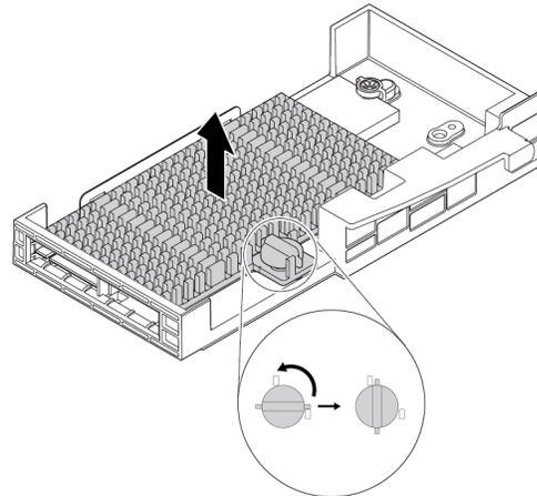
Abbildung 69. Entfernen des Kühlkörpers von der M.2-Solid-State-Laufwerkhalterung
