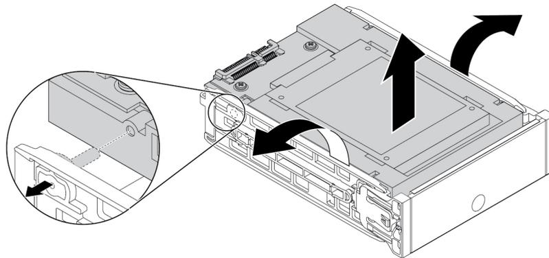
Abbildung 51. Den Konverter aus der Halterung entfernen
