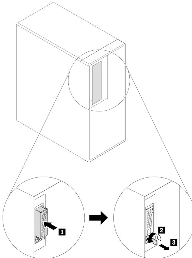
Abbildung 67. Erneutes Installieren des Trägers des M.2-Solid-State-Laufwerks
