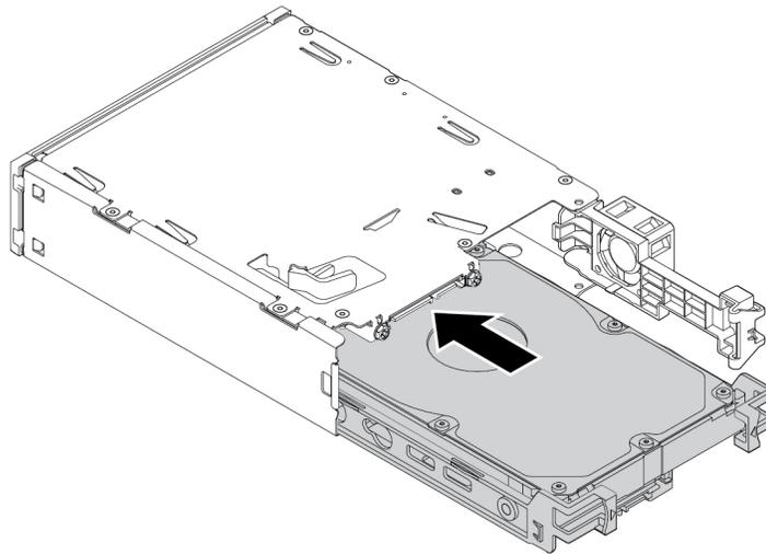
Abbildung 31. Installieren des neuen 3,5-Zoll-Speicherlaufwerks mit Halterung im Kit
