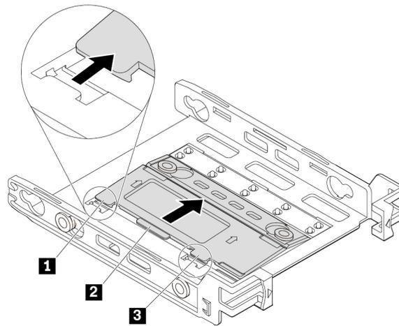
Abbildung 37. Halterung drehen
