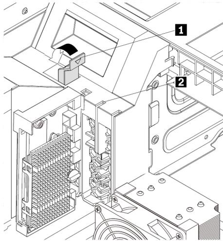
Abbildung 77. Kartenverriegelung schließen
