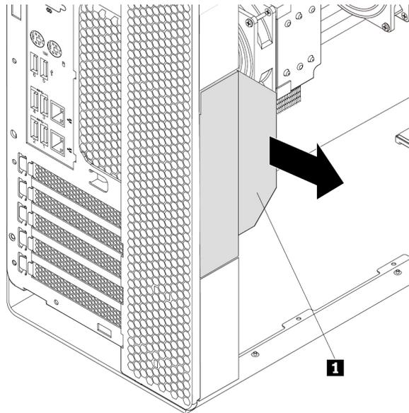
Abbildung 60. Lüftungsbaugruppe an der Rückseite entfernen
