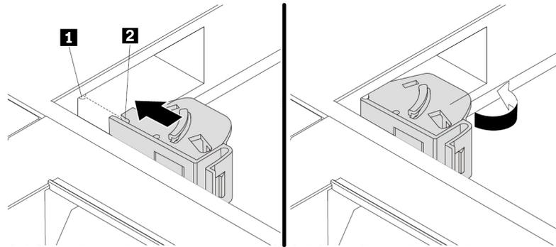
Abbildung 13. Halterung des Schalters zur Abdeckungserkennung installieren
