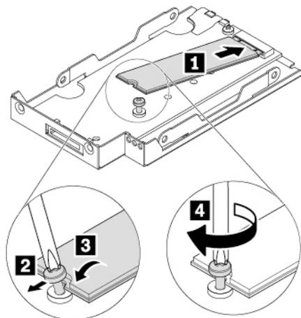
Abbildung 65. M.2-Solid-State-Laufwerk installieren
