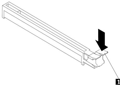
Abbildung 100. Sicherungsriegel lösen
