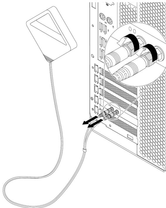
Abbildung 125. Wi-Fi-Antenne entfernen
