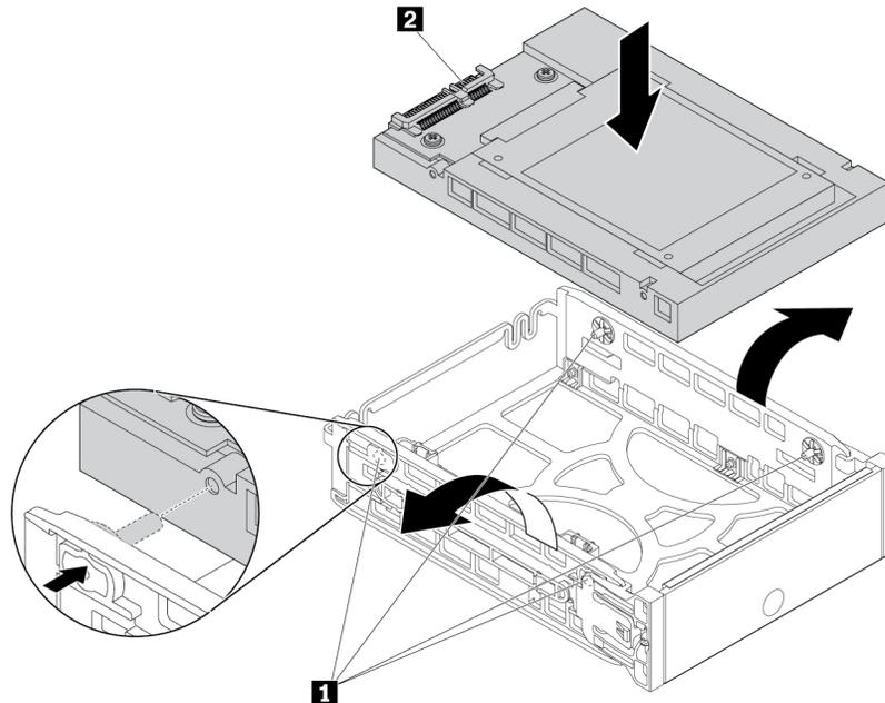
Abbildung 57. Konverter in der Halterung installieren
