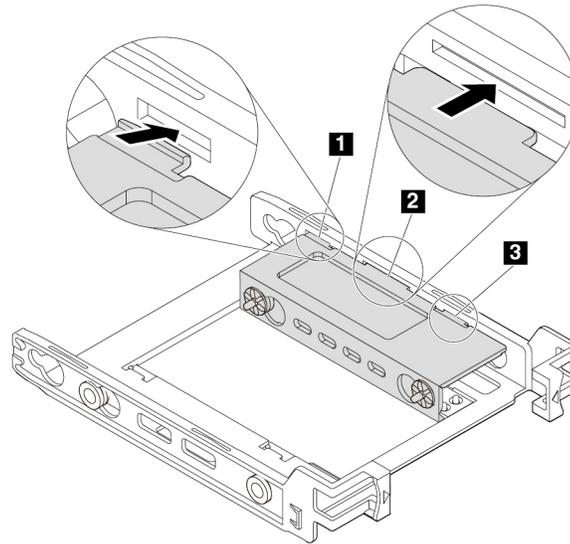
Abbildung 39. Einsetzen der Laschen in die entsprechenden Steckplätze
