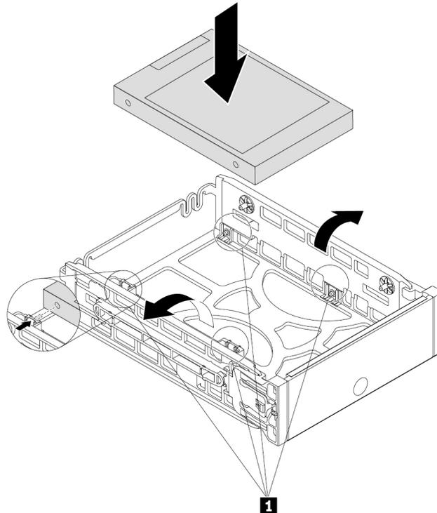
Abbildung 49. Speicherlaufwerk in der Halterung einbauen
