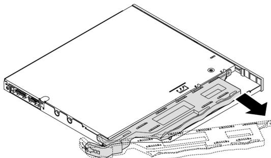
Abbildung 20. Halterung vom flachen optischen Laufwerk entfernen
