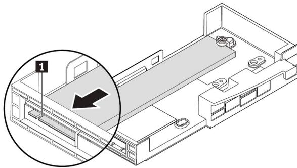
Abbildung 72. M.2-Solid-State-Laufwerk installieren
