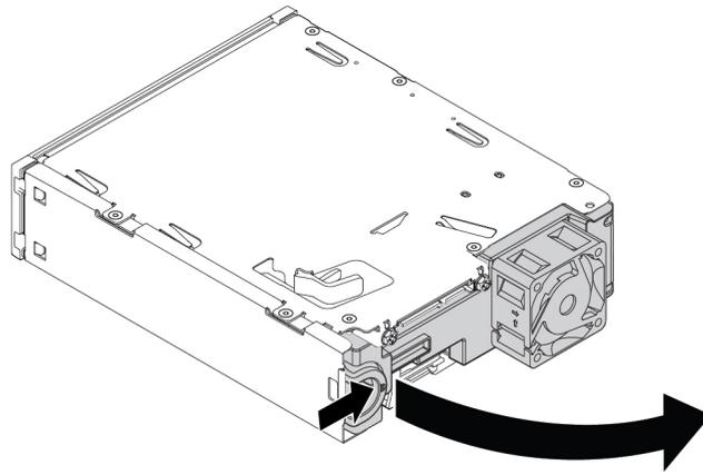
Abbildung 33. Öffnen der hinteren Abdeckung des Kits
