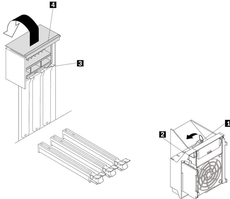
Abbildung 113. PCIe-Kartenverriegelungen öffnen
