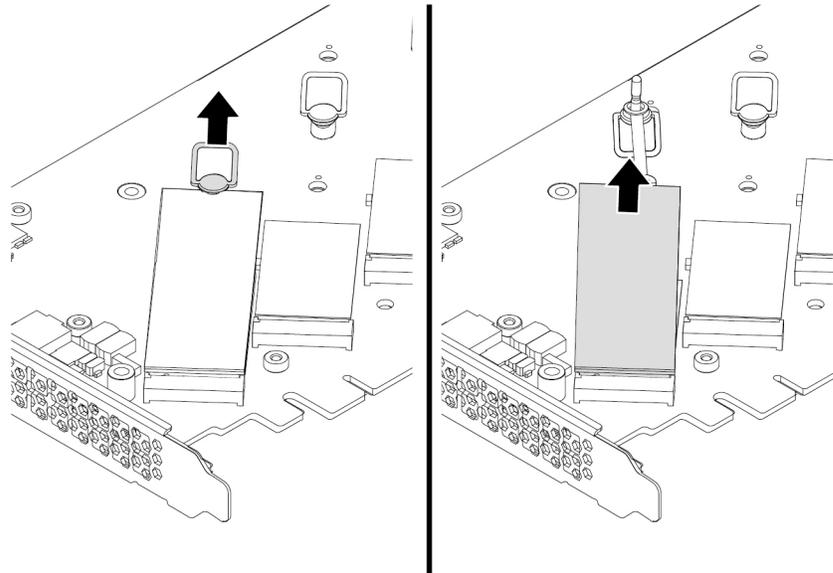
Abbildung 81. M.2-Solid-State-Laufwerk entfernen
