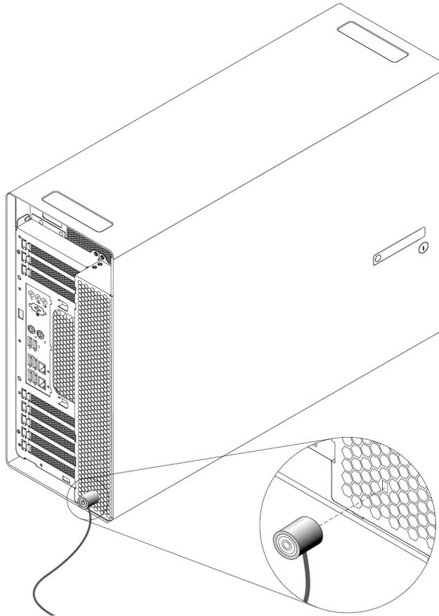
Abbildung 8. Kabelverriegelung (Kensington-Schloss)
