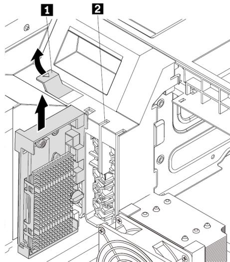
Abbildung 68. Entfernen der M.2-Solid-State-Laufwerkhalterung
