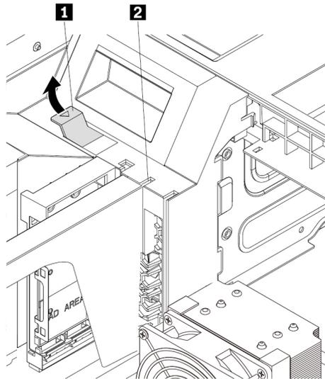
Abbildung 97. Kartenverriegelung öffnen
