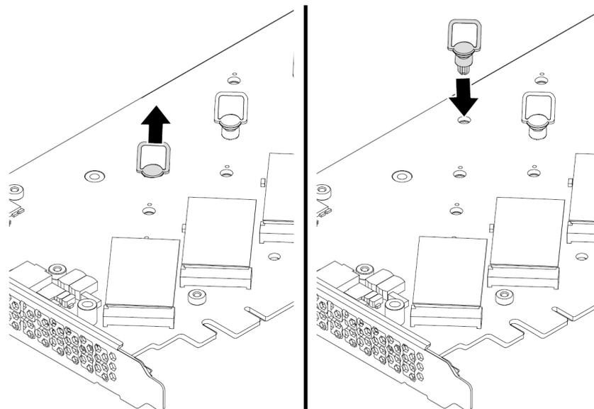
Abbildung 82. Anpassen der Position der Sicherung am PCIe-Adapter
