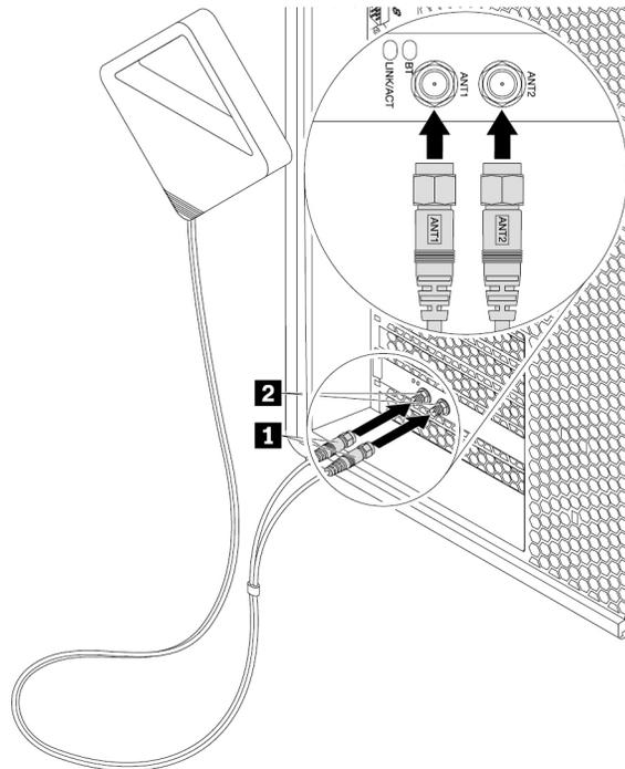
Abbildung 132. Wi-Fi-Antenne anbringen
