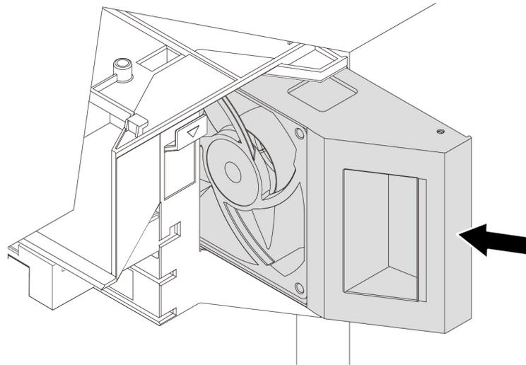
Abbildung 59. Lüftungsbaugruppe an der Vorderseite installieren
