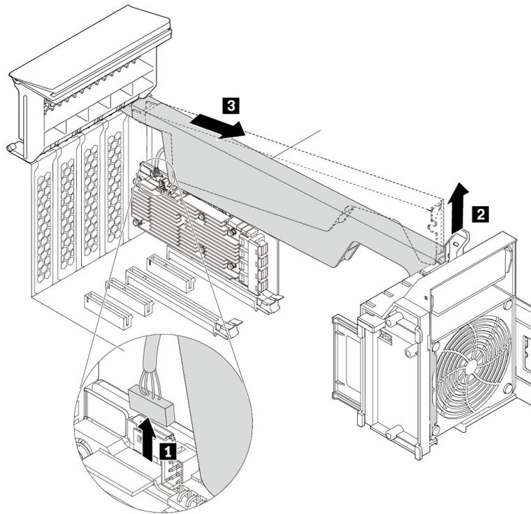
Abbildung 117. Superkondensatormodul entfernen
