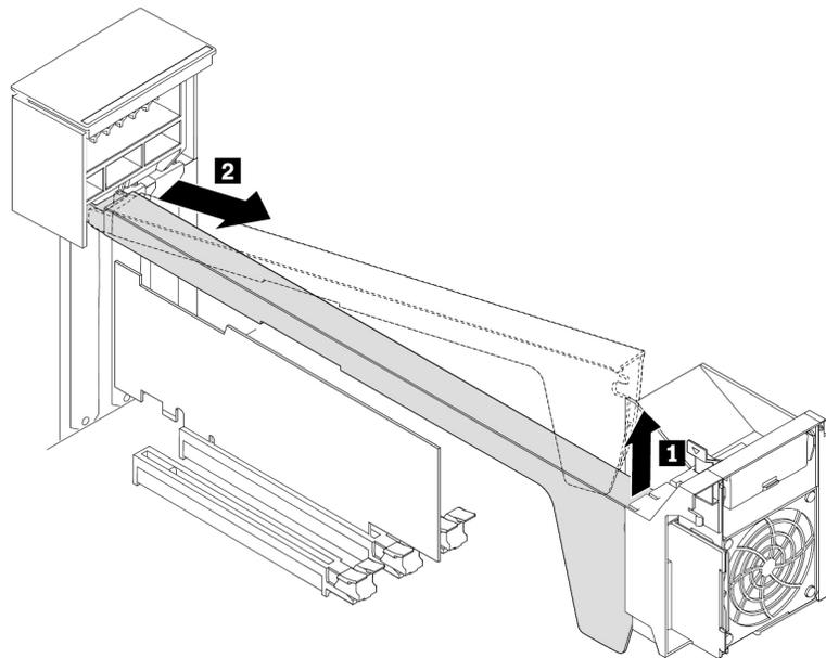
Abbildung 98. Entfernen der PCIe-Kartenhalterung
