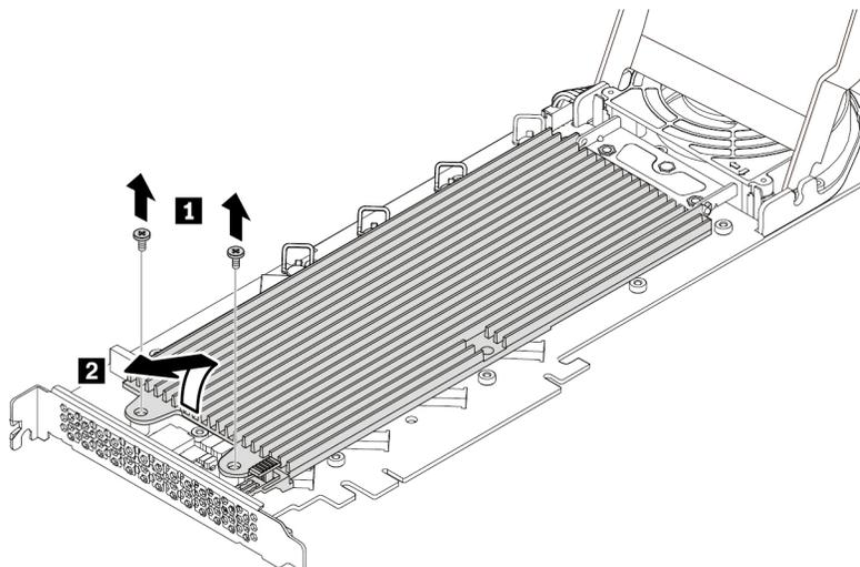
Abbildung 80. Kühlkörper entfernen
