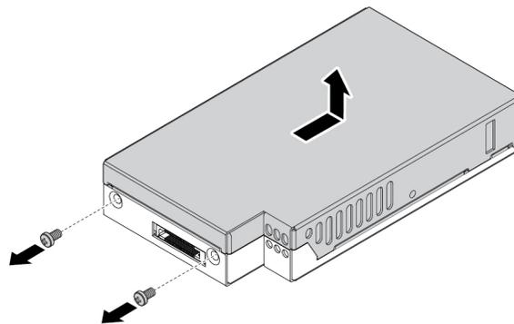
Abbildung 63. Entfernen der Abdeckung vom Träger des M.2-Solid-State-Laufwerks
