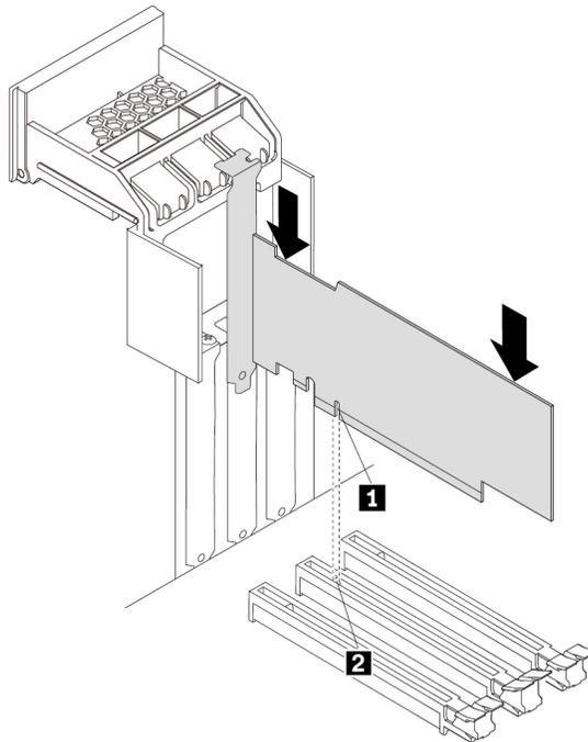
Abbildung 103. PCIe-Karte installieren
