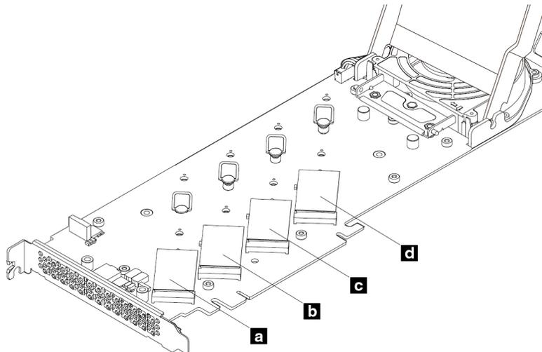
Abbildung 78. Installationsreihenfolge der M.2-Solid-State-Laufwerke
