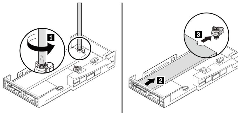
Abbildung 70. M.2-Solid-State-Laufwerk entfernen
