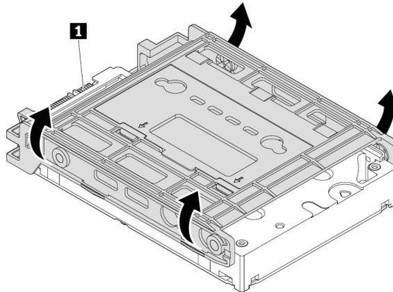
Abbildung 25. Speicherlaufwerk aus der Halterung entfernen
