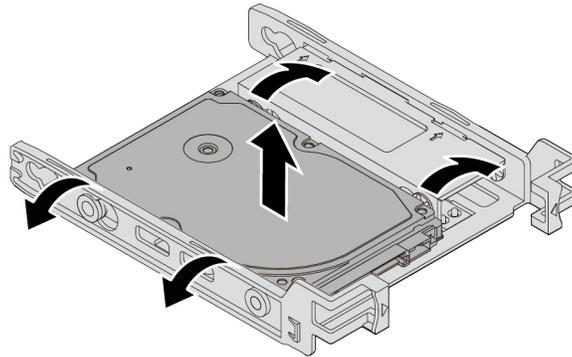
Abbildung 35. Das 2,5-Zoll-Speicherlaufwerk aus der Halterung entfernen
