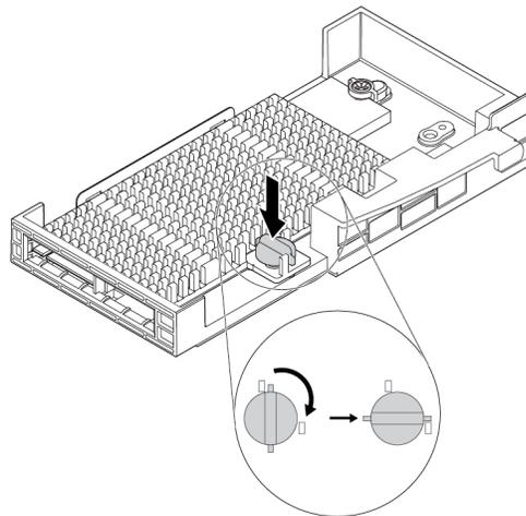
Abbildung 75. Befestigen des Kühlkörpers an der M.2-Solid-State-Laufwerkhalterung
