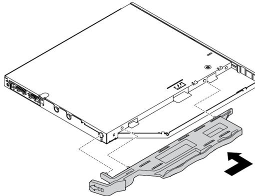
Abbildung 21. Halterung am neuen flachen optischen Laufwerk anbringen
