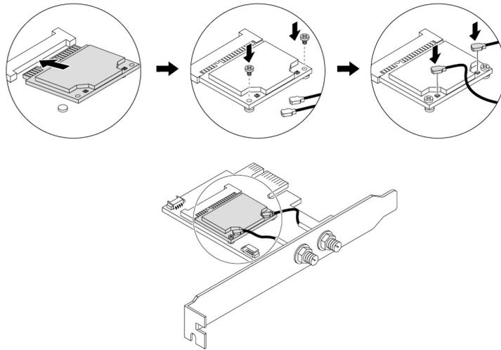
Abbildung 130. Wi-Fi-Karte installieren
