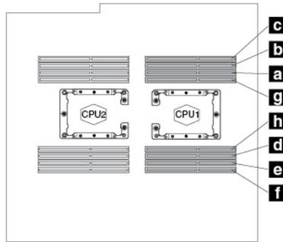
Abbildung 89. Installationsreihenfolge für Speichermodule für Computer mit einem Mikroprozessor
