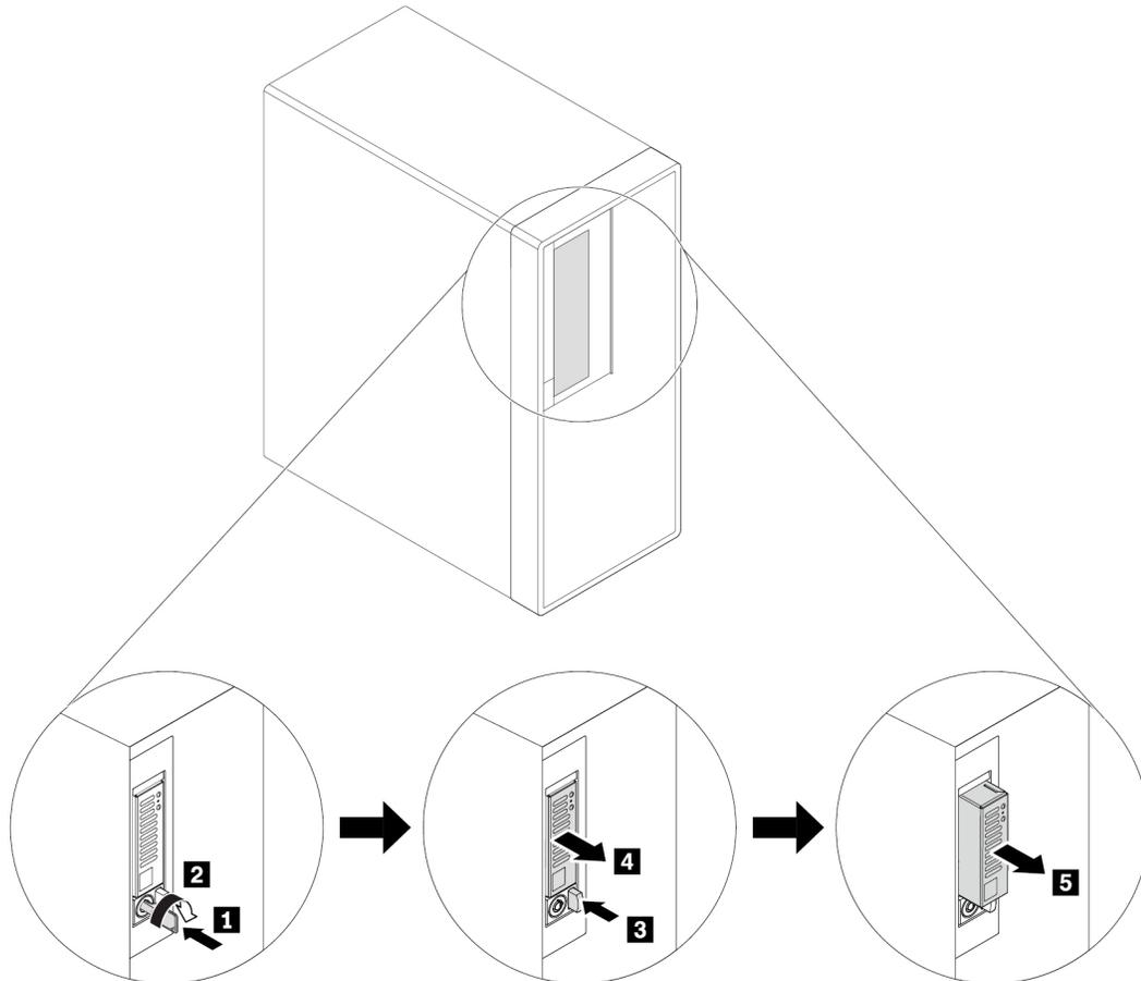
Abbildung 62. Entfernen des Trägers des M.2-Solid-State-Laufwerks
