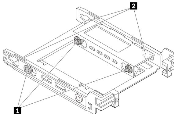
Abbildung 26. Entfernen der Stifte und erneutes Einsetzen in die Steckplätze
