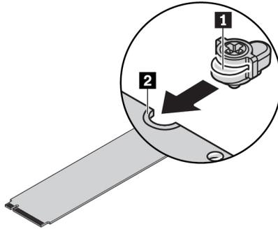
Abbildung 71. Anbringen des Schraubenhalters auf dem M.2 Solid-State-Laufwerk
