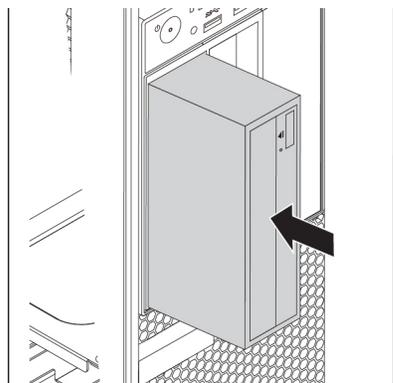
Abbildung 18. Optisches Laufwerk installieren
