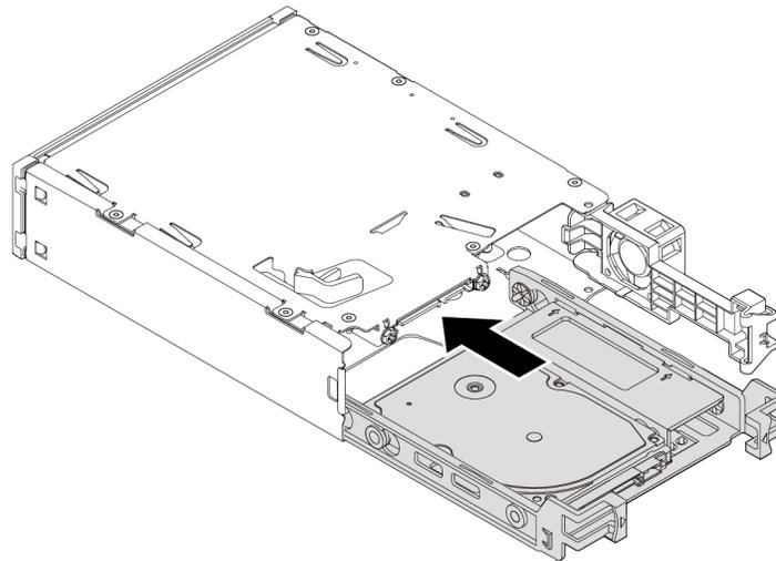
Abbildung 41. Installieren des neuen 2,5-Zoll-Speicherlaufwerks mit Halterung im Kit
