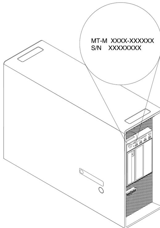
Abbildung 6. Etikett für Maschinentyp und -modell
