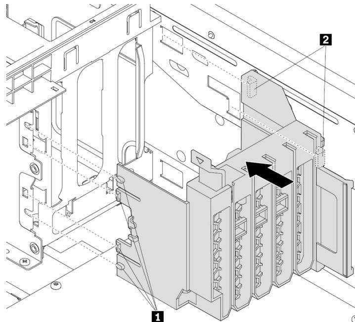
Abbildung 122. Multifunktionshalterung erneut installieren
