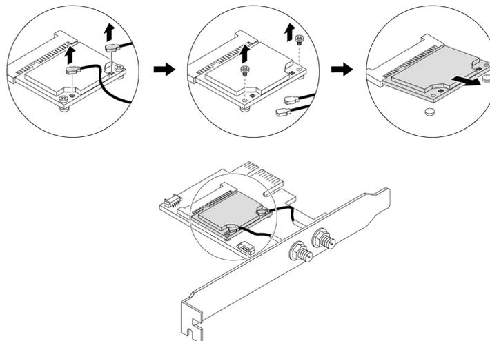
Abbildung 129. Wi-Fi-Karte entfernen
