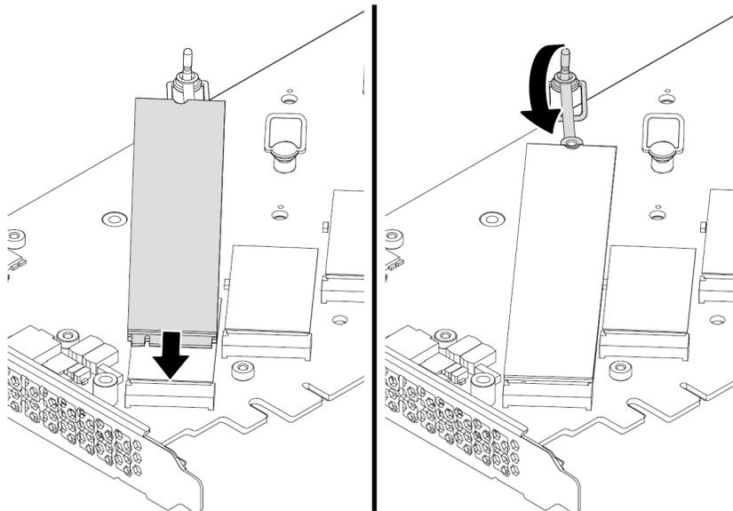
Abbildung 84. M.2-Solid-State-Laufwerk installieren
