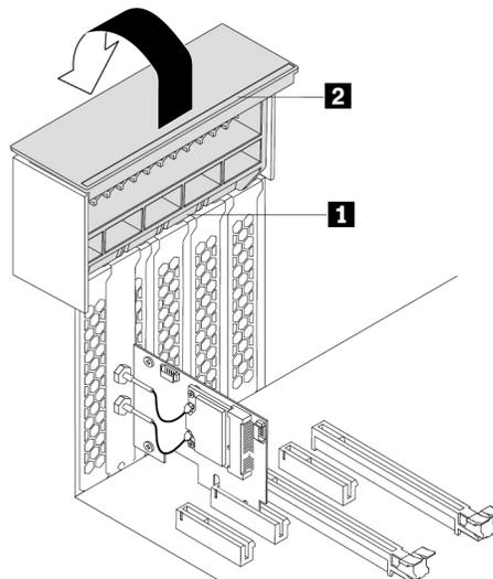
Abbildung 127. PCIe-Kartenverriegelung öffnen
