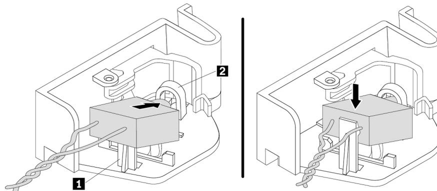
Abbildung 12. Schalter zur Abdeckungserkennung in der Halterung installieren
