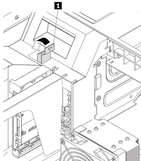
Abbildung 106. Kartenverriegelung schließen
