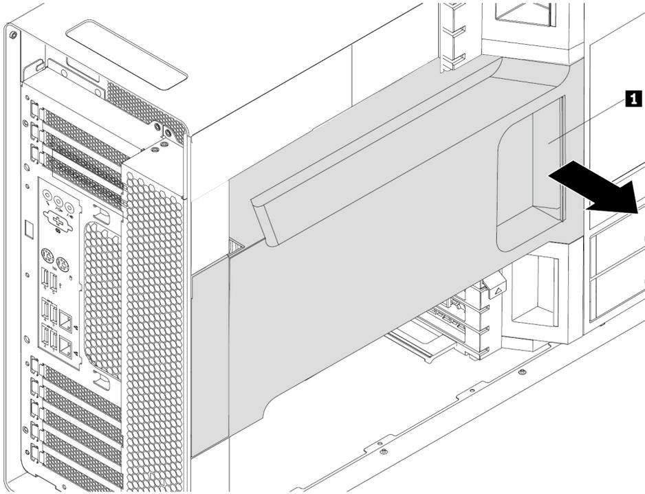
Abbildung 14. Direkte Kühlungsluftführung entfernen
