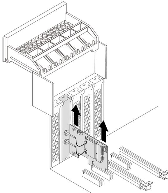
Abbildung 128. Den Wi-Fi-Adapter entfernen
