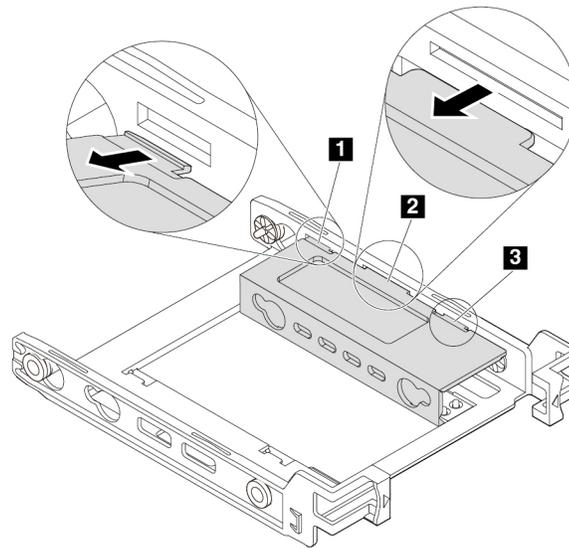
Abbildung 27. Lösen der Laschen aus den entsprechenden Steckplätzen
