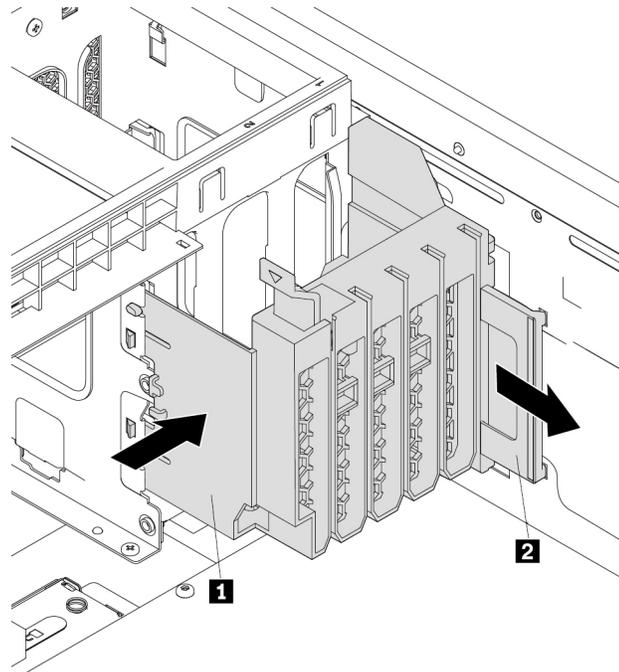
Abbildung 121. Multifunktionshalterung entfernen
