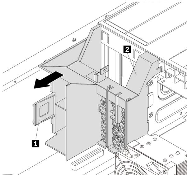
Abbildung 119. Multifunktionshalterung entfernen
