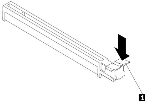
Abbildung 110. Sicherungsriegel lösen
