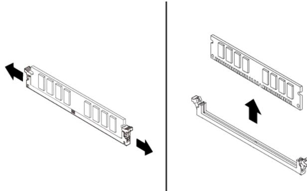
Abbildung 92. Speichermodul entfernen
