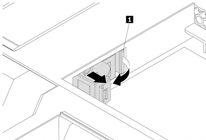
Abbildung 10. Halterung des Schalters zur Abdeckungserkennung entfernen
