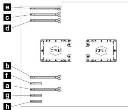
Abbildung 96. Installationsreihenfolge für PCIe-Karten für Computer mit zwei Mikroprozessoren
