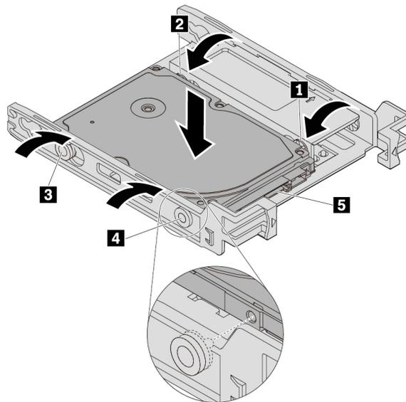
Abbildung 40. Installieren des neuen 2,5-Zoll-Speicherlaufwerks in der Halterung
