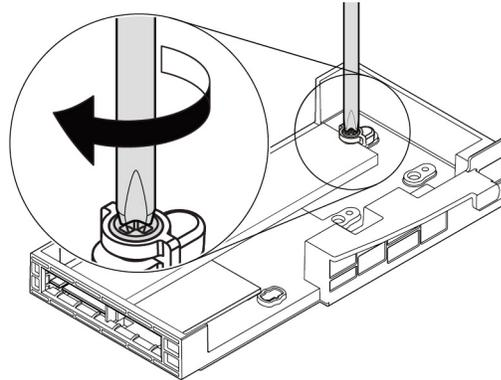
Abbildung 73. Befestigen des M.2-Solid-State-Laufwerks
