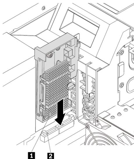
Abbildung 76. Installieren der M.2-Solid-State-Laufwerkhalterung
