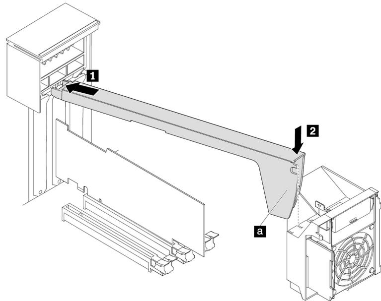
Abbildung 105. Installieren der PCIe-Kartenhalterung
