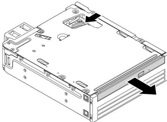
Abbildung 19. Flaches optisches Laufwerk aus dem Kit entfernen
