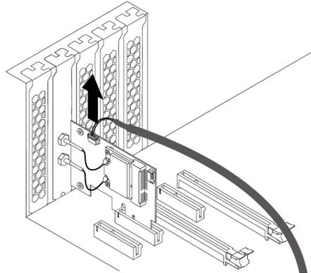
Abbildung 126. Bluetooth-Kabel abziehen
