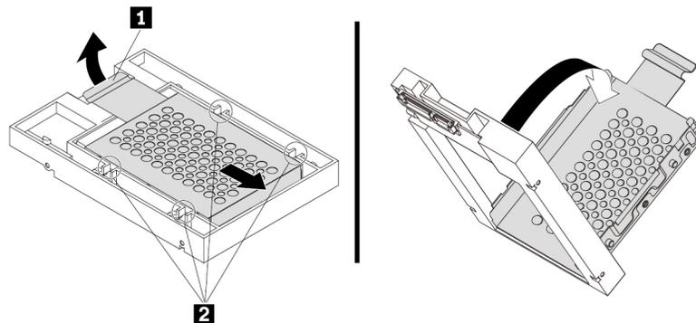
Abbildung 54. Adapter aus dem Konverter entfernen
