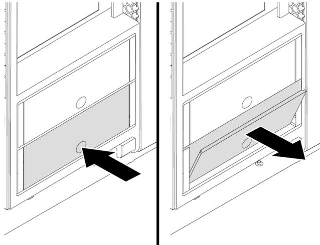
Abbildung 43. Halterung für das Speicherlaufwerk entfernen
