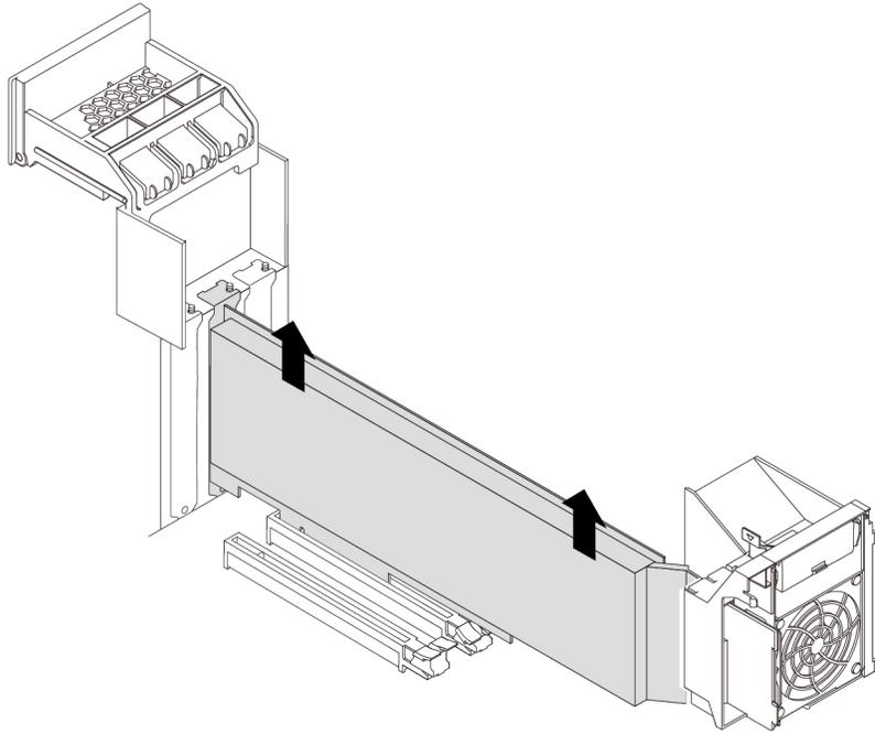
Abbildung 112. Lange PCIe-Karte entfernen
