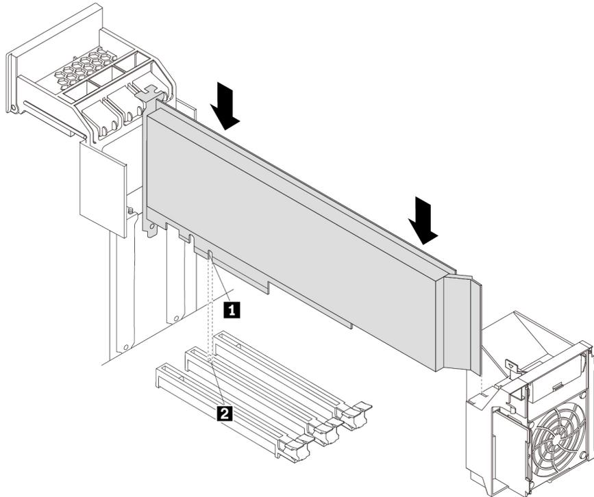
Abbildung 114. Lange PCIe-Karte installieren
