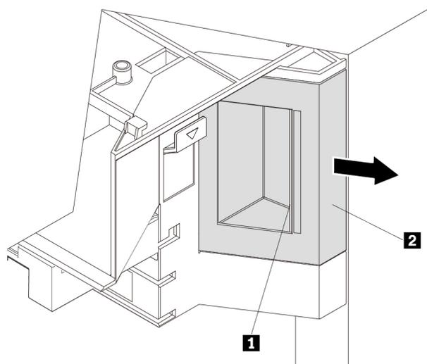
Abbildung 58. Lüftungsbaugruppe an der Vorderseite entfernen
