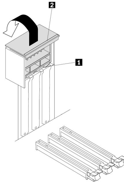
Abbildung 102. PCIe-Kartenverriegelung öffnen
