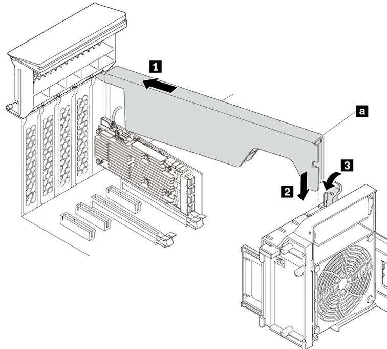
Abbildung 118. Superkondensatormodul installieren
