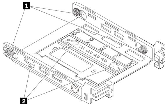
Abbildung 36. Entfernen der Stifte und erneutes Einsetzen in die neuen Steckplätze
