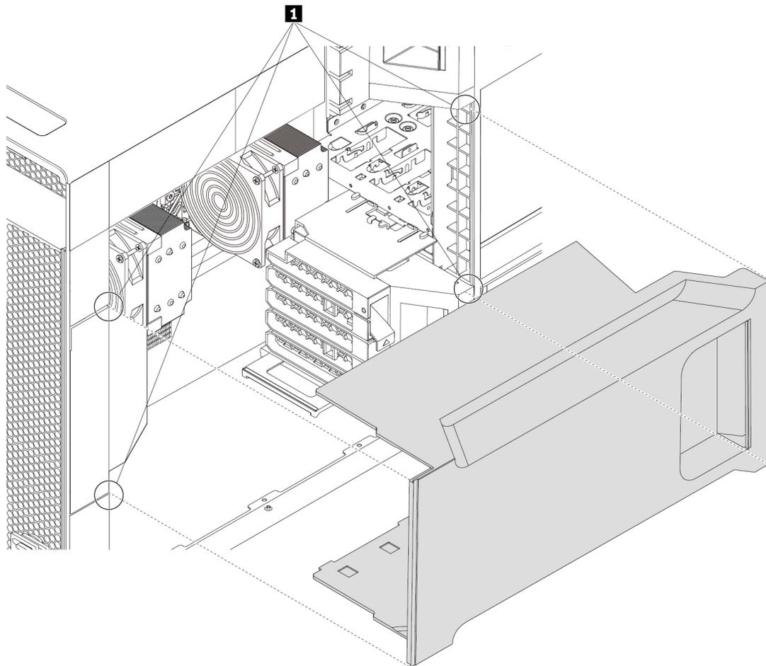
Abbildung 15. Plastikabdeckungen an den kleinen Spalten ausrichten
