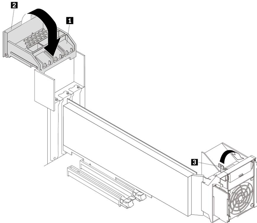
Abbildung 115. PCIe-Kartenverriegelungen schließen
