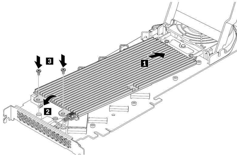
Abbildung 85. Installation des Kühlkörpers am PCIe-Adapter
