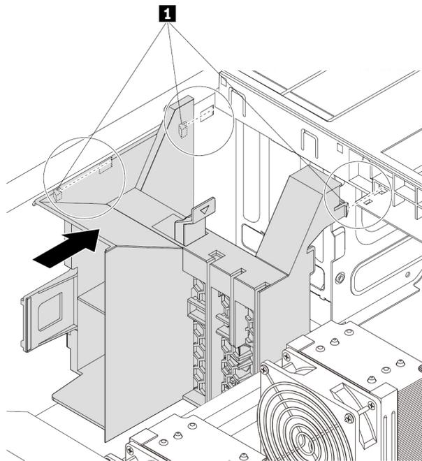
Abbildung 120. Multifunktionshalterung erneut installieren
