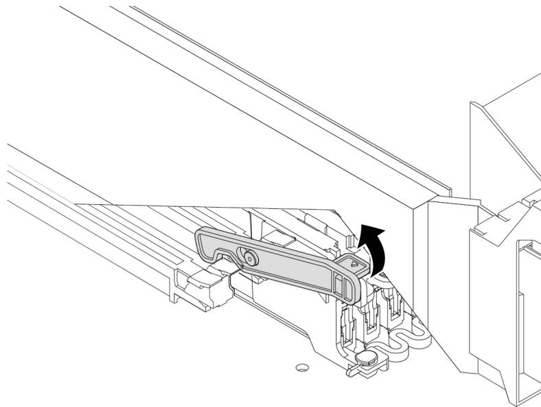
Abbildung 111. Sicherungsriegel des PCIe-Kartensteckplatzes lösen
