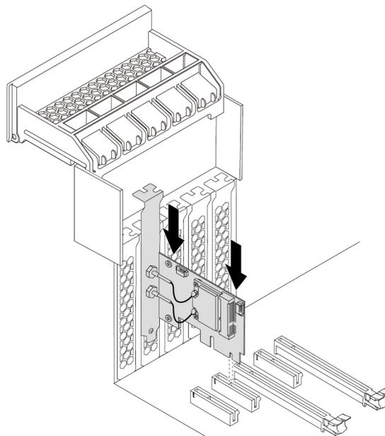
Abbildung 131. Den Wi-Fi-Adapter installieren
