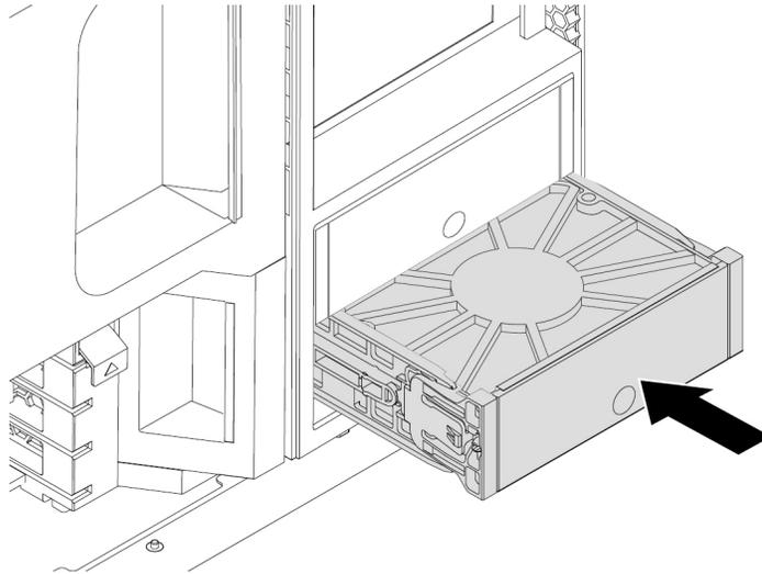
Abbildung 46. Halterung des Speicherlaufwerks installieren
