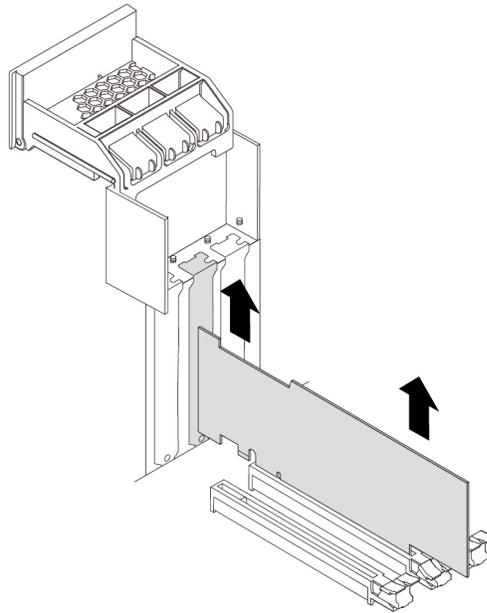
Abbildung 101. PCIe-Karte entfernen
