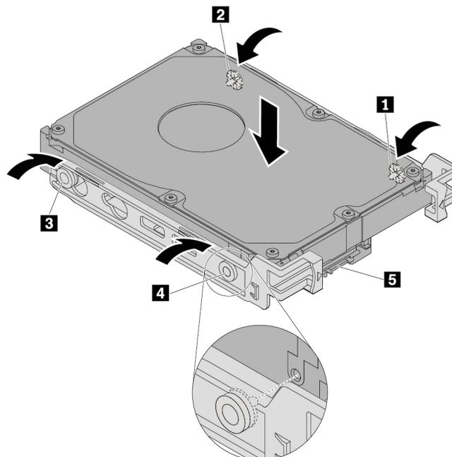
Abbildung 30. Installieren des neuen 3,5-Zoll-Speicherlaufwerks in der Halterung
