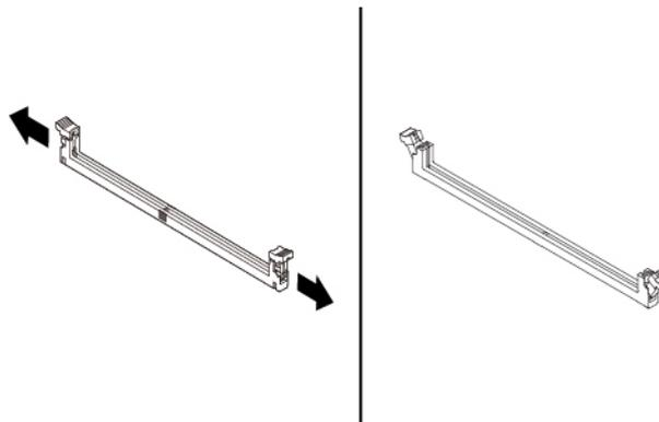
Abbildung 93. Halteklammern öffnen
