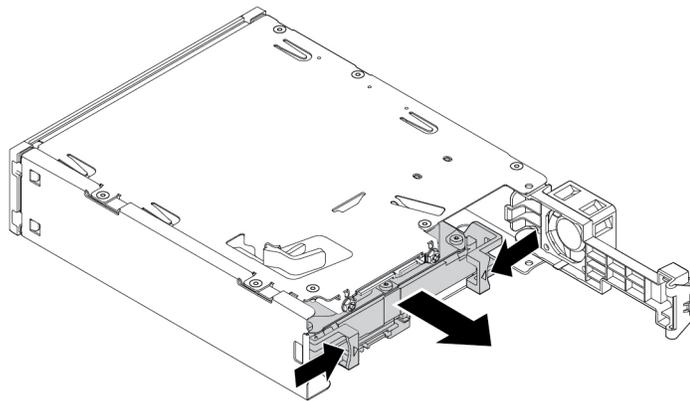
Abbildung 34. Das 2,5-Zoll-Speicherlaufwerk aus dem Kit entfernen
