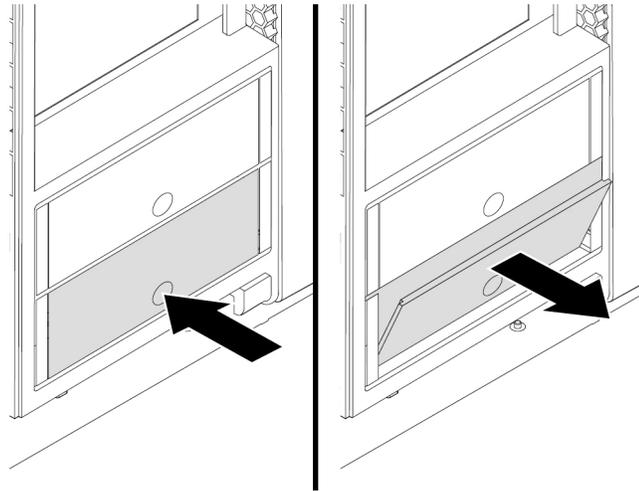
Abbildung 50. Halterung für das Speicherlaufwerk entfernen
