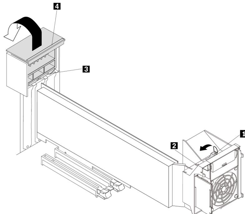
Abbildung 109. PCIe-Kartenverriegelungen öffnen
