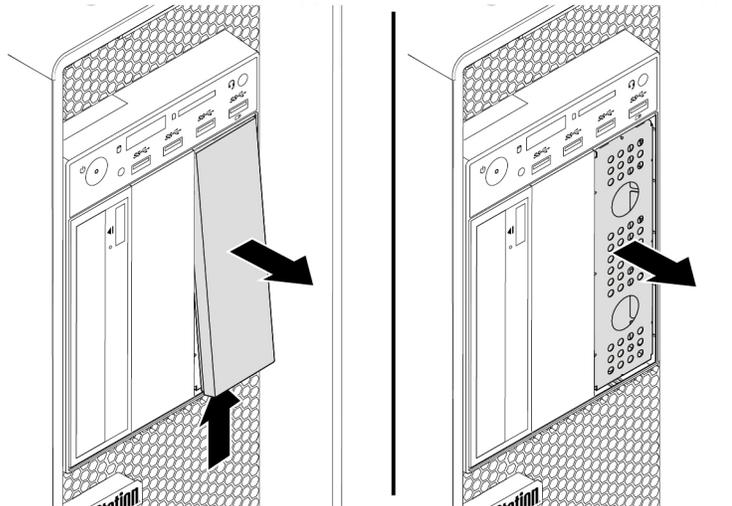
Abbildung 17. Abdeckungen aus der Flex-Position entfernen
