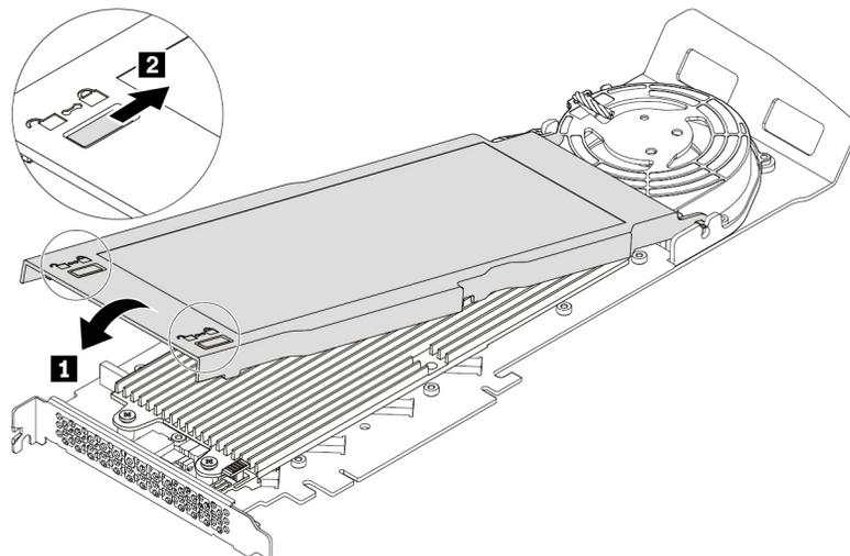
Abbildung 86. Schließen der Abdeckung
