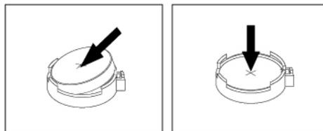
Abbildung 124. Knopfzellenbatterie installieren
