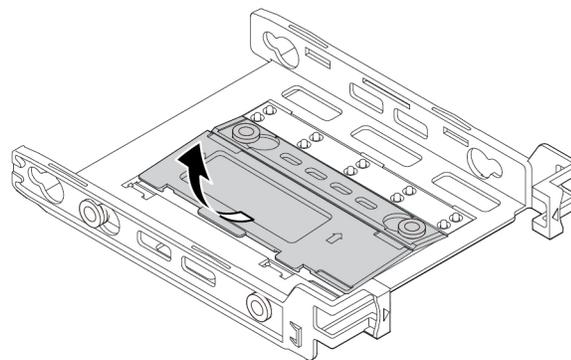
Abbildung 38. Halterung nach oben klappen
