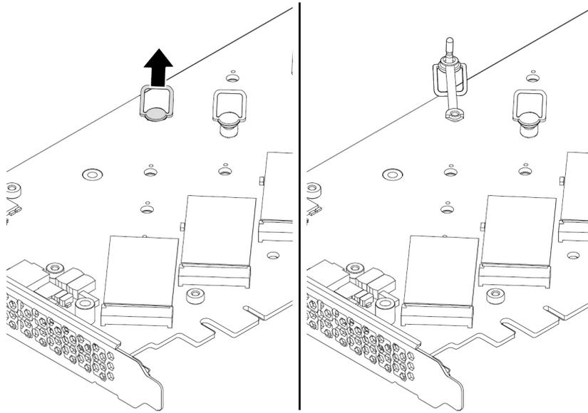
Abbildung 83. Öffnen der Sicherung
