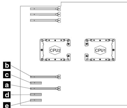
Abbildung 107. Installationsreihenfolge für PCIe-Karten für Computer mit einem Mikroprozessor
