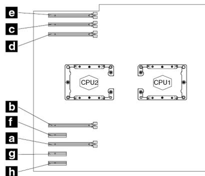
Abbildung 108. Installationsreihenfolge für PCIe-Karten für Computer mit zwei Mikroprozessoren
