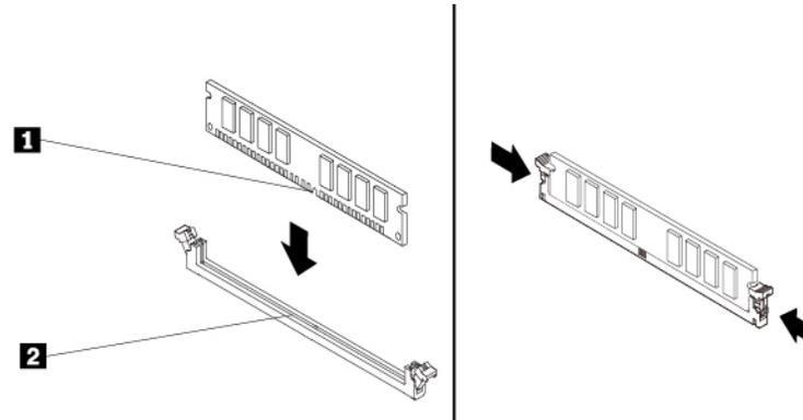
Abbildung 94. Speichermodul installieren
