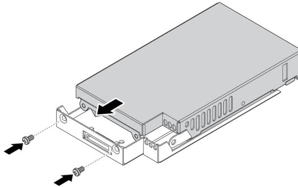
Abbildung 66. Installieren der Abdeckung am Träger des M.2-Solid-State-Laufwerks
