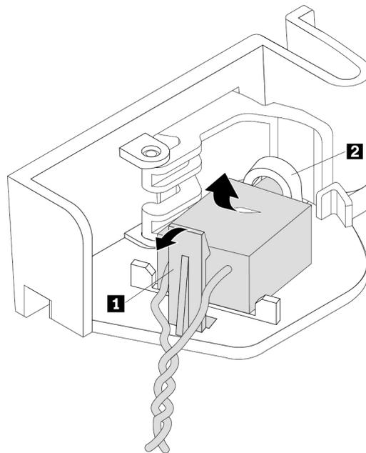
Abbildung 11. Schalter zur Abdeckungserkennung aus der Halterung entfernen
