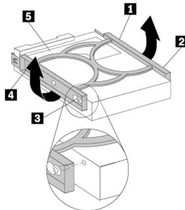
Abbildung 98. Speicherlaufwerk in der Halterung einbauen
