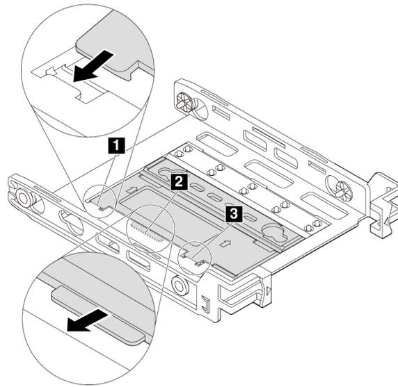
Abbildung 74. Einsetzen der Laschen in die entsprechenden Steckplätze
