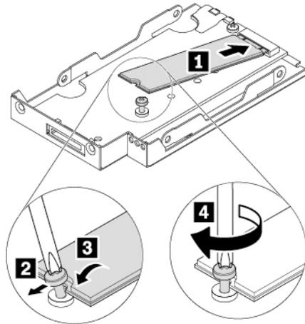
Abbildung 61. M.2-Solid-State-Laufwerk installieren
