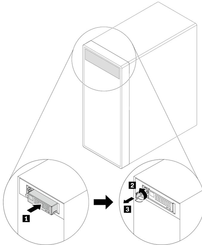
Abbildung 63. Erneutes Installieren des Trägers des M.2-Solid-State-Laufwerks
