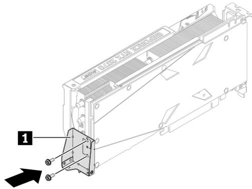
Abbildung 30. Anbringen der beiden Schrauben
