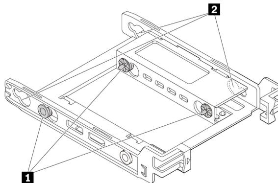
Abbildung 71. Stifte entfernen und in Steckplätze einsetzen
