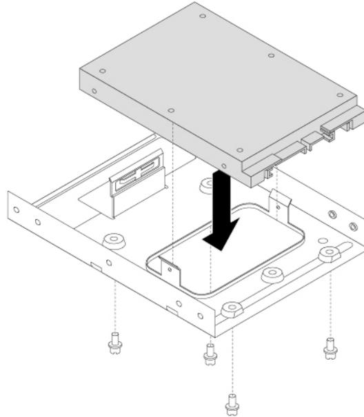
Abbildung 102. Ein neues 2,5-Zoll-Speicherlaufwerk in den Speicherlaufwerkskonverter einsetzen
