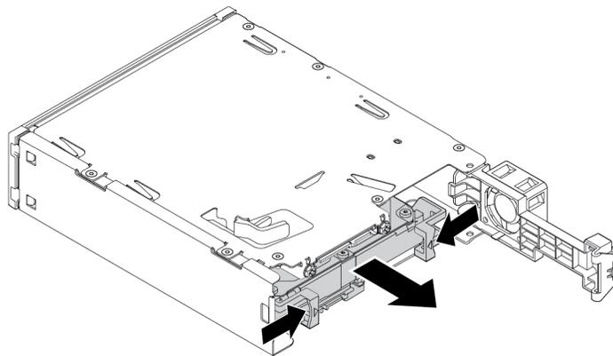
Abbildung 69. Entfernen der Adapterhalterung aus dem Kit
