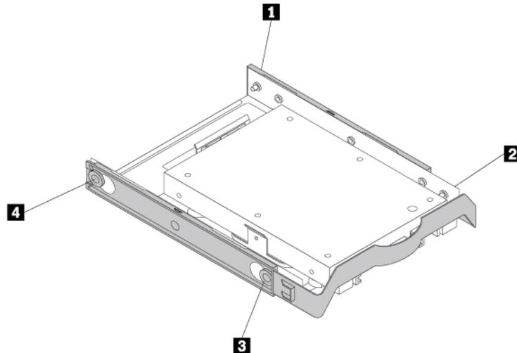
Abbildung 103. Neuen Speicherlaufwerkskonverter mit 2,5-Zoll-Speicherlaufwerk in der Halterung des Speicherlaufwerks installieren
