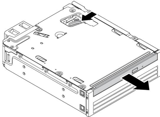
Abbildung 64. Flaches optisches Laufwerk aus dem Kit entfernen
