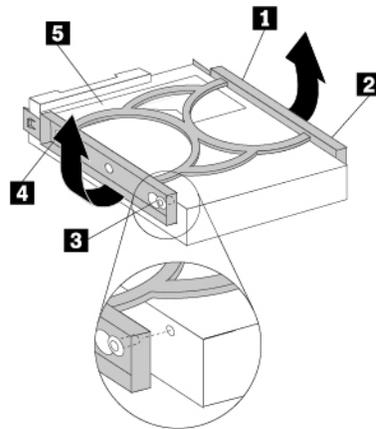
Abbildung 95. Speicherlaufwerk in der Halterung einbauen
