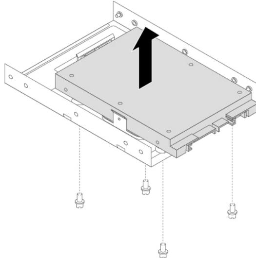
*Abbildung 101. 2,5-Zoll-Speicherlaufwerk aus dem Speicherlaufwerkskonverter entfernen*
