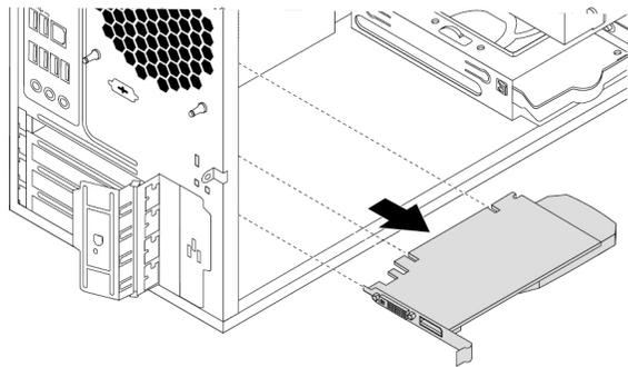
Abbildung 15. PCIe-Karte entfernen
