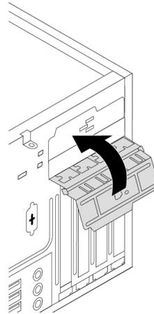
Abbildung 24. PCIe-Kartenverriegelung schließen
