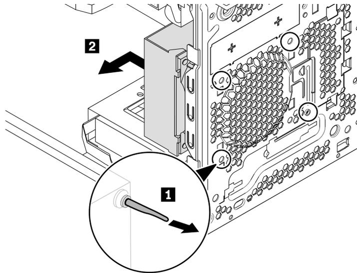
Abbildung 104. Lüftungsbaugruppe an der Vorderseite entfernen
