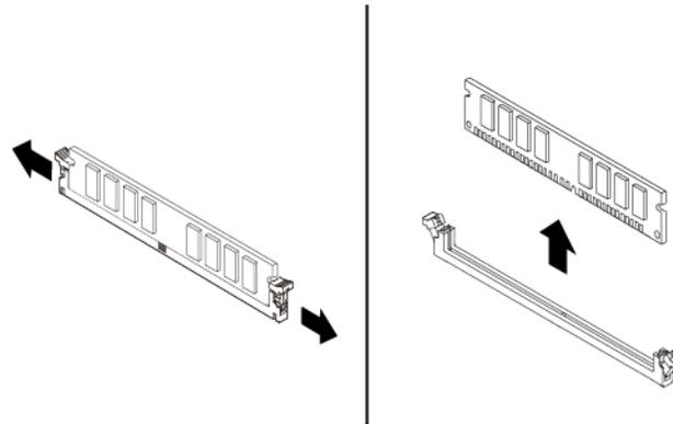
Abbildung 36. Speichermodul entfernen
