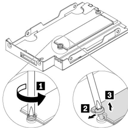
Abbildung 60. M.2-Solid-State-Laufwerk entfernen
