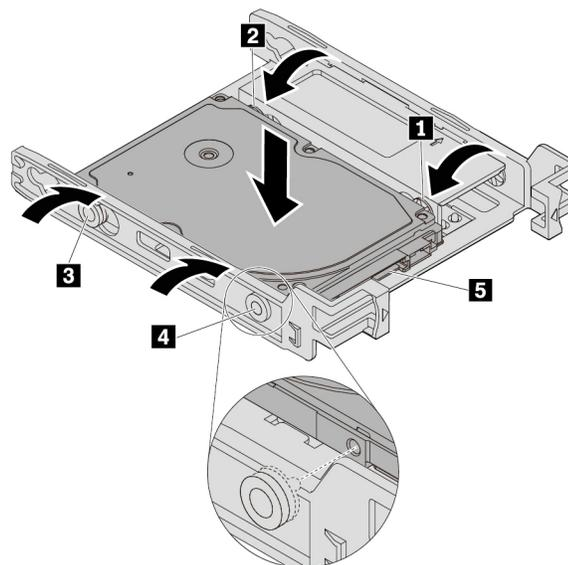
Abbildung 85. Installieren des neuen 2,5-Zoll-Speicherlaufwerks in der Halterung
