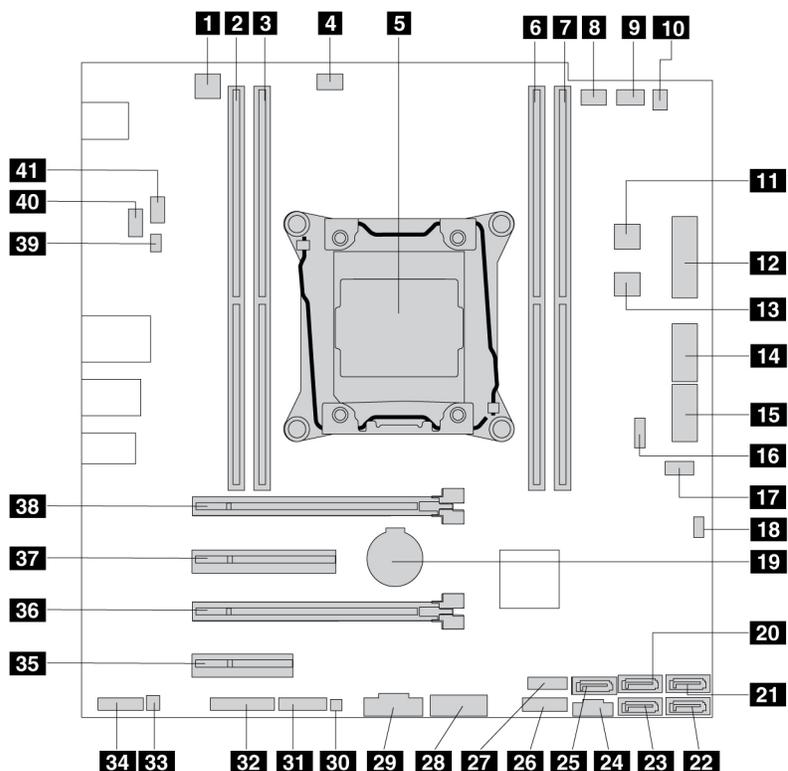
Abbildung 4. Positionen der Komponenten auf der Systemplatine
