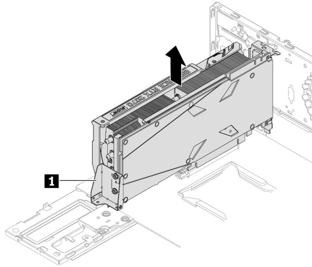
Abbildung 27. Entfernen der langen PCIe-Karte mit Halterung **1**
