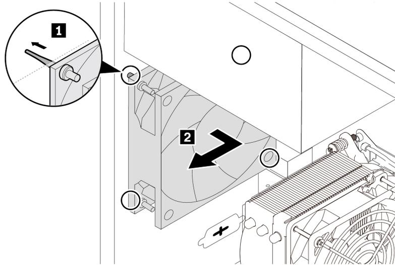
Abbildung 106. Lüftungsbaugruppe an der Rückseite entfernen
