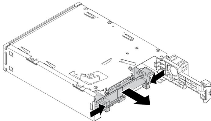
Abbildung 79. Das 2,5-Zoll-Speicherlaufwerk aus dem Kit entfernen
