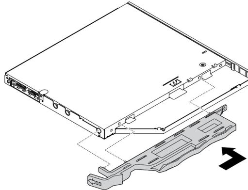
Abbildung 66. Halterung am neuen flachen optischen Laufwerk anbringen
