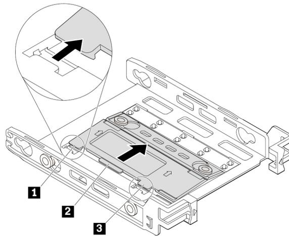
Abbildung 82. Halterung drehen
