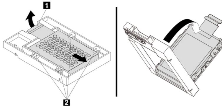
Abbildung 52. Adapter aus dem Konverter entfernen
