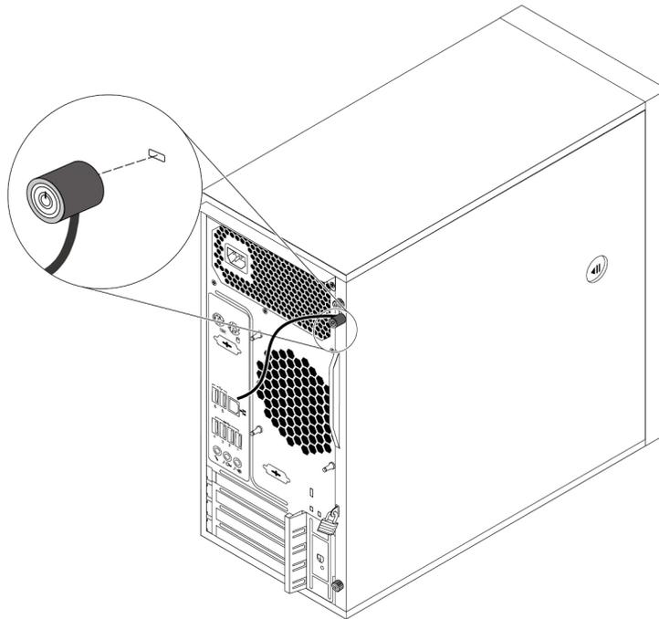
Abbildung 8. Kabelverriegelung (Kensington-Schloss)
