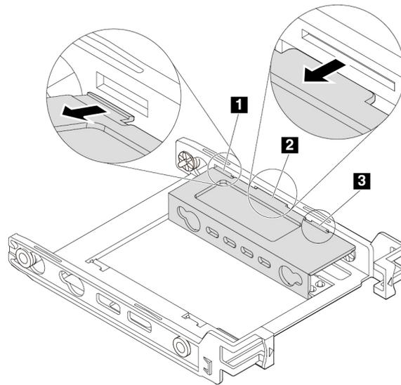
Abbildung 72. Lösen der Laschen aus den entsprechenden Steckplätzen
