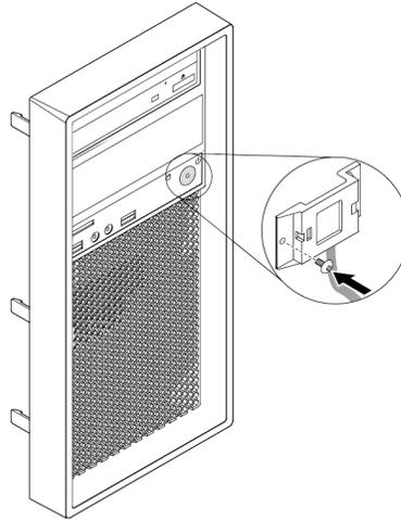
Abbildung 12. Betriebsspannungsschalter installieren
