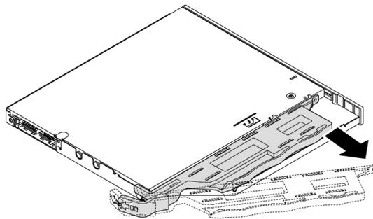
Abbildung 65. Halterung vom flachen optischen Laufwerk entfernen
