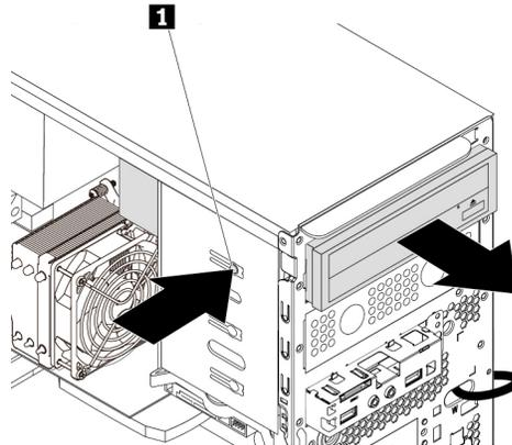
Abbildung 39. Optisches Laufwerk entfernen
