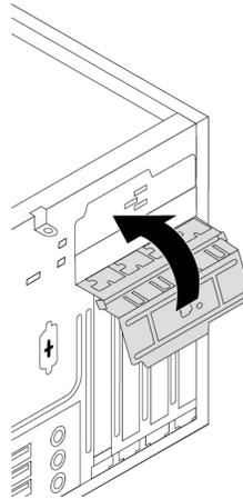
Abbildung 34. PCIe-Kartenverriegelung schließen
