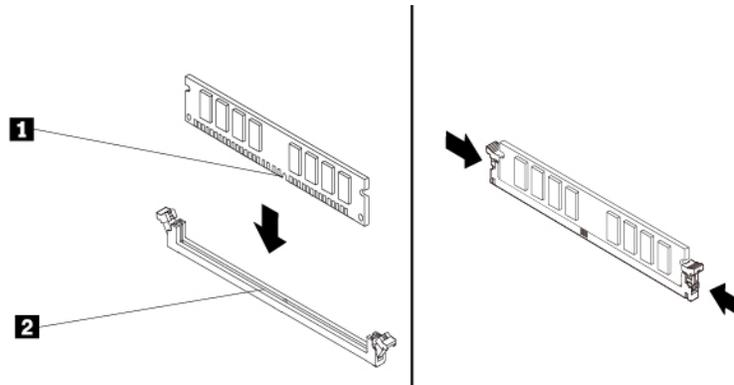
Abbildung 38. Speichermodul installieren
