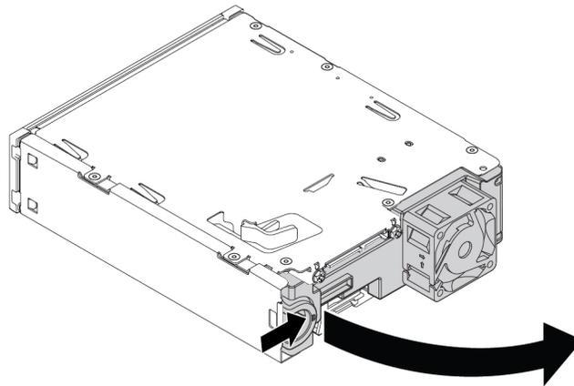
Abbildung 68. Öffnen der hinteren Abdeckung des Kits
