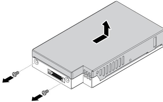
Abbildung 59. Entfernen der Abdeckung vom Träger des M.2-Solid-State-Laufwerks
