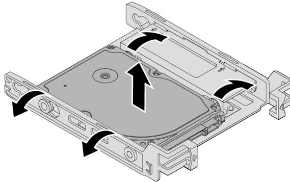
Abbildung 80. Das 2,5-Zoll-Speicherlaufwerk aus der Halterung entfernen
