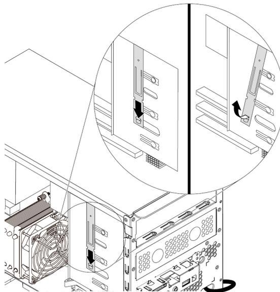
Abbildung 40. Halterung des optischen Laufwerks vom Computer entfernen
