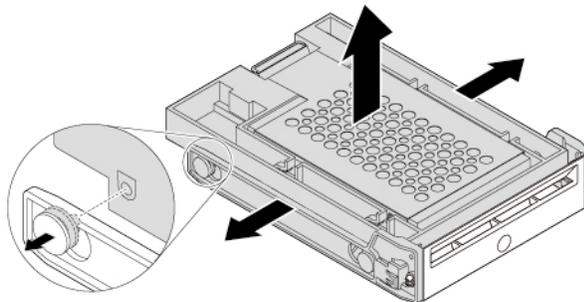
Abbildung 51. Das 2,5-Zoll-Speicherlaufwerk aus der Halterung entfernen
