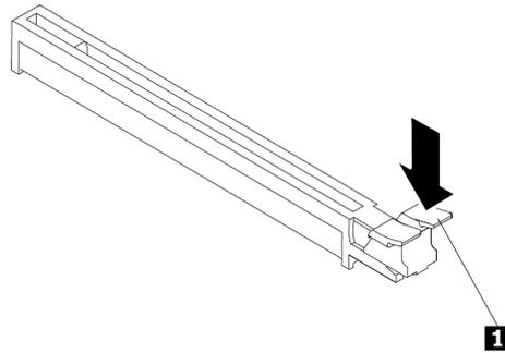
Abbildung 19. Sicherungsriegel lösen
