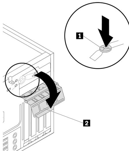
Abbildung 18. PCIe-Kartenverriegelung öffnen
