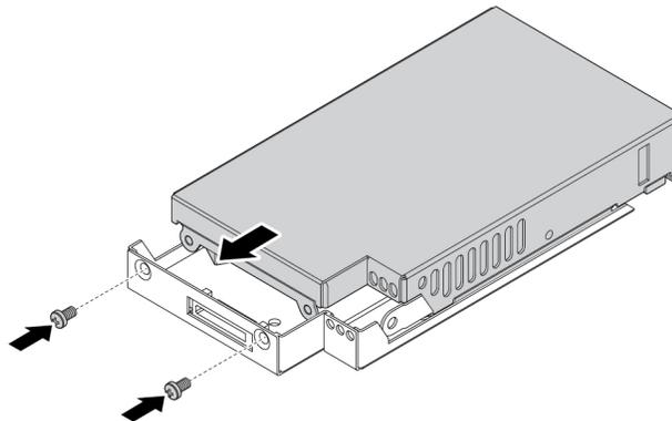
Abbildung 62. Installieren der Abdeckung am Träger des M.2-Solid-State-Laufwerks
