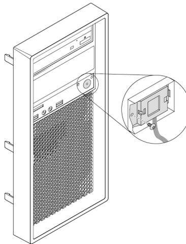
Abbildung 11. Betriebsspannungsschalter entfernen
