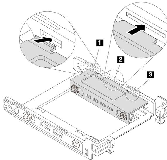
Abbildung 84. Einsetzen der Laschen in die entsprechenden Steckplätze
