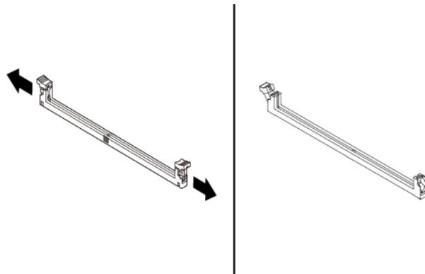
Abbildung 37. Halteklammern öffnen
