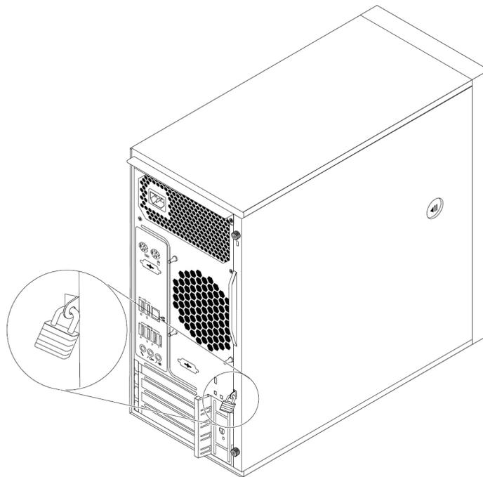
Abbildung 7. Sicherheitsschloss installieren
