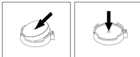
Abbildung 89. Knopfzellenbatterie installieren
