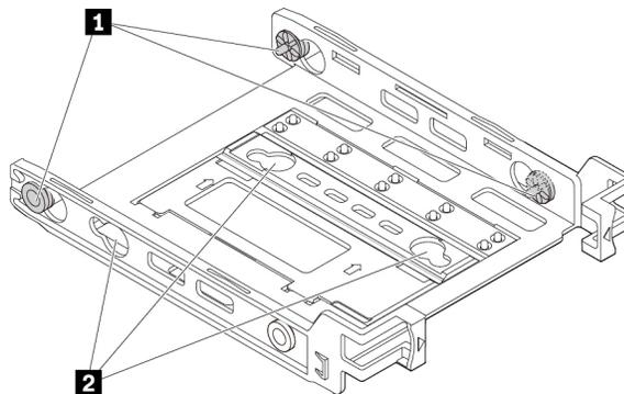
Abbildung 81. Stifte entfernen und in neue Steckplätze einsetzen
