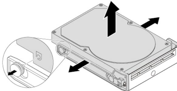
Abbildung 46. Das 3,5-Zoll-Speicherlaufwerk aus der Halterung entfernen
