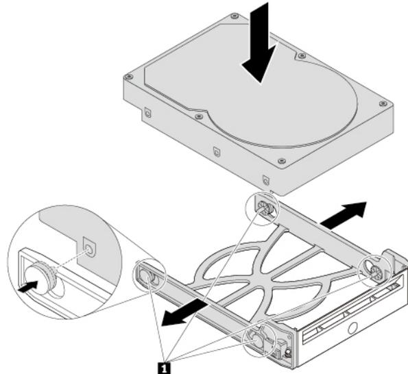
Abbildung 47. 3,5-Zoll-Speicherlaufwerk in die Halterung einbauen
