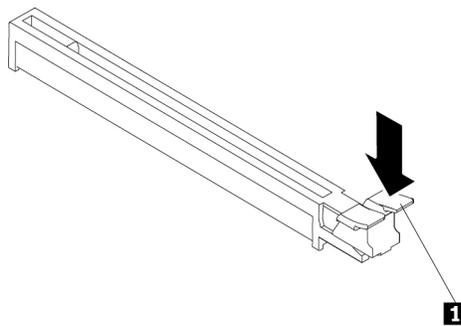
Abbildung 14. Sicherungsriegel lösen
