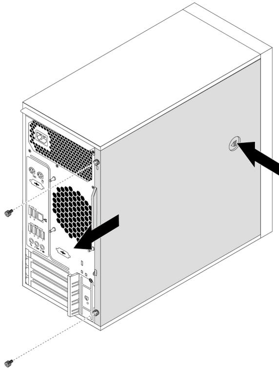
Abbildung 9. Computerabdeckung entfernen
