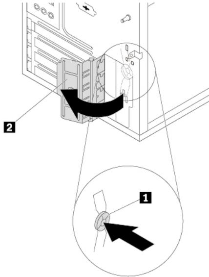
Abbildung 13. PCIe-Kartenverriegelung öffnen
