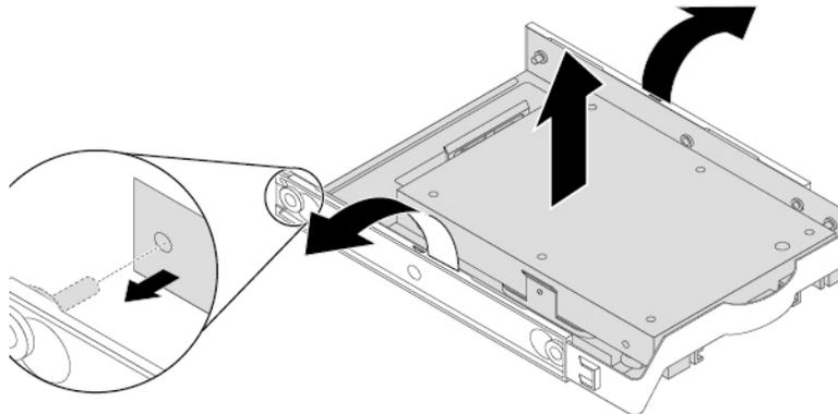
Abbildung 100. 2,5-Zoll auf 3,5-Zoll-Speicherlaufwerkskonverter aus der 3,5 Zoll-Halterung des Speicherlaufwerks entfernen
