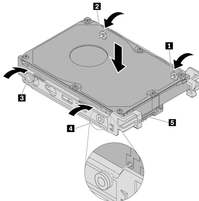
Abbildung 75. Installieren des neuen 3,5-Zoll-Speicherlaufwerks in der Halterung
