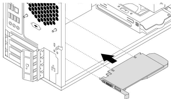
Abbildung 16. PCIe-Karte installieren
