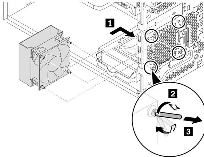
Abbildung 105. Lüftungsbaugruppe an der Vorderseite installieren
