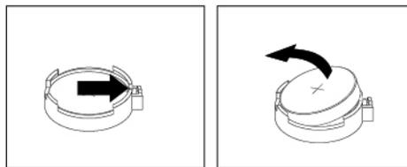
Abbildung 88. Knopfzellenbatterie entfernen
