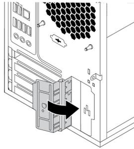
Abbildung 17. PCIe-Kartenverriegelung schließen
