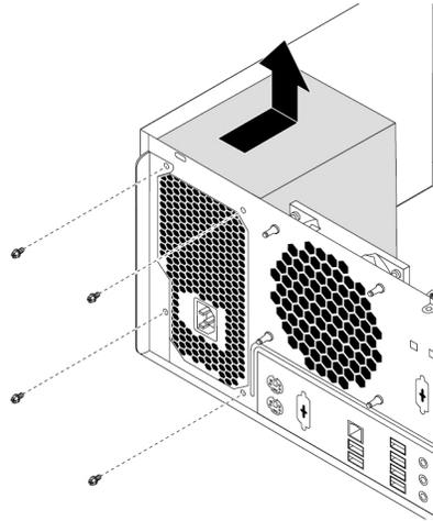
Abbildung 92. Schrauben für Netzteil entfernen
