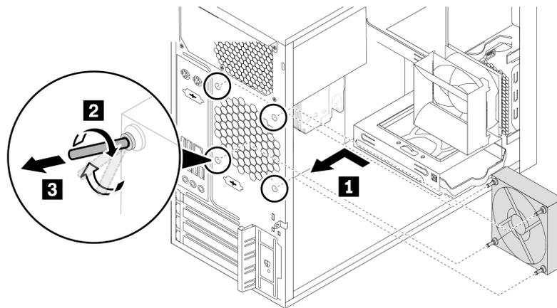
Abbildung 107. Lüftungsbaugruppe an der Rückseite installieren
