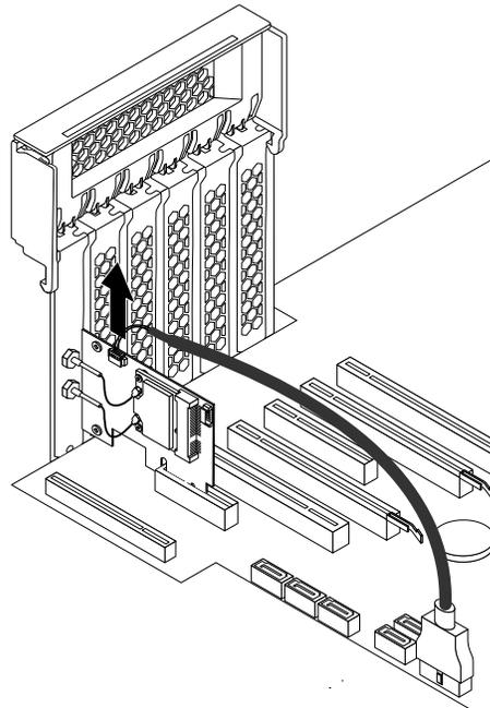
Abbildung 158. Bluetooth-Kabel abziehen
