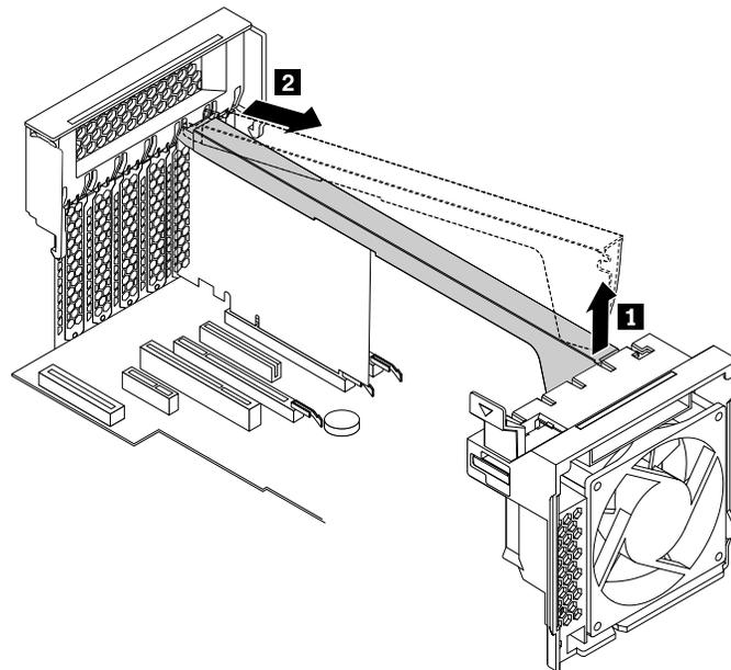
Abbildung 133. PCI-Adapterkartenhalterung entfernen
