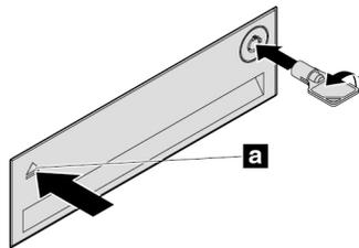
Abbildung 18. Abdeckung des Gehäuses mit Frontzugriff für die Speichereinheit öffnen
