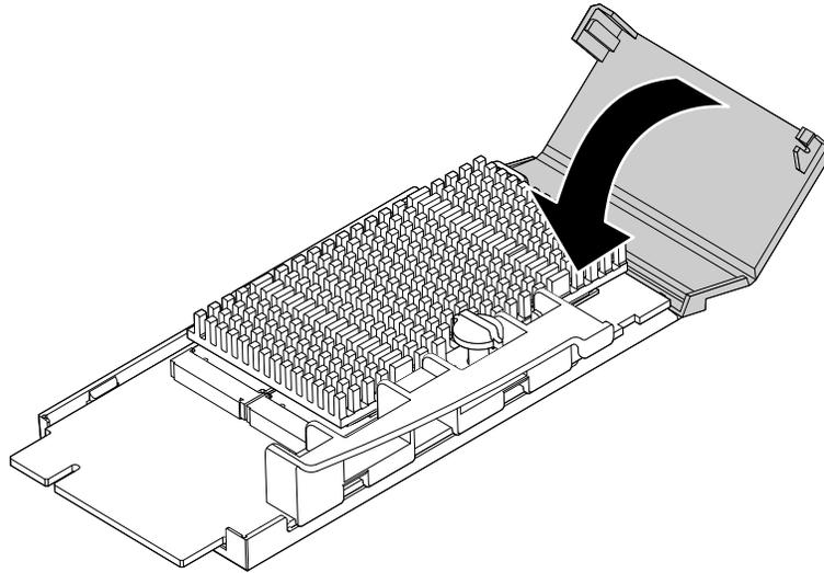
Abbildung 127. Abdeckung des Flex-Adapters umklappen
