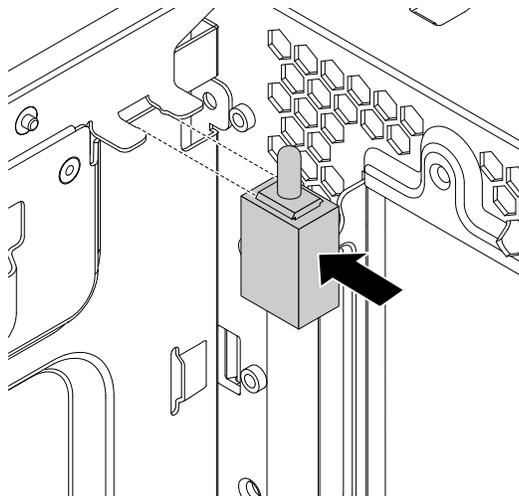
Abbildung 86. Schalter zur Abdeckungserkennung anbringen
