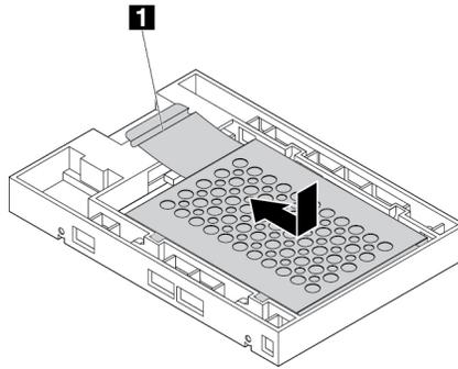
Abbildung 30. Metallhalterung im Kunststoffrahmen des Konverters installieren
