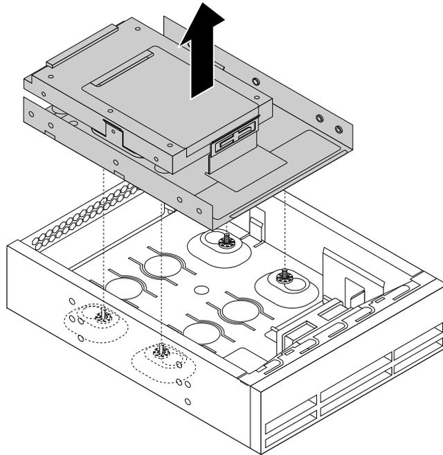
Abbildung 60. 2,5-Zoll-Speicherlaufwerk und Speicherconverter aus dem Gehäuse mit Position für den Flex-Speicher entfernen
