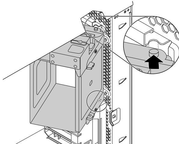
Abbildung 83. Positionieren Sie die Halterung des optischen Laufwerks im Gehäuse
