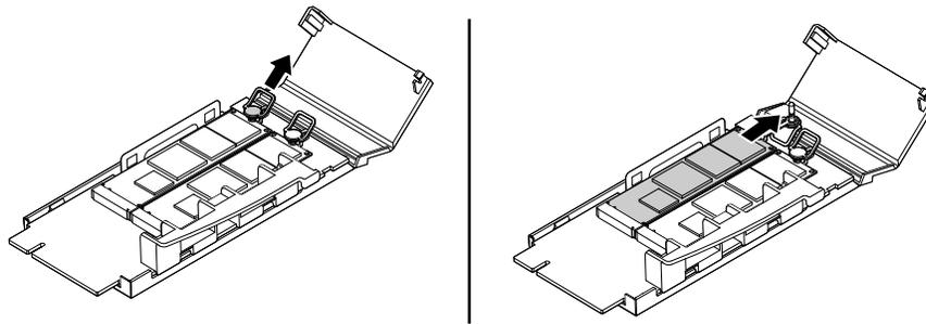
Abbildung 123. M.2-Solid-State-Laufwerk entfernen
