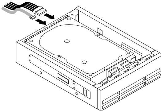
Abbildung 64. Kabel an das Speicherlaufwerk anschließen
