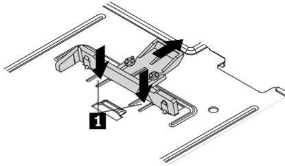
Abbildung 66. Die Plastikklemme mit den beiden Schrauben entfernen
