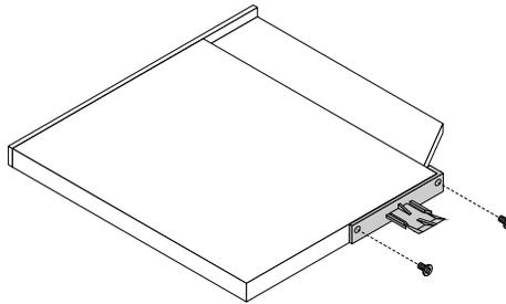
Abbildung 69. Die Plastikklammer am flachen optischen Laufwerk installieren
