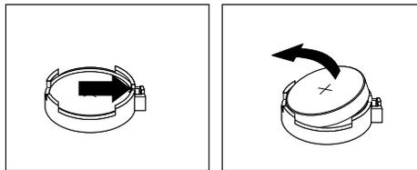
Abbildung 155. Batterie entfernen
