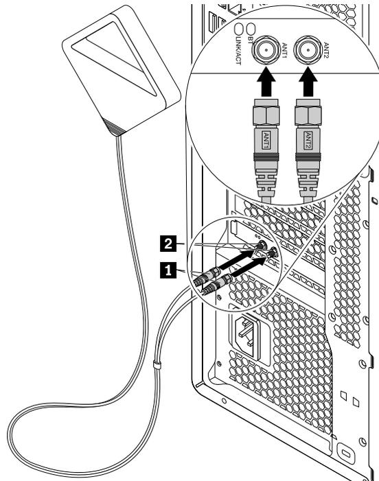
Abbildung 168. Wi-Fi-Antenne anbringen
