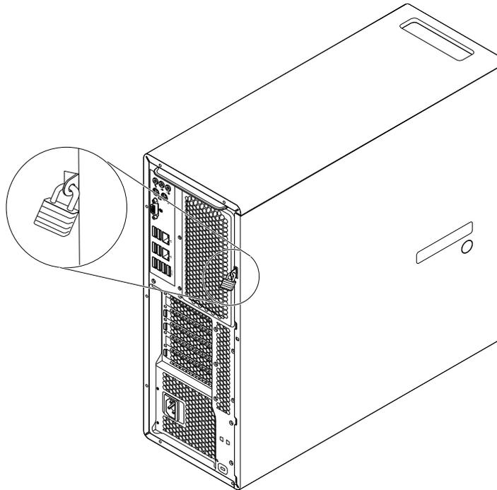
Abbildung 9. Sicherheitsschloss installieren
