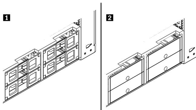
Abbildung 98. Zwei Arten von Halterungen für Speicherlaufwerke
