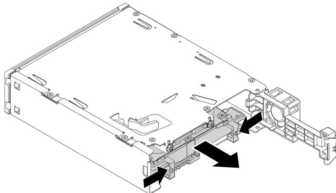
Abbildung 38. Internes 3,5-Zoll-Speicherlaufwerk von der Rückseite entfernen
