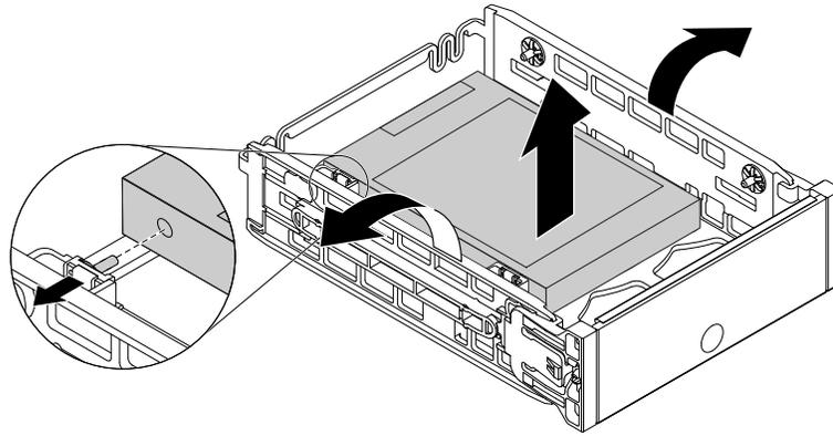
Abbildung 104. Speicherlaufwerk aus der Halterung vom Typ **2** entfernen
