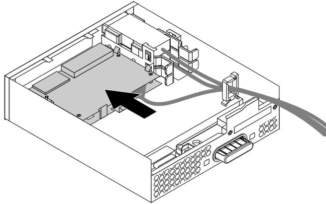
Abbildung 76. Das Lesegerät für Speicherkarten im Flexmodul installieren
