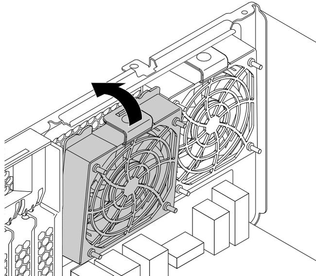
Abbildung 145. Lüftungsbaugruppe an der Rückseite installieren
