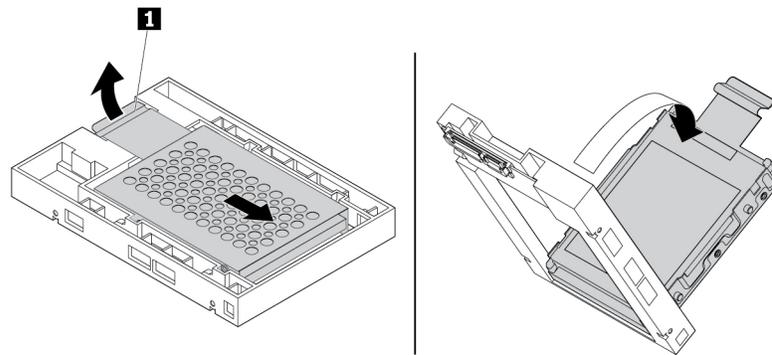
Abbildung 26. Metallhalterung vom Kunststoffrahmen des Konverters entfernen
