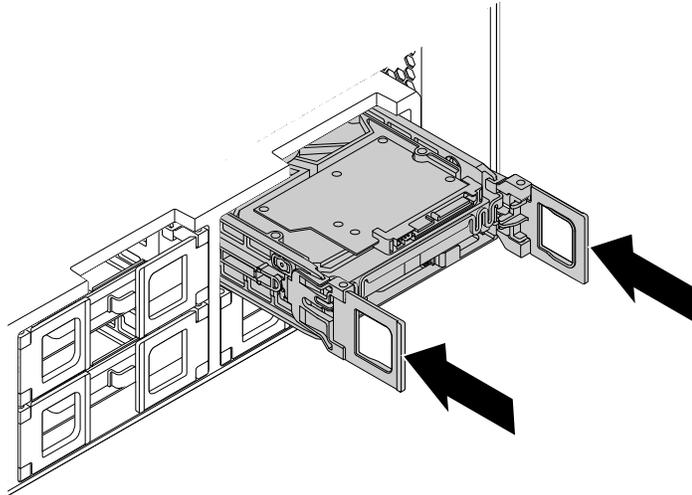
Abbildung 93. Halterung für das Speicherlaufwerk vom Typ **1** installieren
