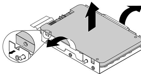
Abbildung 111. Speicherlaufwerk aus der Metallhalterung des Konverters entfernen
