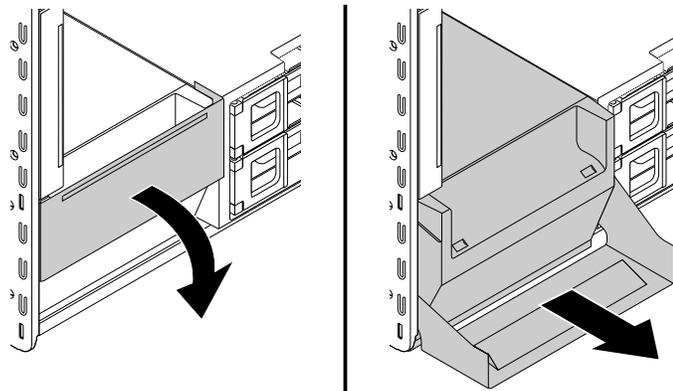
Abbildung 128. Netzteil entfernen
