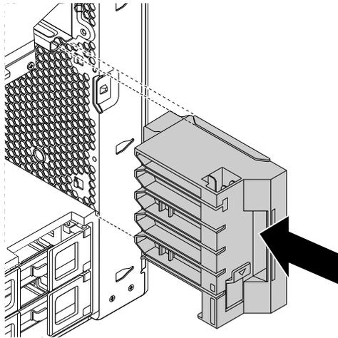
Abbildung 88. Lüftungsbaugruppe an der Vorderseite installieren
