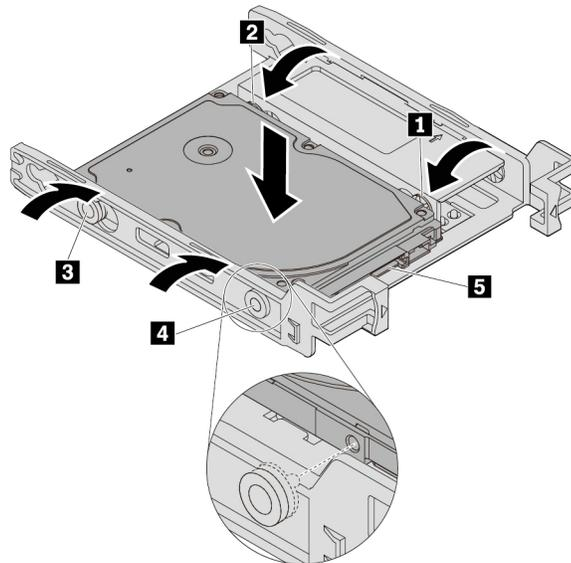
Abbildung 46. Neues internes 2,5-Zoll-Speicherlaufwerk in die Halterung einsetzen
