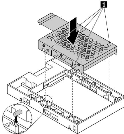
Abbildung 113. Metallhalterung in den Kunststoffrahmen des Konverters einsetzen
