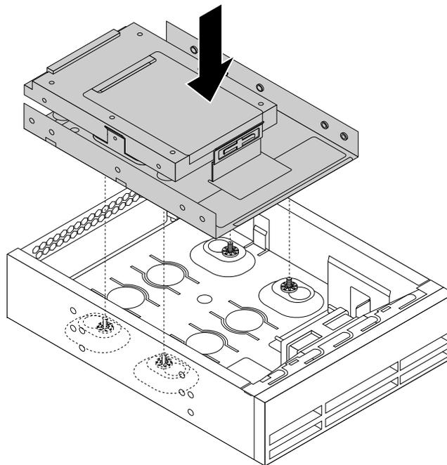
Abbildung 63. 2,5-Zoll-Speicherlaufwerk und Speicherkonverter im Gehäuse mit Position für den Flex-Speicher installieren
