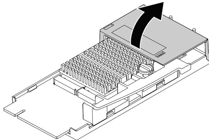
Abbildung 121. Abdeckung des Flex-Adapters öffnen
