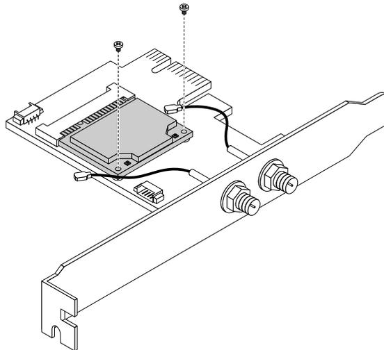
Abbildung 165. Die Schrauben zur Befestigung des Wi-Fi-Kartenmoduls anbringen
