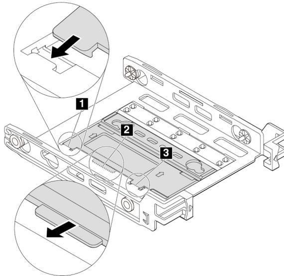
Abbildung 56. Laschen **1** und **3** in die entsprechenden Steckplätze einsetzen
