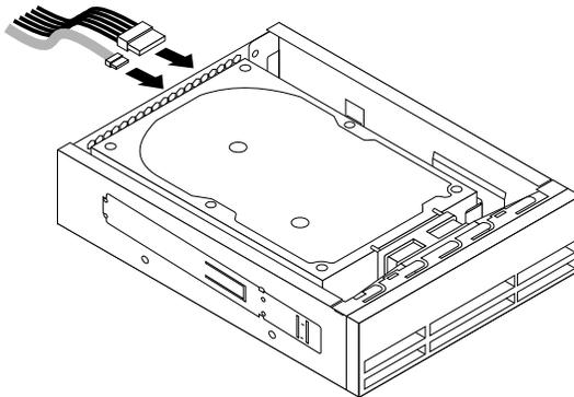
Abbildung 59. Kabel an das Speicherlaufwerk anschließen
