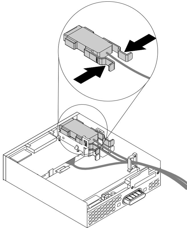
Abbildung 79. Den eSATA- oder IEEE 1394-Anschluss aus dem Flexmodul entfernen
