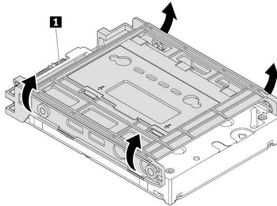
Abbildung 39. Beide Seiten der Halterung biegen, um das interne 3,5-Zoll-Speicherlaufwerk zu entfernen
