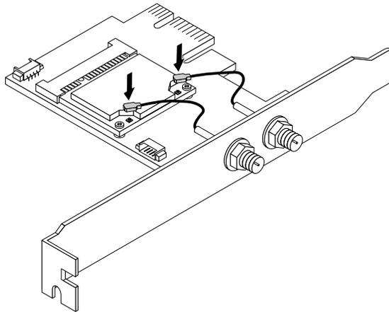
Abbildung 166. Wi-Fi-Antennenkabel anschließen
