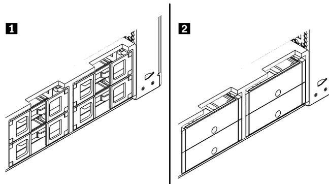
Abbildung 107. Zwei Arten von Halterungen für Speicherlaufwerke
