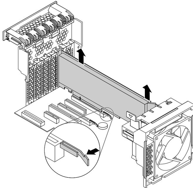
Abbildung 139. Eine lange PCI-Karte entfernen
