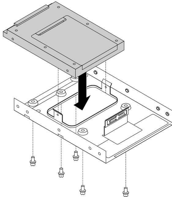
Abbildung 62. 2,5-Zoll-Speicherlaufwerk in den Speicherkonverter einbauen
