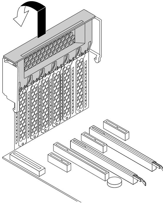
Abbildung 137. PCI-Kartenverriegelung öffnen
