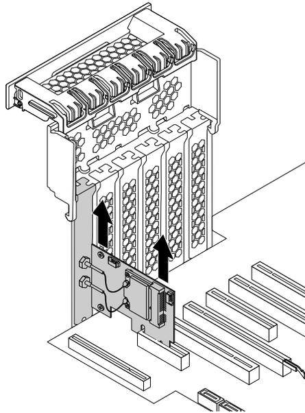
Abbildung 160. Wi-Fi-Adapterkarte entfernen
