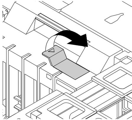
Abbildung 132. Öffnen der Verriegelung in der Lüftungsbaugruppe an der Vorderseite
