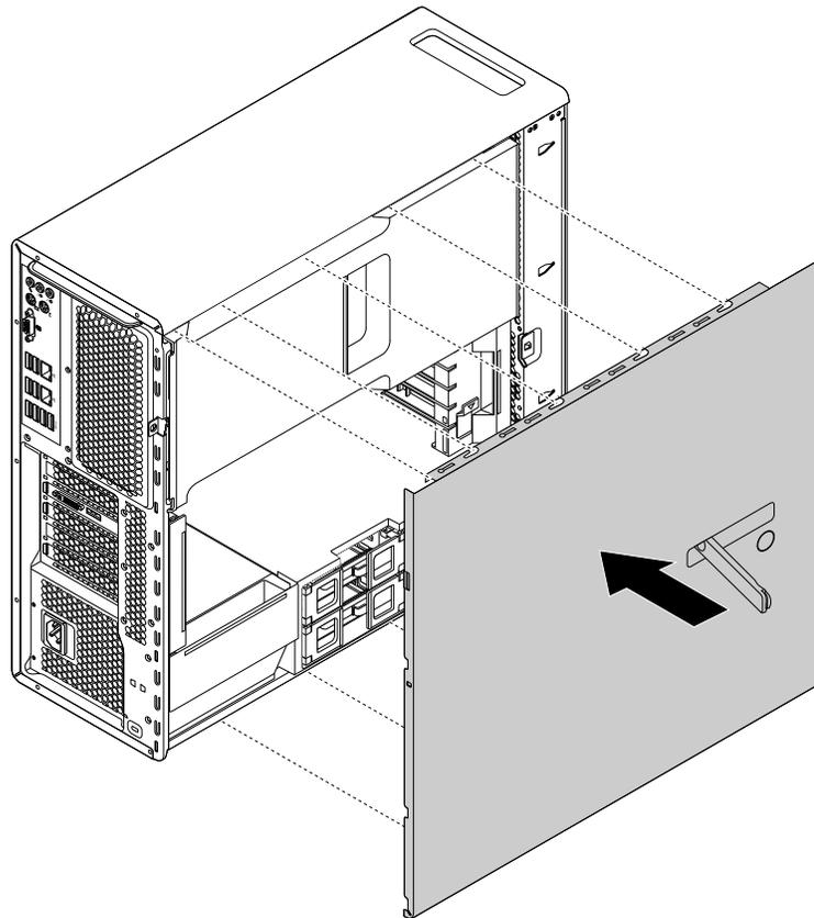
Abbildung 169. Computerabdeckung positionieren
