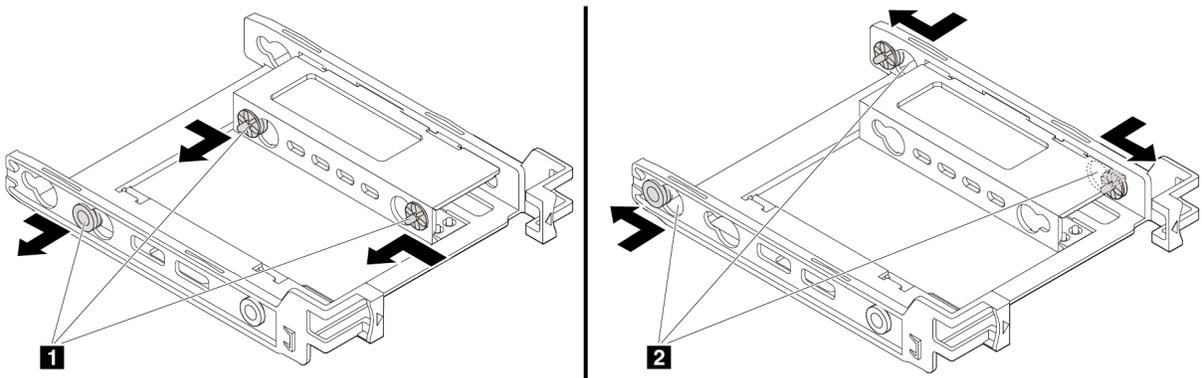
Abbildung 53. Drei Stifte **1** entfernen und in die Steckplätze **2** einsetzen
