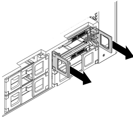
Abbildung 99. Halterung für das Speicherlaufwerk vom Typ **1** entfernen
