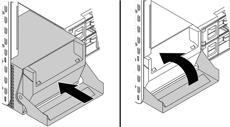
Abbildung 129. Netzteil installieren
