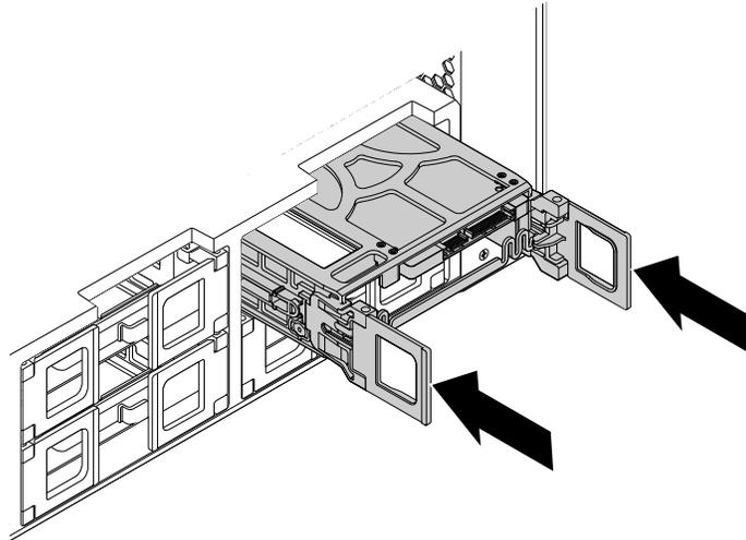
Abbildung 102. Halterung für das Speicherlaufwerk vom Typ **1** installieren
