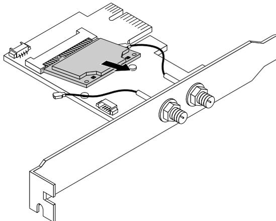
Abbildung 163. Wi-Fi-Kartenmodul entfernen
