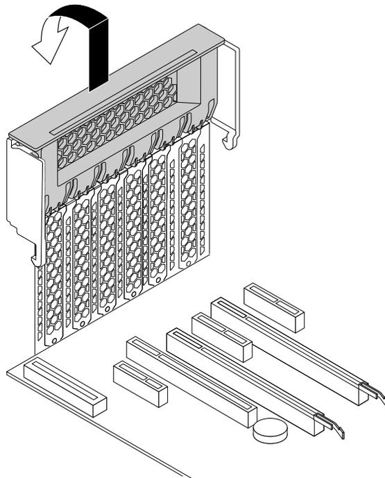
Abbildung 159. PCI-Kartenverriegelung öffnen
