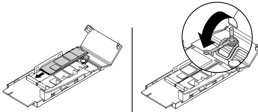
Abbildung 124. M.2-Solid-State-Laufwerk installieren
