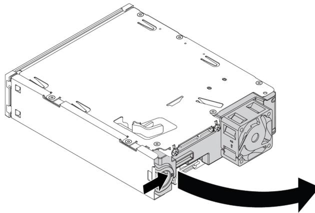
Abbildung 37. Kit von der Rückseite öffnen
