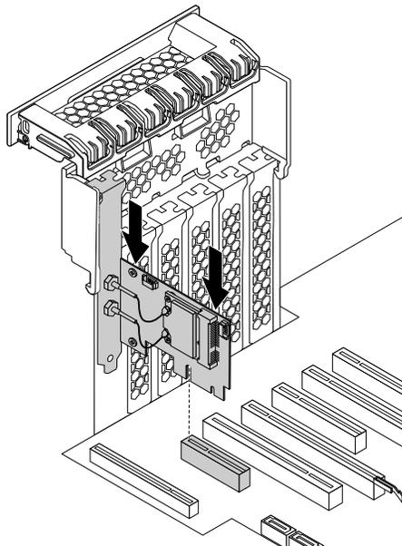
Abbildung 167. Wi-Fi-Adapterkarte installieren
