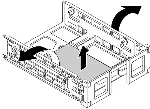
Abbildung 100. Speicherlaufwerk aus der Halterung vom Typ **1** entfernen
