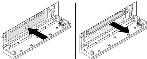
Abbildung 19. Entfernen der Halterung vom Gehäuse mit Frontzugriff für die Speichereinheit
