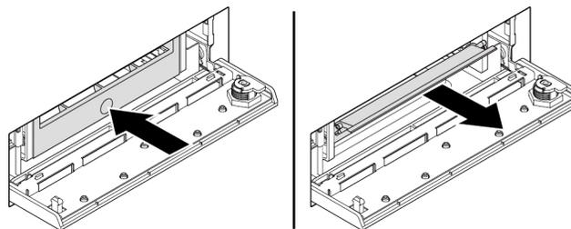
Abbildung 24. Entfernen der Halterung vom Gehäuse mit Frontzugriff für die Speichereinheit
