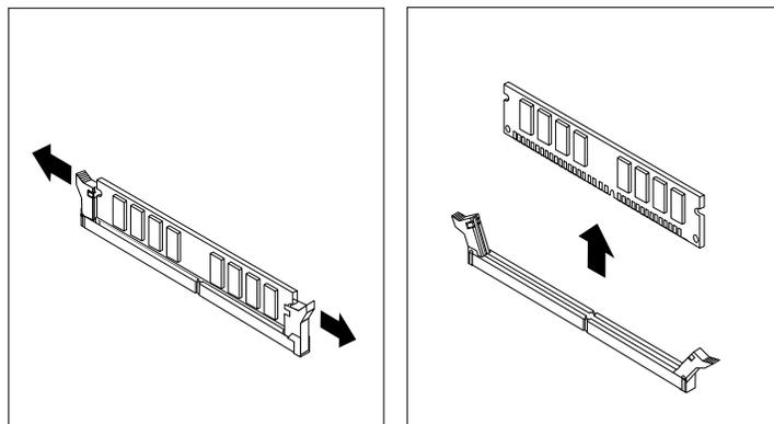
Abbildung 149. Speichermodul entfernen
