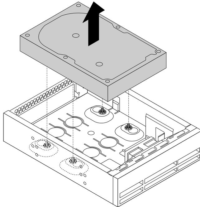
Abbildung 57. 3,5-Zoll-Speicherlaufwerk aus dem Gehäuse mit Position für den Flex-Speicher entfernen
