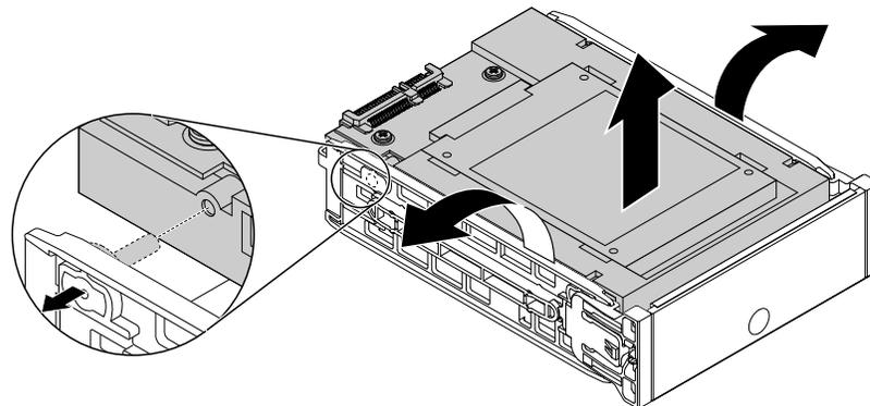
Abbildung 118. Konverter aus der Halterung vom Typ 2 entfernen
