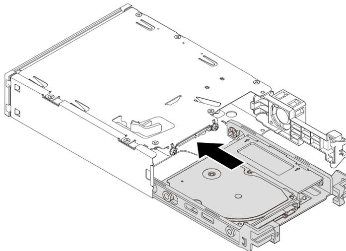
Abbildung 47. Neues internes 2,5-Zoll-Speicherlaufwerk in das Kit schieben
