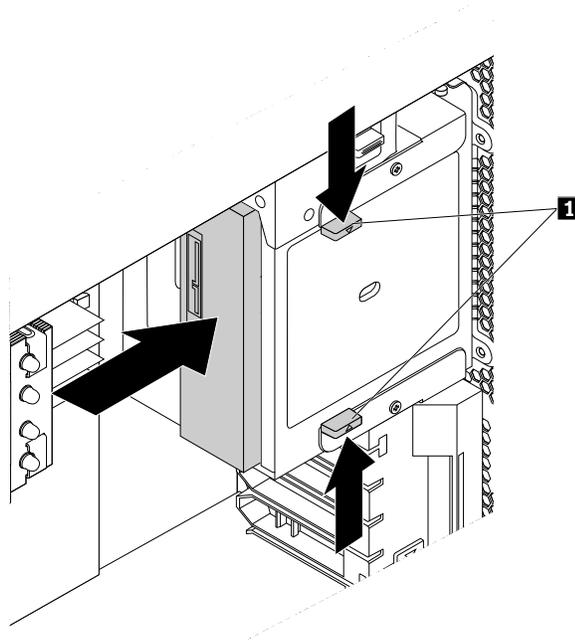
Abbildung 15. Optisches Laufwerk entfernen
