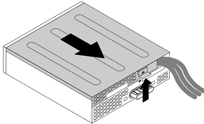
*Abbildung 78. Abdeckung des Flexmoduls entfernen*
