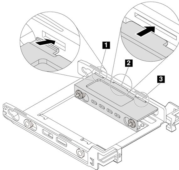
Abbildung 52. Einsetzen der Laschen in die entsprechenden Steckplätze
