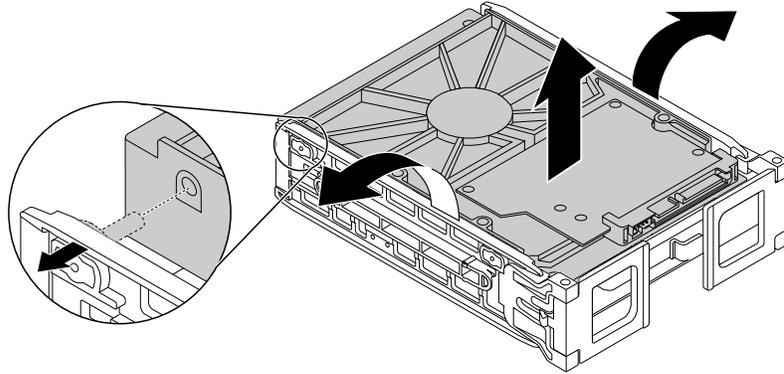
Abbildung 91. Speicherlaufwerk aus der Halterung vom Typ **1** entfernen
