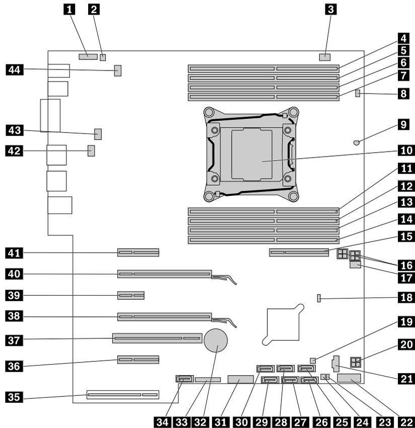
Abbildung 5. Positionen der Komponenten auf der Systemplatine
