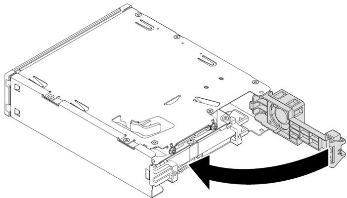
Abbildung 42. Rückwand nach innen klappen
