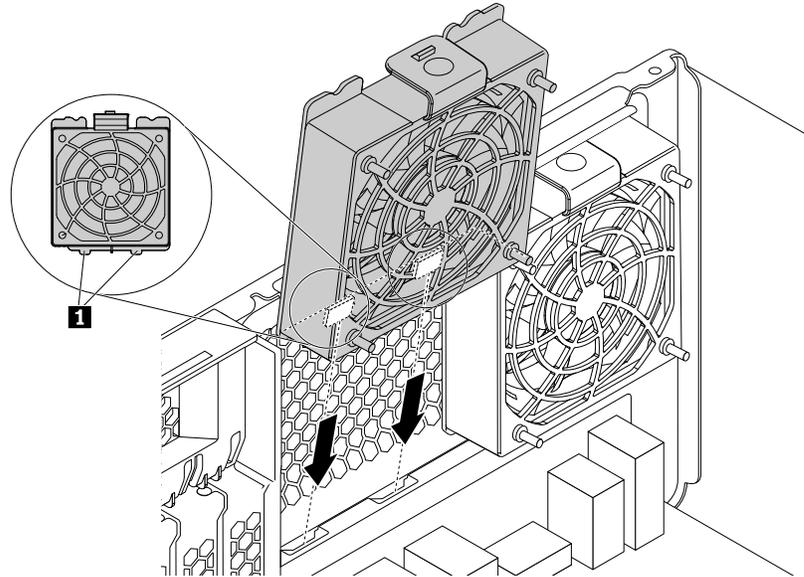
Abbildung 144. Lüftungsbaugruppe an der Rückseite positionieren
