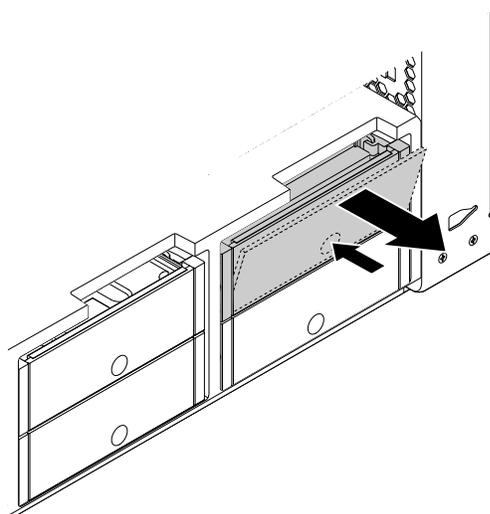
Abbildung 94. Halterung für das Speicherlaufwerk vom Typ **2** entfernen
