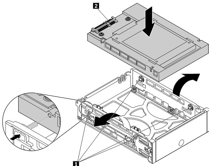
Abbildung 119. Konverter in der Halterung vom Typ **2** installieren
