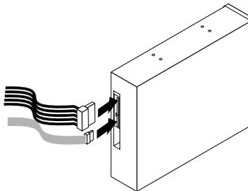
Abbildung 17. Kabel an das optische Laufwerk anschließen
