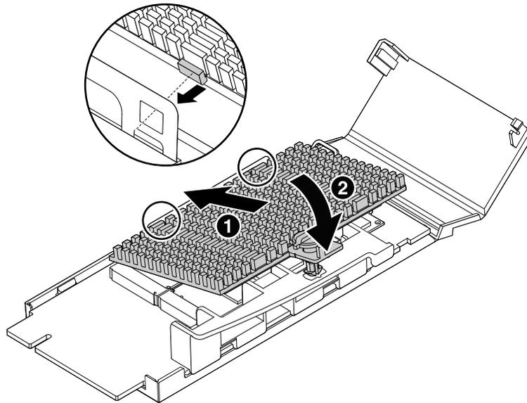
Abbildung 125. Kühlkörper am Flex-Adapter installieren
