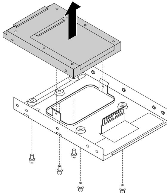
Abbildung 61. Das 2,5-Zoll-Speicherlaufwerk aus dem Speicherconverter entfernen
