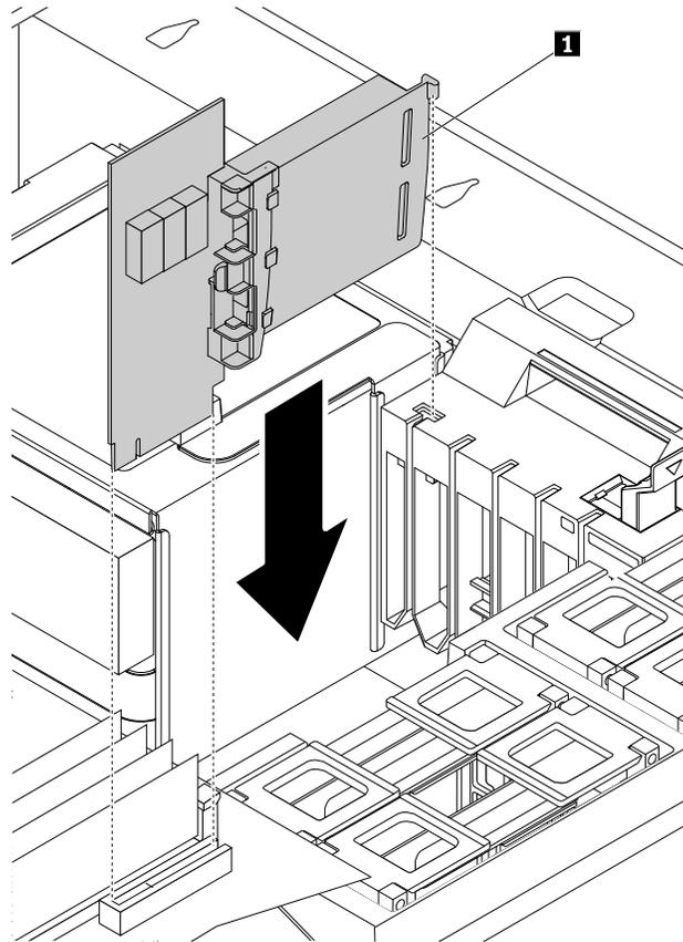
Abbildung 154. Flex-Adapter installieren
