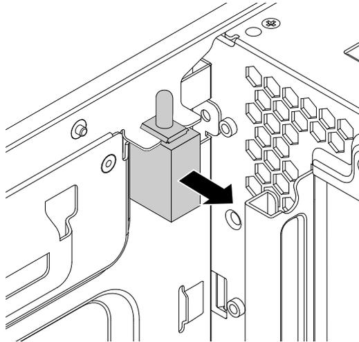
Abbildung 85. Schalter zur Abdeckungserkennung entfernen
