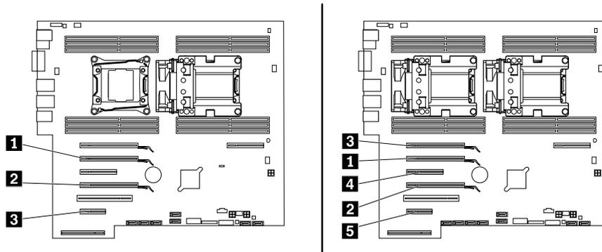
Abbildung 131. Installationsreihenfolge für PCI-Express-Karten für ThinkStation P710
