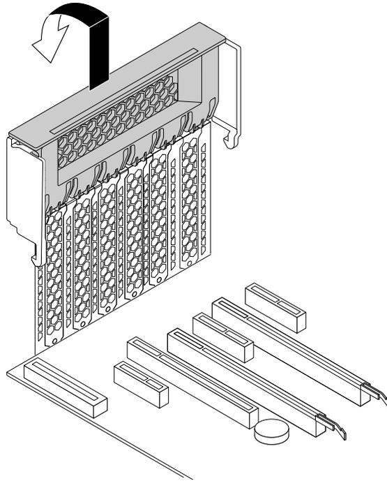
Abbildung 134. PCI-Kartenverriegelung öffnen
