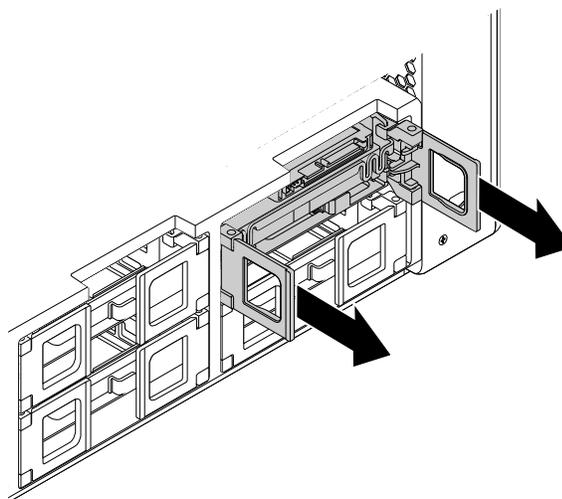
Abbildung 90. Halterung für das Speicherlaufwerk vom Typ **1** entfernen
