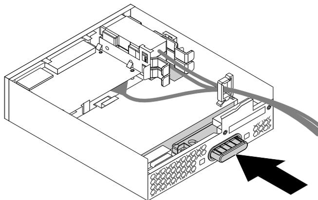
Abbildung 67. Das flache optische Laufwerk aus dem Flexmodul entfernen
