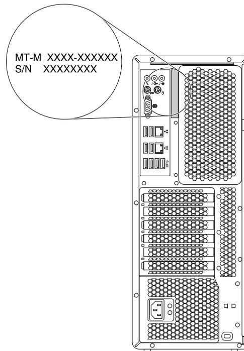
Abbildung 8. Etikett für Maschinentyp und -modell
