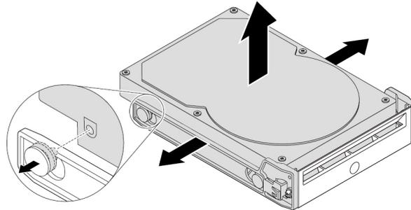
Abbildung 20. Das 3,5-Zoll-Speicherlaufwerk aus der Halterung entfernen
