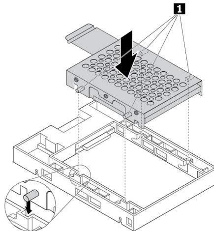
Abbildung 29. Metallhalterung in den Kunststoffrahmen des Konverters einsetzen
