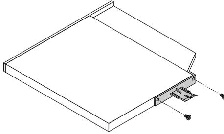
Abbildung 68. Die Plastikklammer vom flachen optischen Laufwerk entfernen
