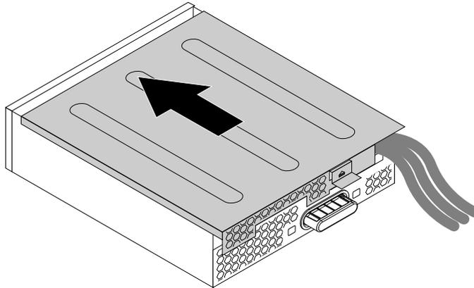
Abbildung 77. Abdeckung des Flexmoduls wieder anbringen
