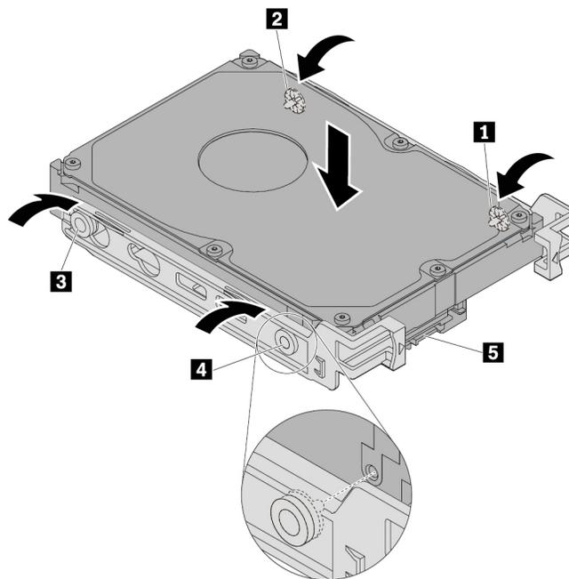
Abbildung 40. Neues internes 3,5-Zoll-Speicherlaufwerk in die Halterung einsetzen
