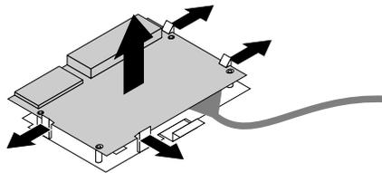
Abbildung 74. Das Lesegerät für Speicherkarten aus der Halteklammer entfernen
