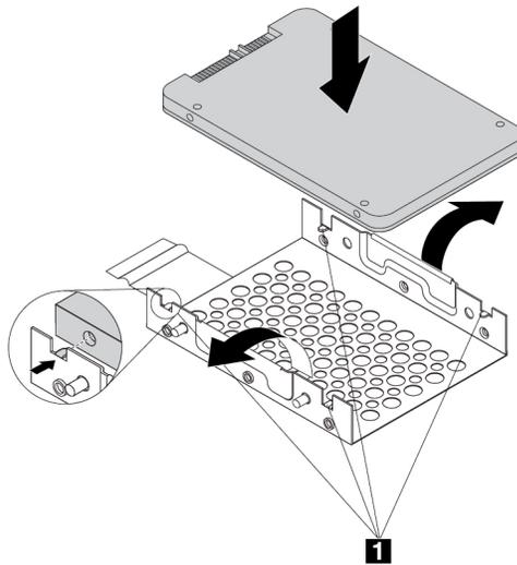
Abbildung 28. Installieren des 2,5-Zoll-Speicherlaufwerks in der Metallhalterung
