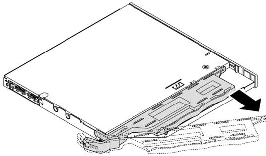
Abbildung 34. Halterung vom flachen optischen Laufwerk entfernen
