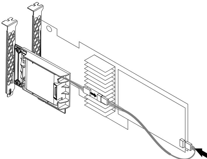
Abbildung 142. Superkondensatormodulkabel an die RAID-Karte anschließen
