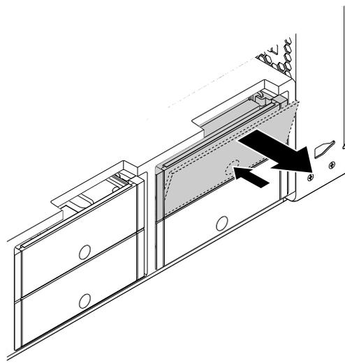
Abbildung 117. Halterung für das Speicherlaufwerk vom Typ 2 entfernen
