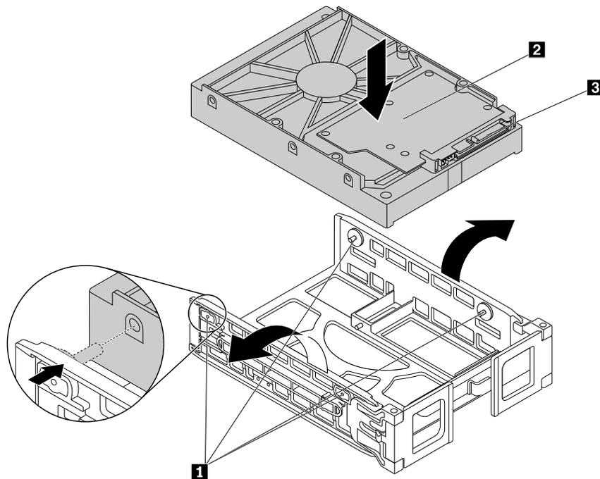
Abbildung 92. Speicherlaufwerk in der Halterung vom Typ **1** einbauen
