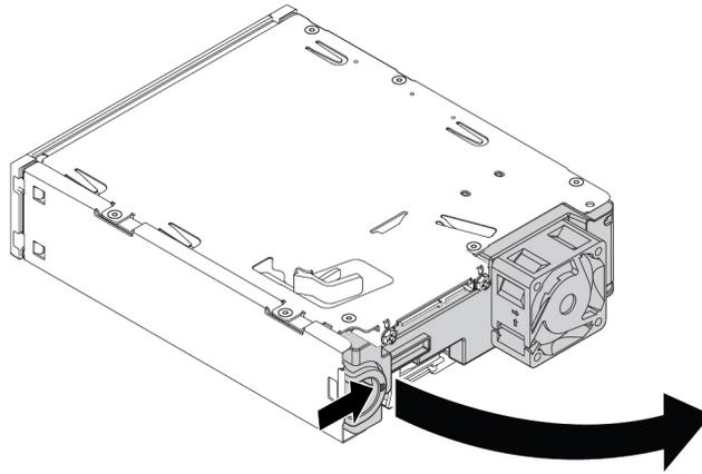
Abbildung 43. Kit von der Rückseite öffnen
