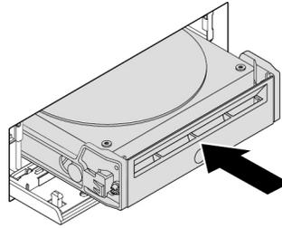
Abbildung 22. Installieren des 3,5-Zoll-Speicherlaufwerks im Gehäuse mit Frontzugriff für die Speichereinheit
