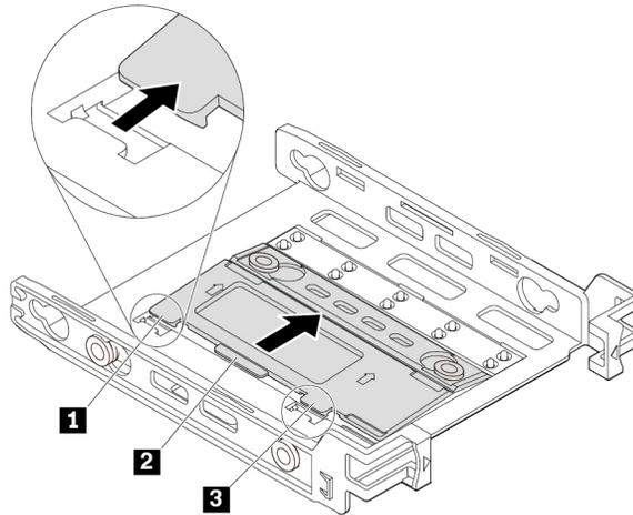
Abbildung 50. Halterung drehen
