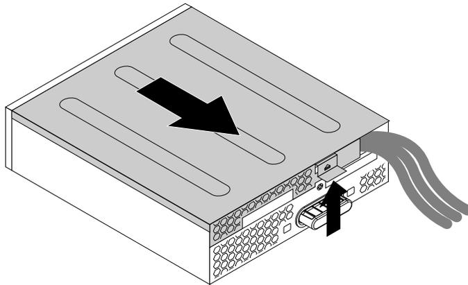
Abbildung 65. Abdeckung des Flexmoduls entfernen
