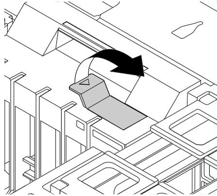
Abbildung 152. Öffnen der Verriegelung in der Lüftungsbaugruppe an der Vorderseite
