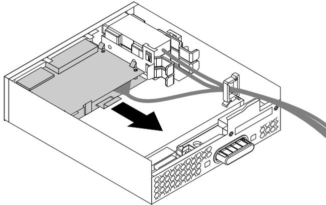
Abbildung 73. Das Lesegerät für Speicherkarten aus dem Flexmodul entfernen
