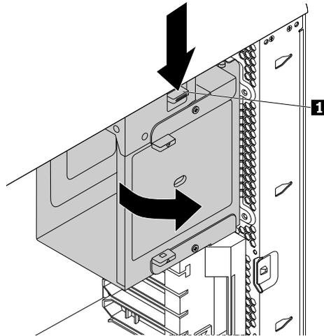
Abbildung 82. Halterung für optisches Laufwerk entfernen
