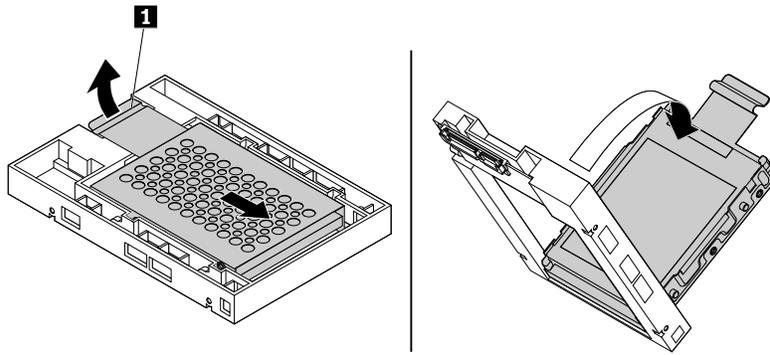
Abbildung 110. Metallhalterung vom Kunststoffrahmen des Konverters entfernen
