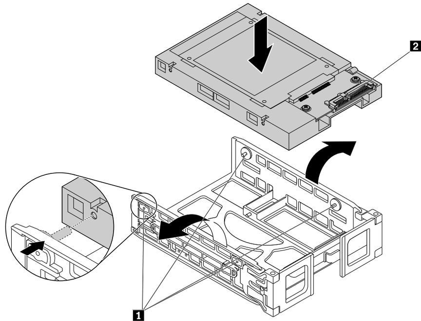
Abbildung 115. Konverter in der Halterung vom Typ **1** installieren
