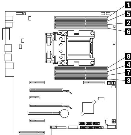
Abbildung 147. Installationsreihenfolge für Speichermodule für ThinkStation P510
