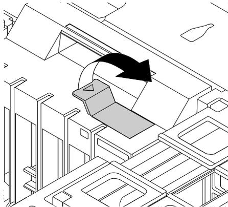
Abbildung 138. Öffnen der Verriegelung in der Lüftungsbaugruppe an der Vorderseite
