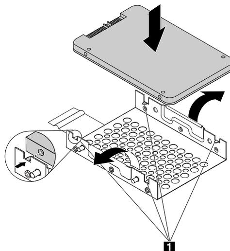
Abbildung 112. Speicherlaufwerk in der Metallhalterung des Konverters installieren
