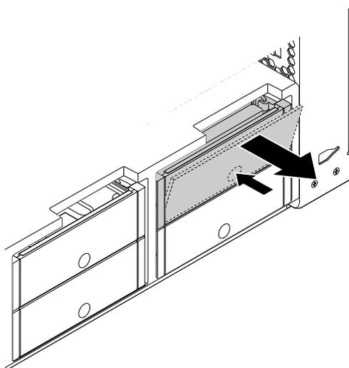
Abbildung 103. Halterung für das Speicherlaufwerk vom Typ **2** entfernen
