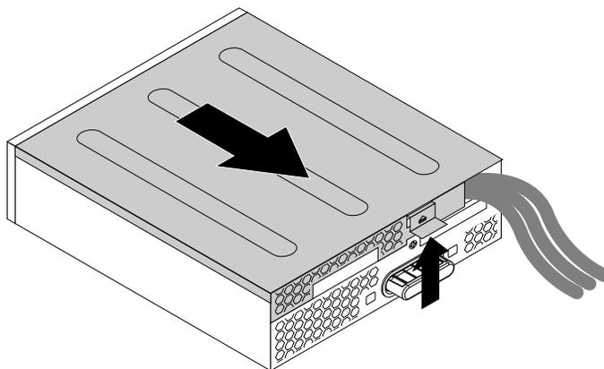
Abbildung 72. Abdeckung des Flexmoduls entfernen
