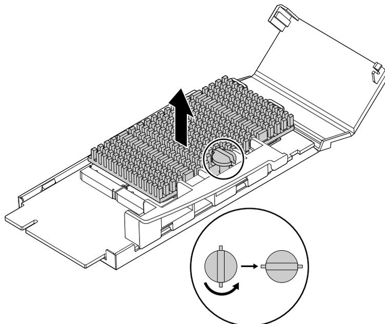
Abbildung 122. Kühlkörper vom Flex-Adapter abnehmen
