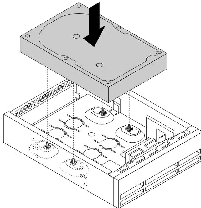
Abbildung 58. 3,5-Zoll-Speicherlaufwerk im Gehäuse mit Position für den Flex-Speicher installieren
