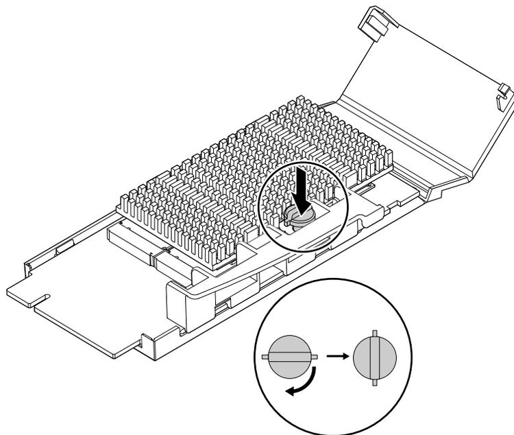
Abbildung 126. Kühlkörper am Flex-Adapter befestigen
