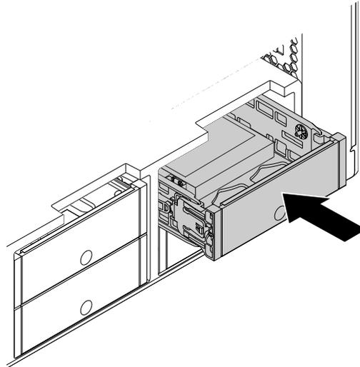
Abbildung 106. Halterung für das Speicherlaufwerk vom Typ **2** installieren
