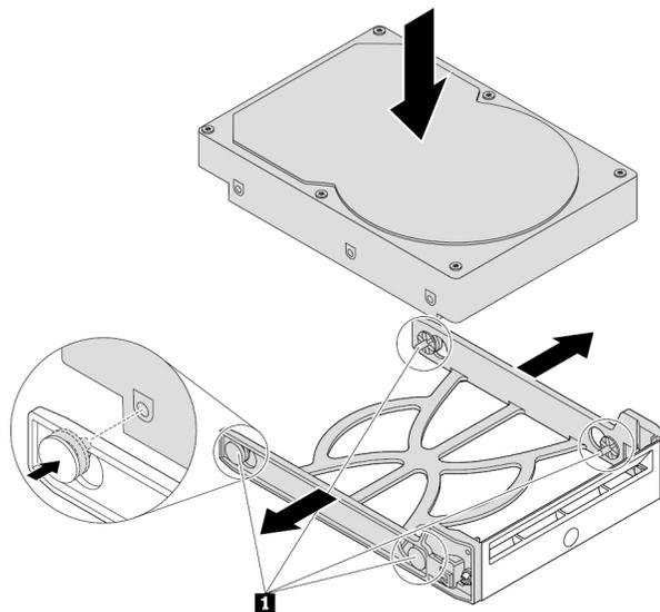
Abbildung 21. 3,5-Zoll-Speicherlaufwerk in die Halterung einbauen
