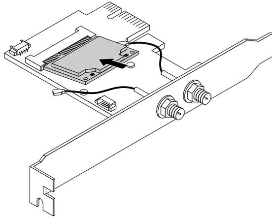
Abbildung 164. Wi-Fi-Kartenmodul installieren
