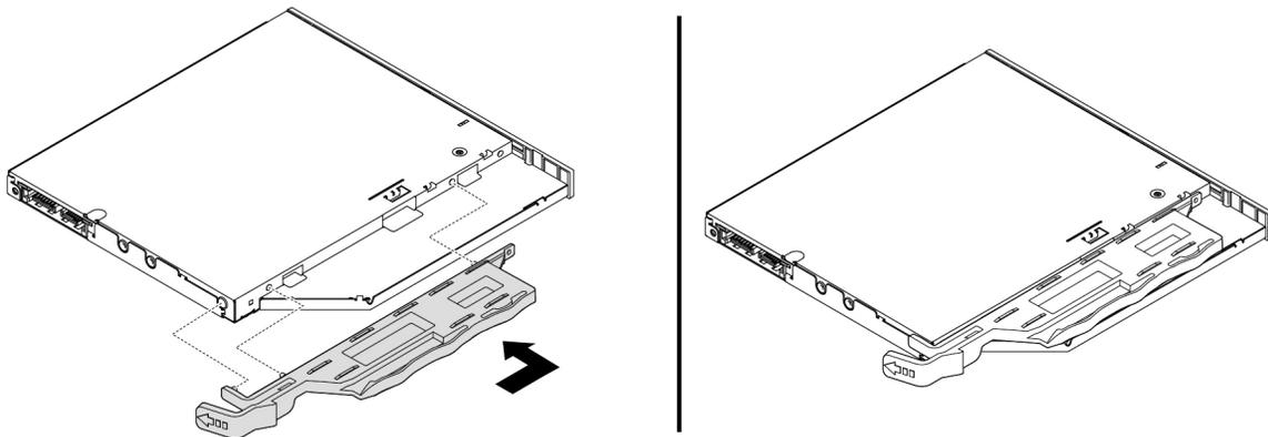
Abbildung 35. Halterung am neuen flachen optischen Laufwerk anbringen
