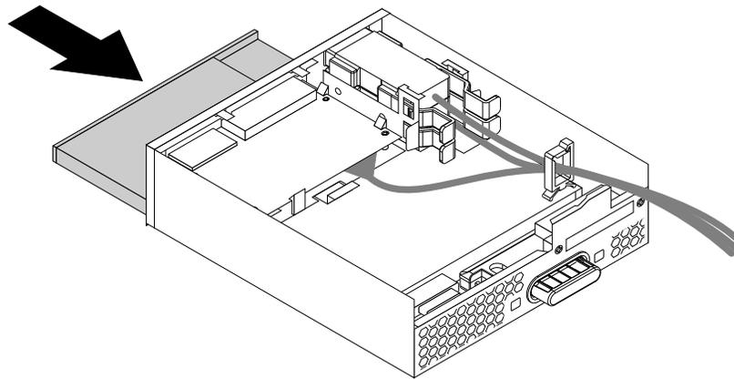
Abbildung 70. Das flache optische Laufwerk im Flexmodul installieren
