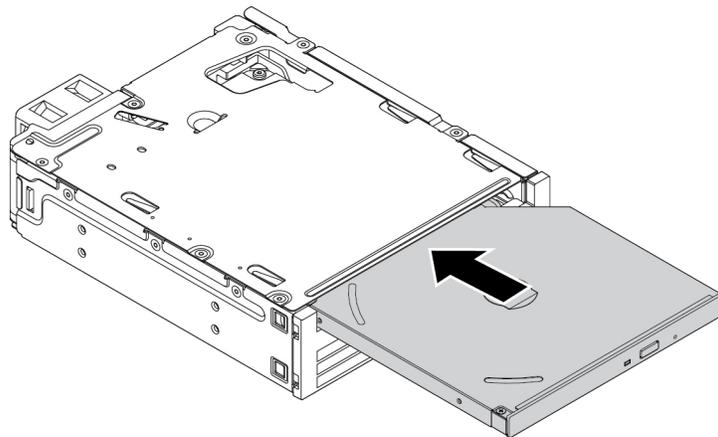
Abbildung 36. Flaches optisches Laufwerk in das Kit einsetzen
