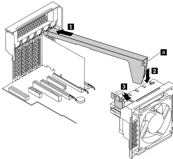
Abbildung 136. PCI-Adapterkartenhalterung installieren
