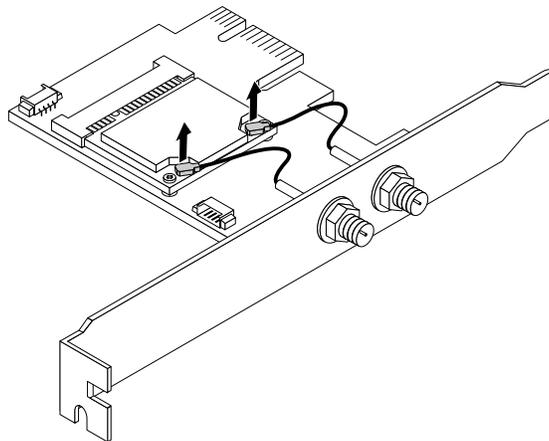
Abbildung 161. Wi-Fi-Antennenkabel entfernen
