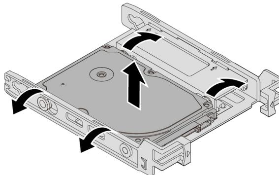
Abbildung 45. Beide Seiten der Halterung biegen, um das interne 2,5-Zoll-Speicherlaufwerk zu entfernen
