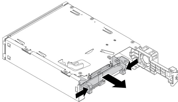
Abbildung 44. Internes 2,5-Zoll-Speicherlaufwerk von der Rückseite entfernen
