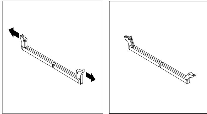
Abbildung 150. Halteklammern öffnen
