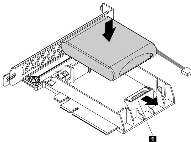
Abbildung 141. Superkondensatormodul in der Halterung installieren
