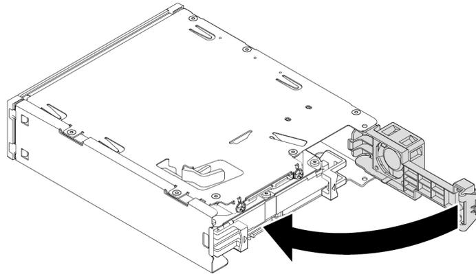
Abbildung 48. Rückwand nach innen klappen
