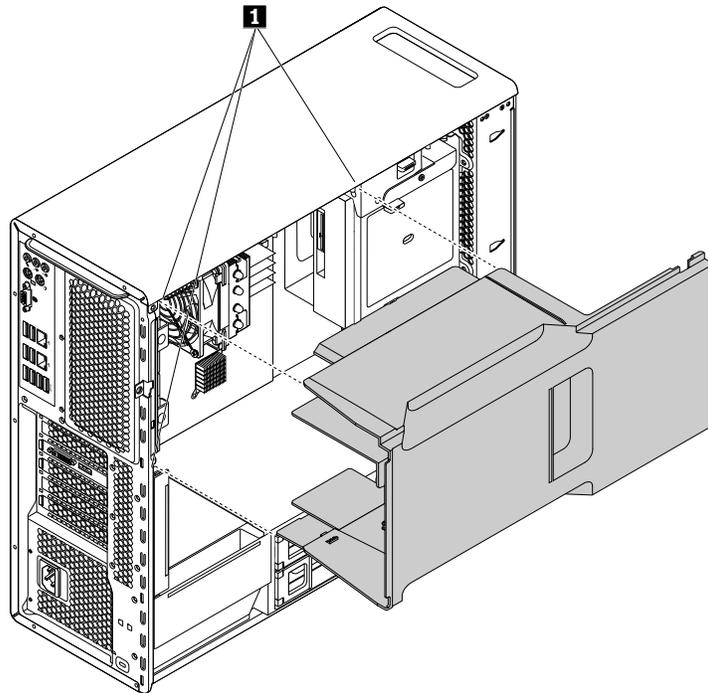
Abbildung 14. Direkte Kühlluftführung installieren
