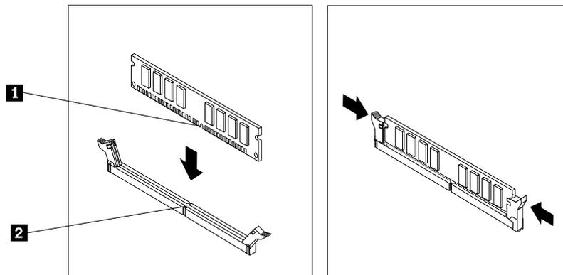
Abbildung 151. Speichermodul installieren
