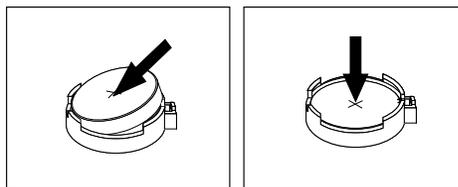
Abbildung 156. Batterie installieren
