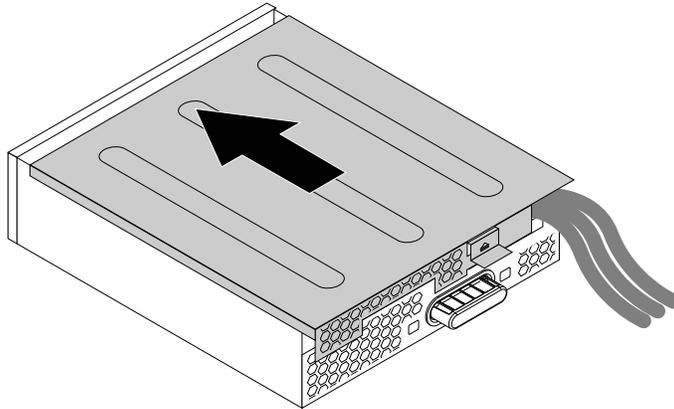
Abbildung 71. Abdeckung des Flexmoduls wieder anbringen
