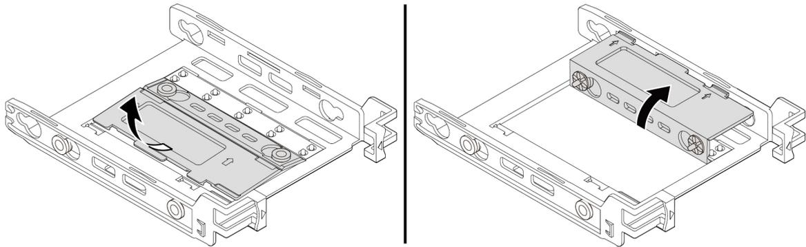
Abbildung 51. Halterung nach oben klappen
