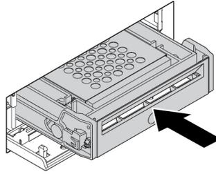
Abbildung 32. Installieren der Halterung mit dem 2,5-Zoll-Speicherlaufwerk im Gehäuse mit Frontzugriff für die Speichereinheit
