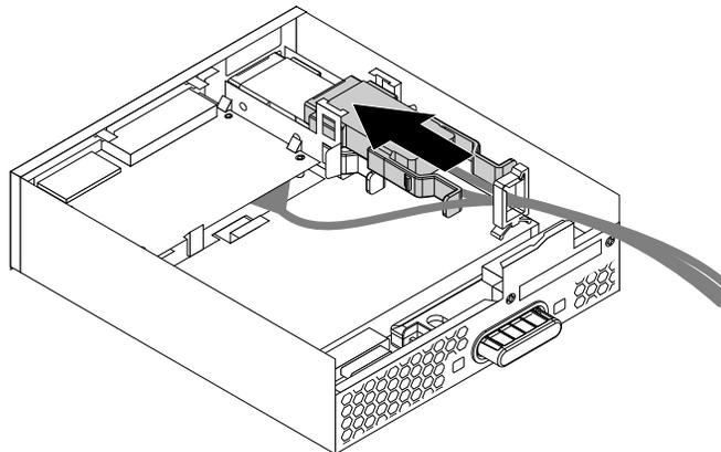
Abbildung 80. Den eSATA- oder IEEE 1394-Anschluss im Flexmodul installieren
