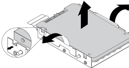
Abbildung 27. Entfernen des Speicherlaufwerks aus der Metallhalterung
