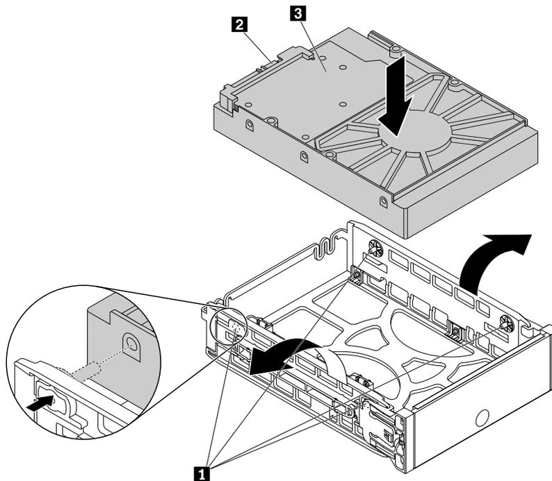
Abbildung 96. Speicherlaufwerk in der Halterung vom Typ **2** einbauen
