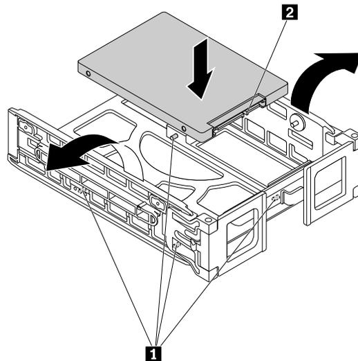
Abbildung 101. Speicherlaufwerk in der Halterung vom Typ **1** einbauen
