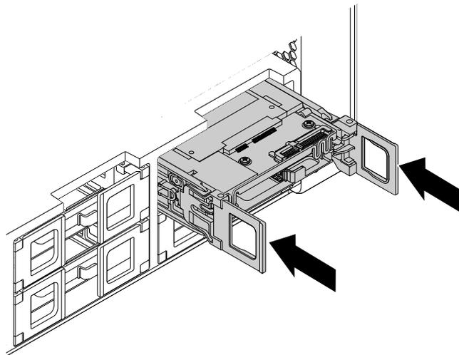
Abbildung 116. Halterung für das Speicherlaufwerk vom Typ **1** installieren
