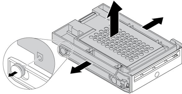
Abbildung 25. Das 2,5-Zoll-Speicherlaufwerk aus der Halterung entfernen
