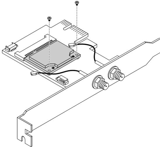
Abbildung 162. Die Schrauben, mit denen der Wi-Fi-Kartenmodul befestigt ist, entfernen
