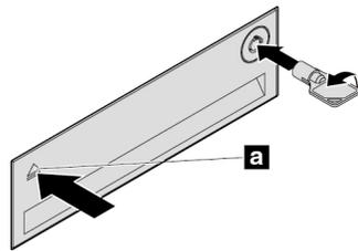
Abbildung 23. Abdeckung des Gehäuses mit Frontzugriff für die Speichereinheit öffnen
