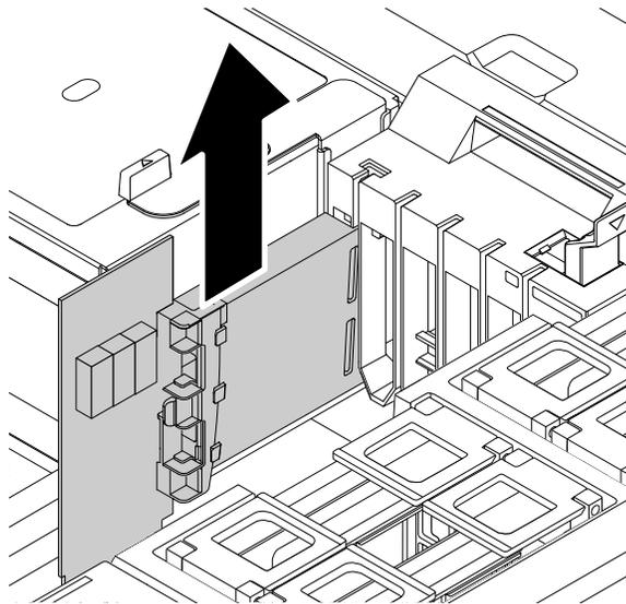
Abbildung 153. Flex-Adapter entfernen
