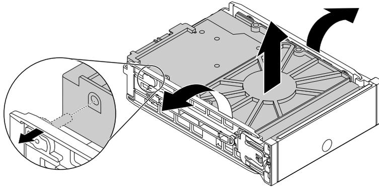
Abbildung 95. Speicherlaufwerk aus der Halterung vom Typ **2** entfernen
