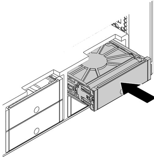
Abbildung 97. Halterung für das Speicherlaufwerk vom Typ **2** installieren
