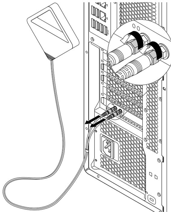
Abbildung 157. Hintere Wi-Fi-Antenne entfernen
