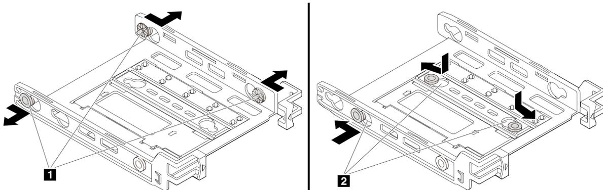
Abbildung 49. Drei Stifte entfernen und in die neuen Steckplätze einsetzen
