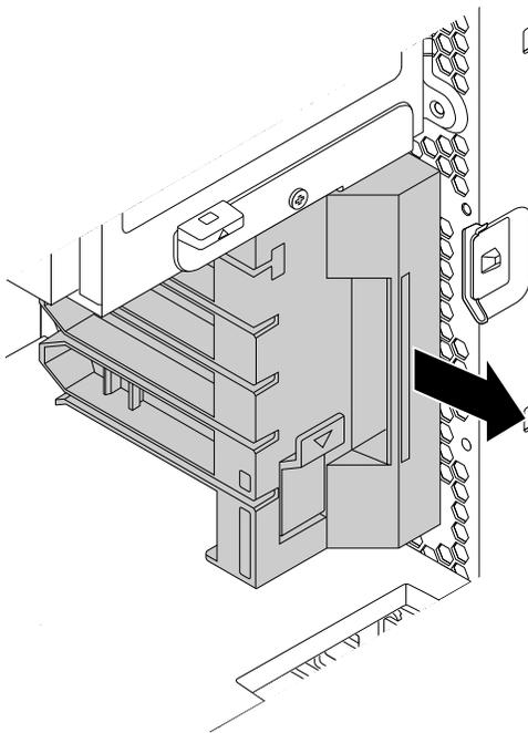
Abbildung 87. Lüftungsbaugruppe an der Vorderseite entfernen
