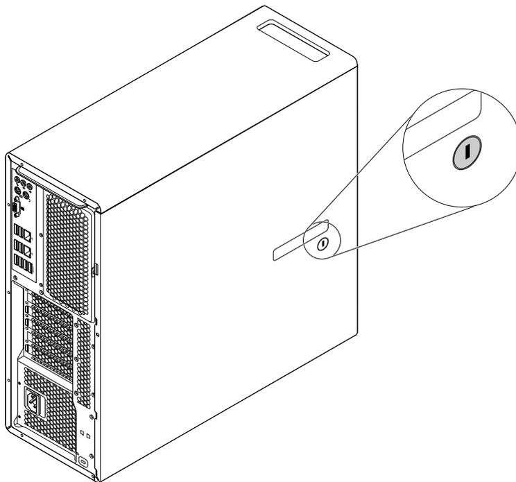
Abbildung 10. Computerabdeckung verriegeln
