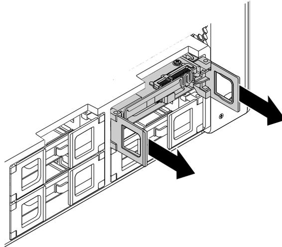
Abbildung 108. Halterung für das Speicherlaufwerk vom Typ 1 entfernen
