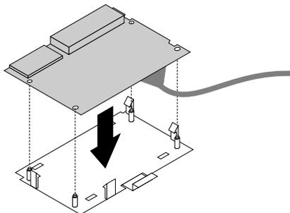
Abbildung 75. Das Lesegerät für Speicherkarten in die Halteklammer einsetzen
