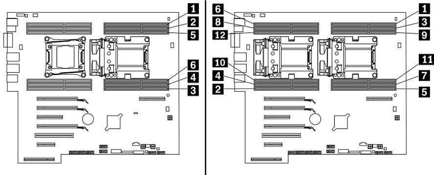
Abbildung 148. Installationsreihenfolge für Speichermodule für ThinkStation P710
