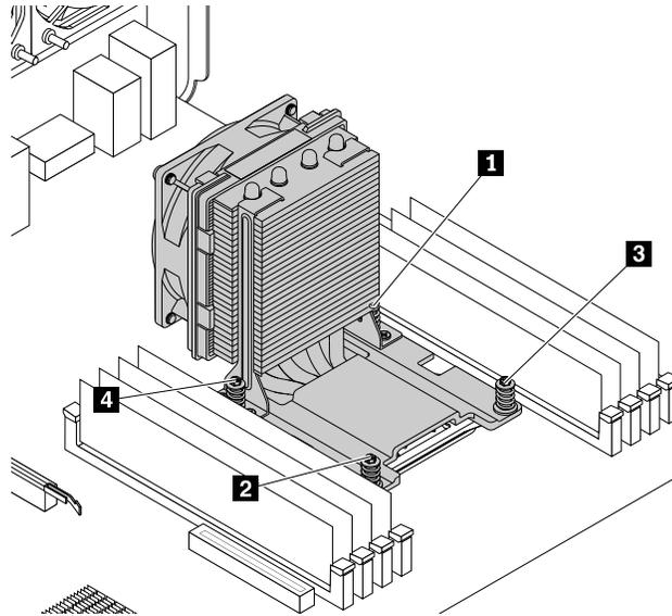
Abbildung 146. Kühlkörper- und Lüftungsbaugruppe entfernen
