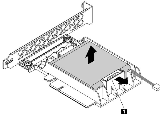
Abbildung 140. Superkondensatormodul aus der Halterung entfernen
