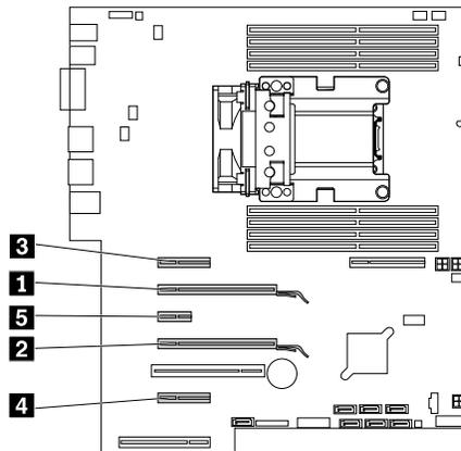
Abbildung 130. Installationsreihenfolge für PCI-Express-Karten für ThinkStation P510
