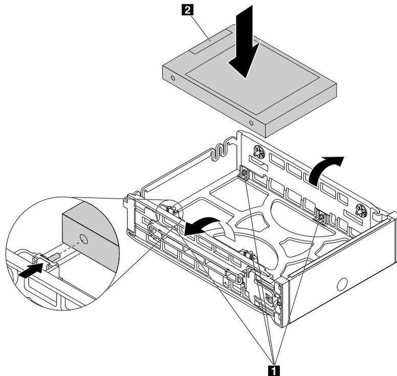
Abbildung 105. Speicherlaufwerk in der Halterung vom Typ **2** einbauen
