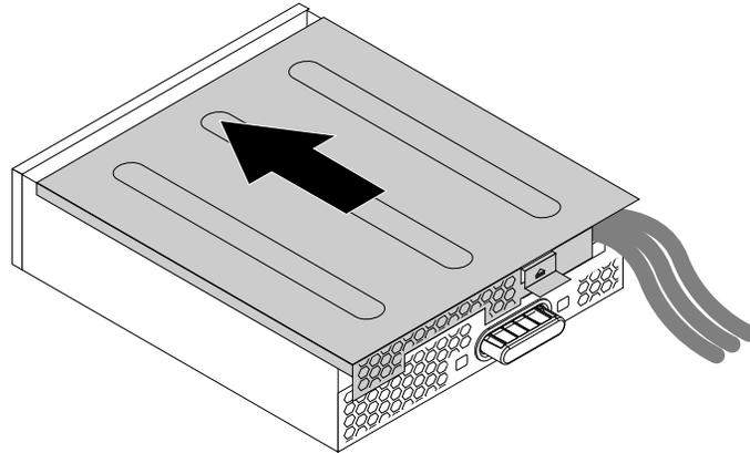
Abbildung 81. Abdeckung des Flexmoduls wieder anbringen
