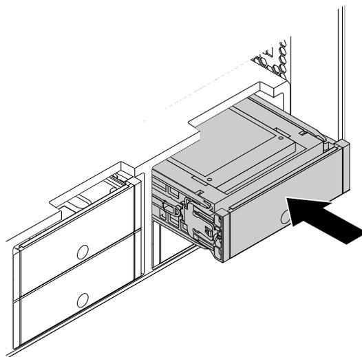
Abbildung 120. Halterung für das Speicherlaufwerk vom Typ **2** installieren
