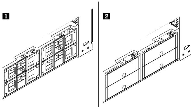
Abbildung 89. Zwei Arten von Halterungen für Speicherlaufwerke
