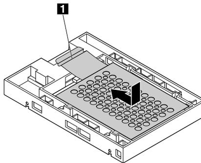
Abbildung 114. Metallhalterung im Kunststoffrahmen des Konverters installieren
