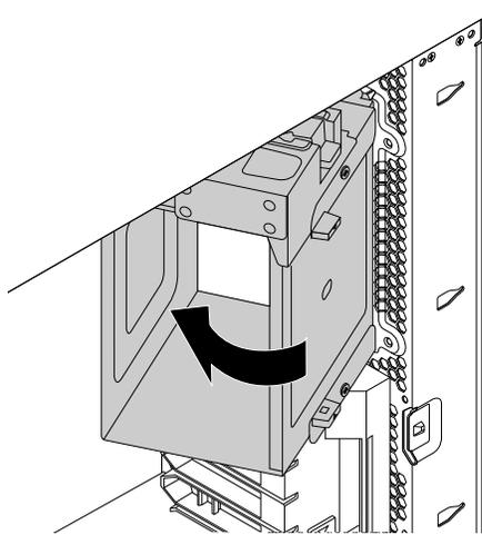
Abbildung 84. Halteklammer des optischen Laufwerks installieren
