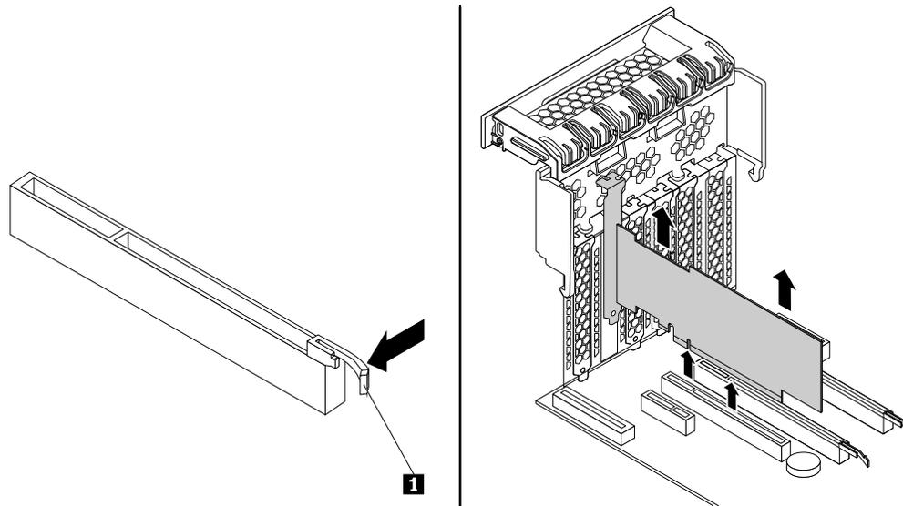
Abbildung 135. PCI-Karte entfernen
