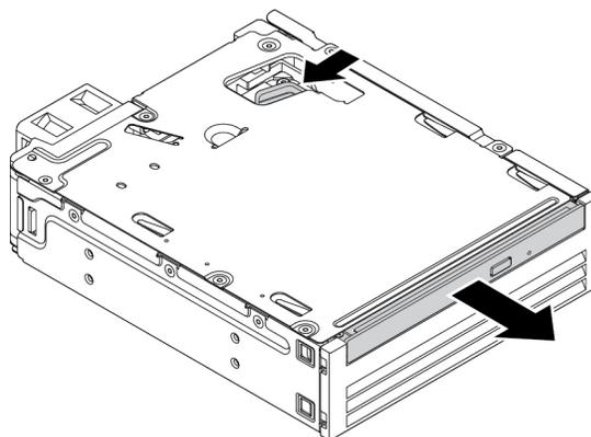
Abbildung 33. Flaches optisches Laufwerk aus dem Kit entfernen
