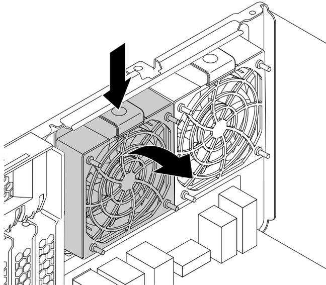
Abbildung 143. Lüftungsbaugruppe an der Rückseite entfernen
