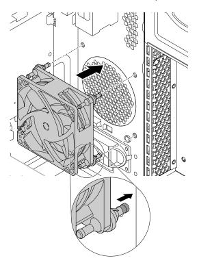
Figure 123. Installing the front fan
