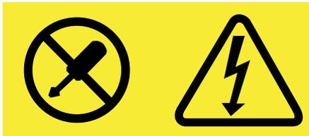
**Qualsiasi parte recante tale etichetta presenta livelli pericolosi di energia, corrente o voltaggio. All'interno di tali componenti non vi sono parti riparabili dall'utente. Se si sospettano problemi relativi a uno di questi componenti, contattare il tecnico dell'assistenza.**
