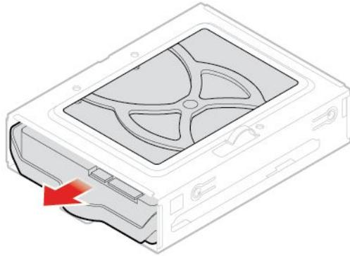
圖例 42. 卸下內部儲存磁碟機托架
