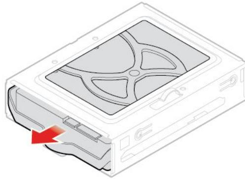
图 42. 卸下内部存储驱动器支架
