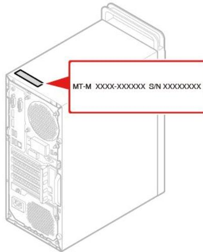
图 4. 机器类型和型号标签
