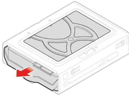
図 42. 内部ストレージ・ドライブストレージ・ドライブ・ブラケットの取り外し
