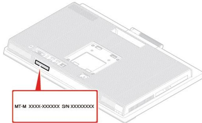
图 4. 机器类型和型号标签
