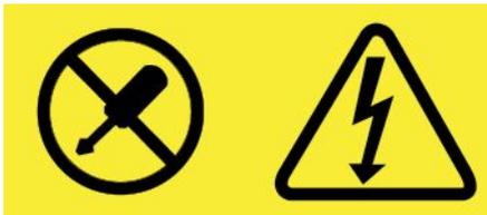
贴有这种标签的任何组件中都存在危险的电压、电流和能量级别。这些组件中没有可维修的部件。如果您怀疑其中的某个部件存在问题，请联系技术服务人员。
