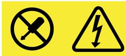
Quaisquer componentes que tenham esta etiqueta anexada possuem interiormente voltagem, corrente e níveis de energia perigosos. Não existem peças no interior desses componentes que possam ser consertadas. Se o Cliente suspeitar de algum problema com uma dessas peças, deve entrar em contato com um técnico de serviço.
