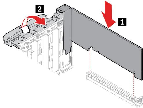
注：取り付け中は、スロットに PCI-Express カードの位置を合わせ、ラッチがカチッと音がして完全にはまるまでメモリーの両端を押し下げます。
