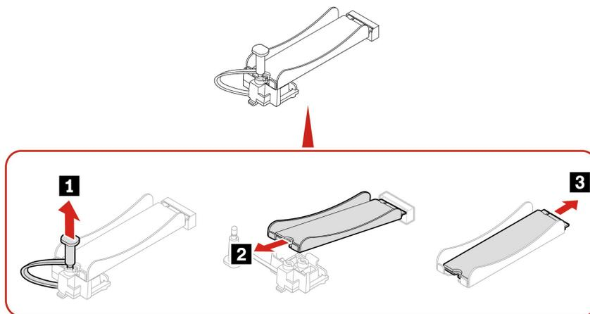
注：M.2ソリッド・ステート・ドライブとヒートシンクを取り付けるときは、サーマル・パッドを覆うフィルム(ある場合)を取り外します。
