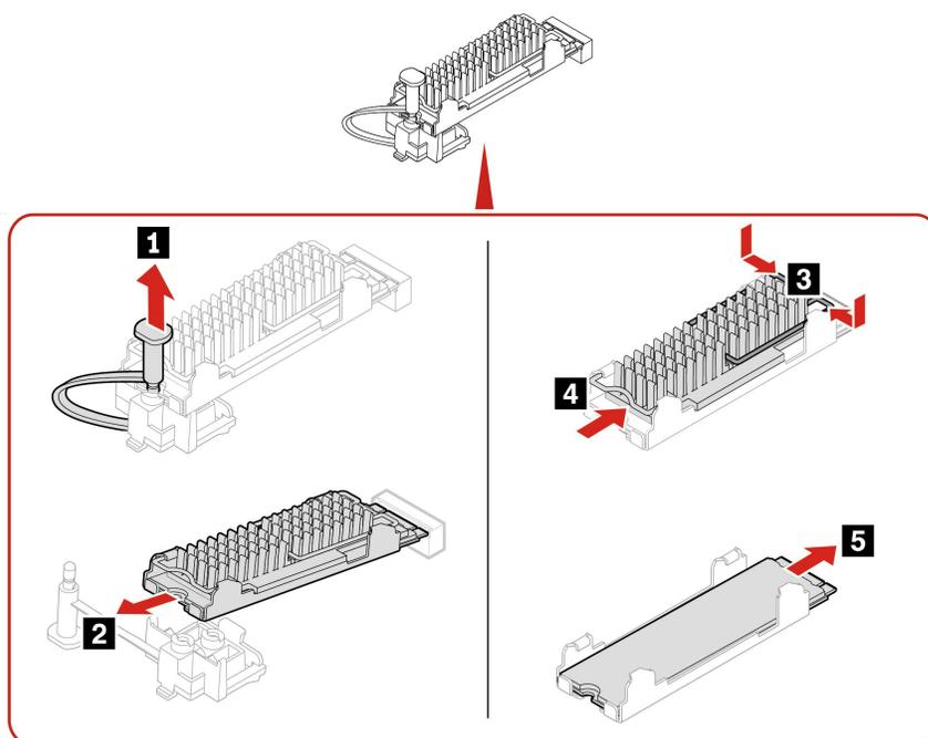
注：M.2ソリッド・ステート・ドライブとヒートシンクを取り付けるときは、サーマル・パッドを覆うフィルム(ある場合)を取り外します。
