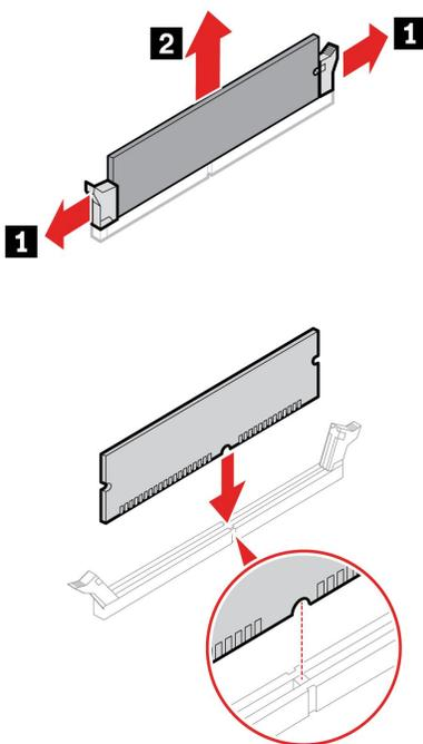
注：取り付け中は、スロットにメモリー・モジュールの位置を合わせ、ラッチがカチッと音がして完全にはまるまでメモリーの両端を押し下げます。
