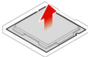
Obrázok 116. Otočenie soketu mikroprocesora smerom nahor
