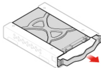
Obrázok 42. Vybratie držiaka 2,5-palcovej sekundárnej ukladacej jednotky
