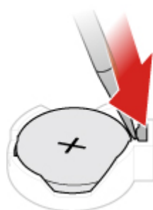
Obrázok 122. Stlačenie kovového jazýčka skrutkovačom
