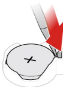
Abbildung 122. Die Metallzunge mit einem Schraubenzieher drücken
