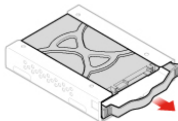
Abbildung 42. Das sekundäre 2,5-Zoll-Speicherlaufwerk aus der Halterung entfernen
