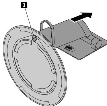
Figure 19. Retrait du socle d'écran à inclinaison réglable de la base
