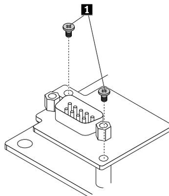
Figure 51. Installation des vis du module de connecteur série
