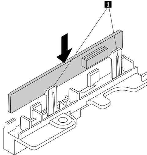
Figure 41. Installation de la carte du bouton de réglage (pour M800z)
