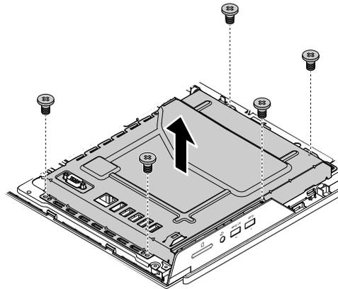
Figure 32. Retrait des vis du dispositif de protection de la carte mère
