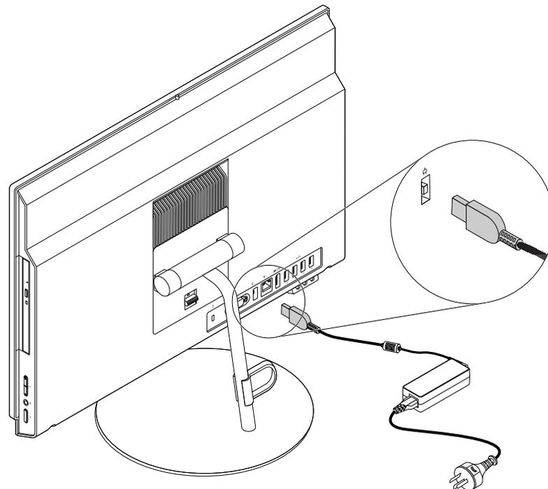
Figure 28. Débranchement du boîtier d'alimentation
