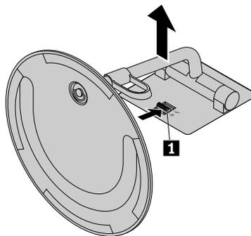
Figure 22. Retrait du socle d'écran à inclinaison réglable pour l'extraire du carter de l'ordinateur
