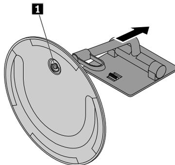
Figure 23. Retrait du socle d'écran à inclinaison réglable de la base
