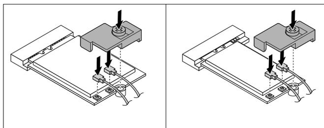
Figure 57. Connexion des câbles de l'antenne Wi-Fi et installation du dispositif de protection de la carte Wi-Fi.
