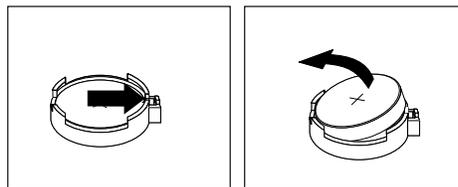
Figure 52. Retirer la batterie à pile cellulaire
