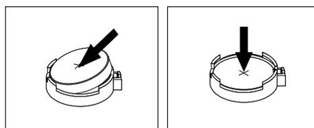
Figure 53. Installer la batterie à pile cellulaire
