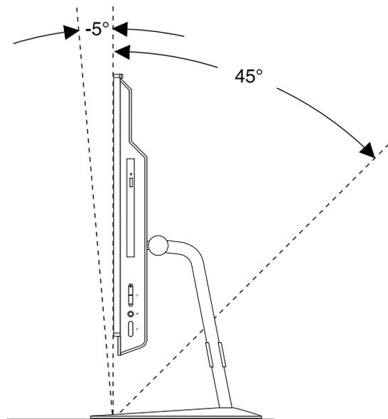
Figure 12. Réglage de l'inclinaison du socle de l'écran
