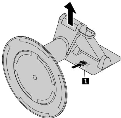
Figure 26. Retrait du socle UltraFlex II du carter de l'ordinateur
