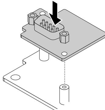
Figure 50. Installation du module de connecteur série
