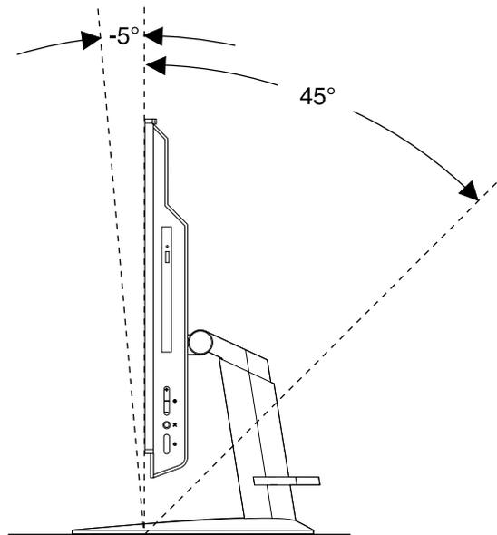
Figure 9. Réglage de l'ordinateur vers l'avant ou vers l'arrière
