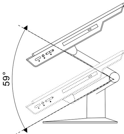
Figure 14. Réglage du socle UltraFlex II
