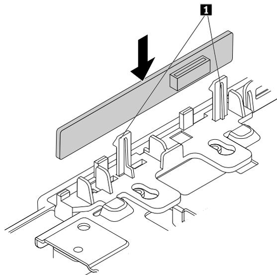
Figure 40. Installation de la carte du bouton de réglage (pour M700z)
