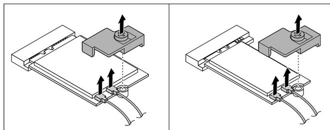
Figure 54. Retrait du dispositif de protection de la carte Wi-Fi et déconnexion des câbles de l'antenne Wi-Fi.
