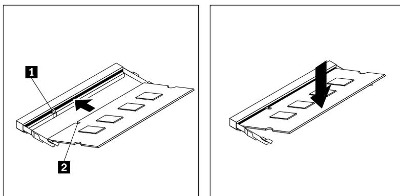
Figure 43. Installation du module de mémoire
