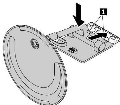
Figure 25. Installation du socle d'écran à inclinaison réglable sur le carter de l'ordinateur
