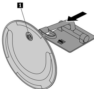
Figure 24. Installation du socle d'écran à inclinaison réglable sur la base
