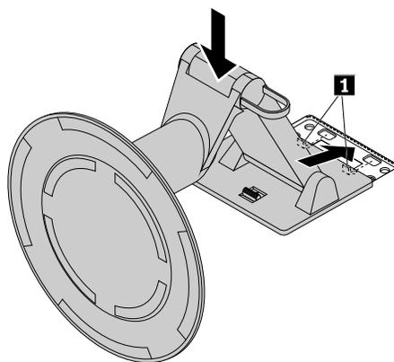
Figure 27. Installation du socle UltraFlex II sur le carter de l'ordinateur
