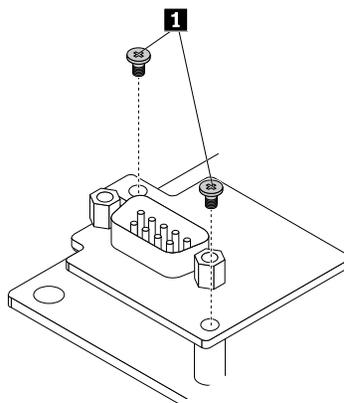
Figure 48. Retrait des vis du module de connecteur série
