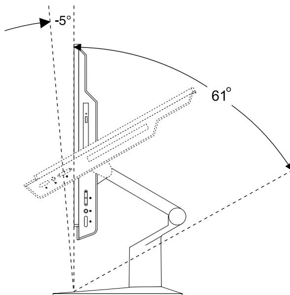
Figure 13. Réglage de l'ordinateur vers l'avant ou vers l'arrière
