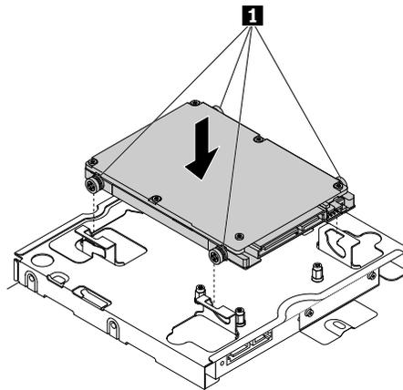
Figure 37. Installation de l'unité de stockage
