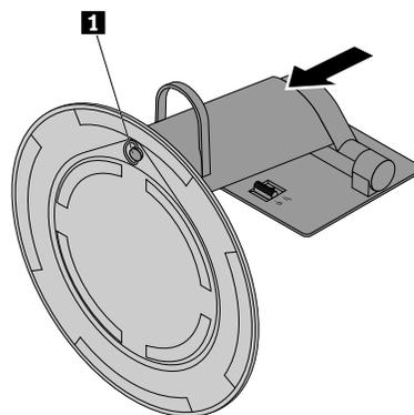
Figure 20. Installation du socle de l'écran aux fonctions complètes sur la base
