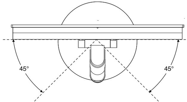
Figure 11. Pivotement de l'ordinateur vers la gauche ou vers la droite
