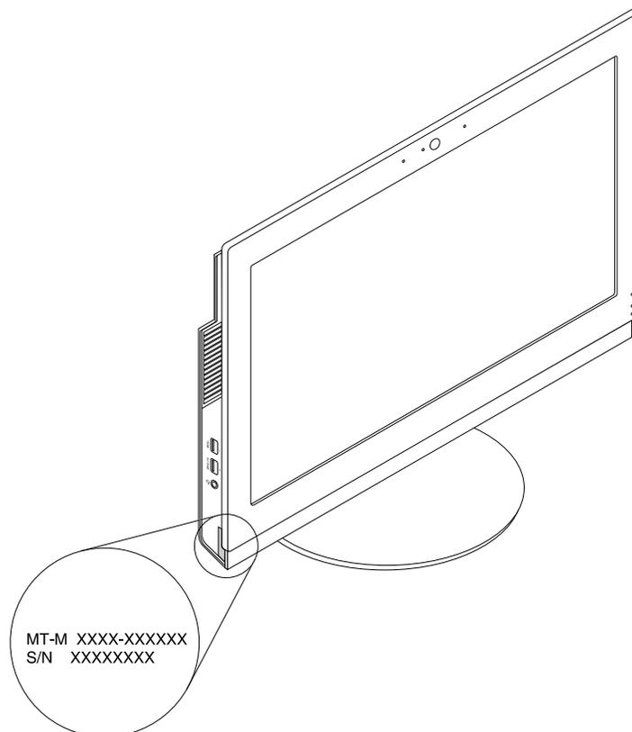
Figure 8. Type de machine et étiquette de modèle (pour M800z)
