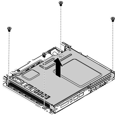
Figure 31. Retrait des vis du dispositif de protection de la carte mère
