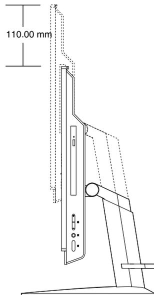
Figure 10. Réglage de la hauteur du socle d'écran aux fonctions complètes
