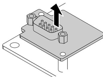
Figure 49. Retrait du module de connecteur série
