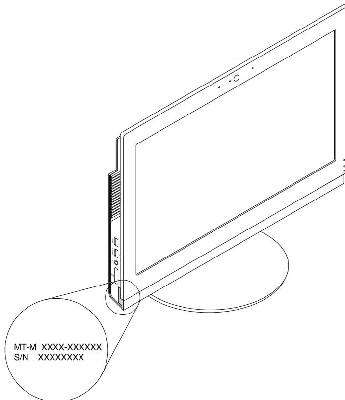
Figure 7. Type de machine et étiquette de modèle (pour M700z)
