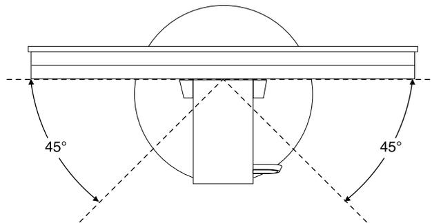
Figure 15. Réglage de l'ordinateur vers la gauche ou vers la droite
