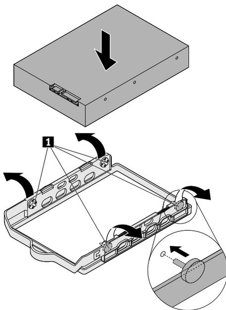
圖例 24. 將 3.5 吋主要儲存磁碟機裝入托架
