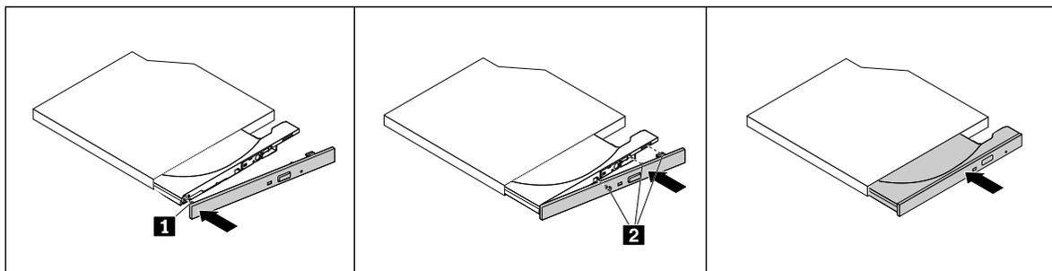
圖例 17. 將光碟機擋板安裝到光碟機
