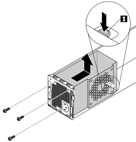
圖例 42. 卸下電源供應器組件
