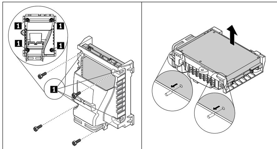
圖例 29. 從托架卸下 2.5 吋次要儲存磁碟機
