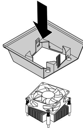
圖例 37. 裝上散熱器風扇隔板
