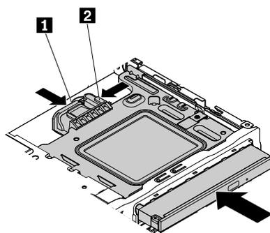
圖例 14. 將包含托架的光碟機卸下
