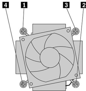
圖例 36. 卸下散熱器及風扇組件
