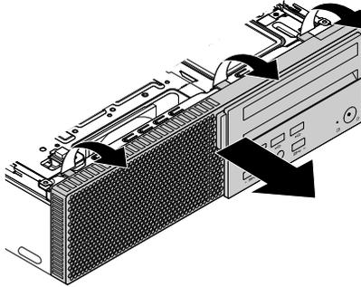
圖例 11. 卸下前方擋板
