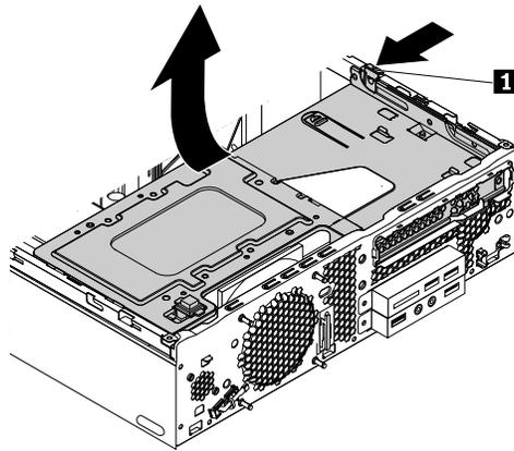
圖例 20. 向上轉動磁碟機槽組件
