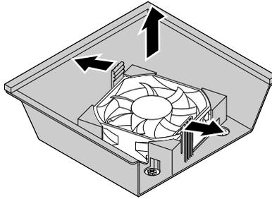
圖例 35. 拆下散熱器風扇隔板
