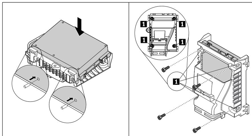
圖例 30. 將 2.5 吋次要儲存磁碟機裝入托架
