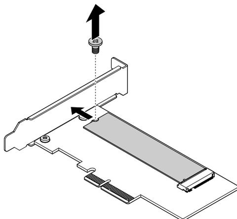
圖例 32. 卸下 M.2 固態硬碟
