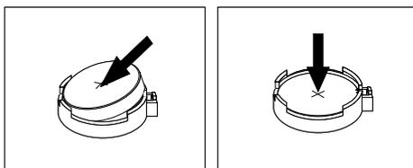
圖例 41. 安裝鈕扣型電池
