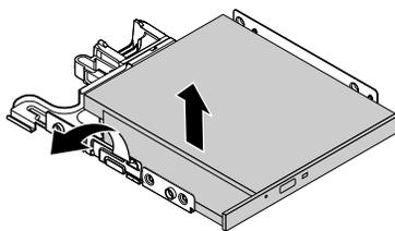
圖例 15. 從托架卸下光碟機
