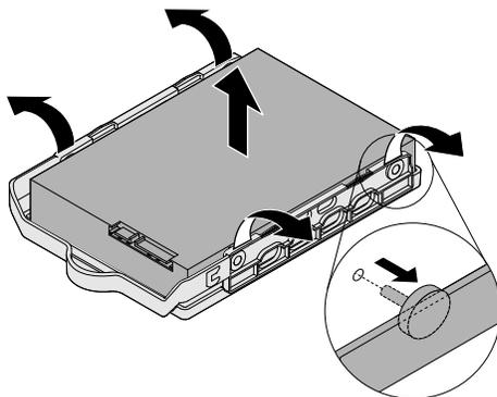
圖例 23. 從托架卸下 3.5 吋主要儲存磁碟機
