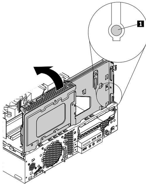
圖例 21. 向下轉動機槽組件
