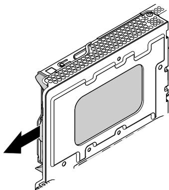
圖例 22. 卸下具備 3.5 吋主要儲存磁碟機的托架
