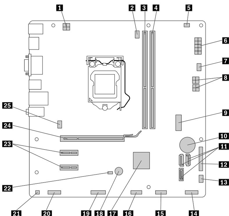
圖例 4. 主機板上的零件
