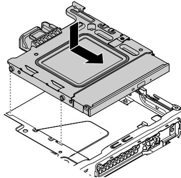
圖例 19. 安裝包含托架的光碟機
