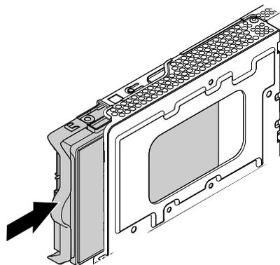
**圖例 25. 安裝具備 3.5 吋主要儲存磁碟機的托架**
