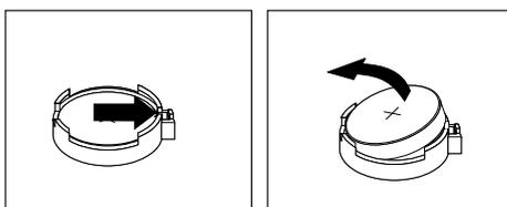
圖例 40. 取出鈕扣型電池
