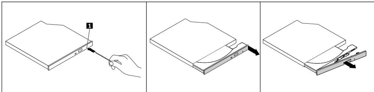
圖例 16. 從光碟機卸下光碟機擋板
