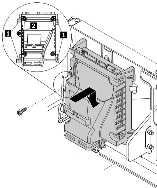
圖例 31. 安裝具備 2.5 吋次要儲存磁碟機的托架
