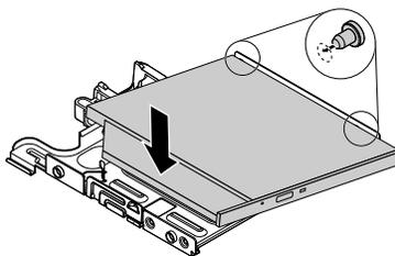
圖例 18. 將光碟機裝入托架
