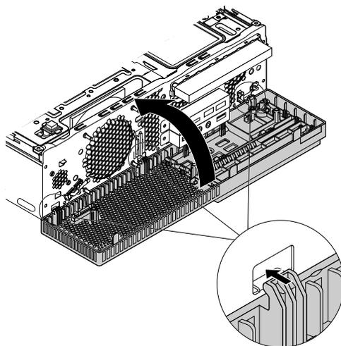
圖例 12. 安裝前方擋板
