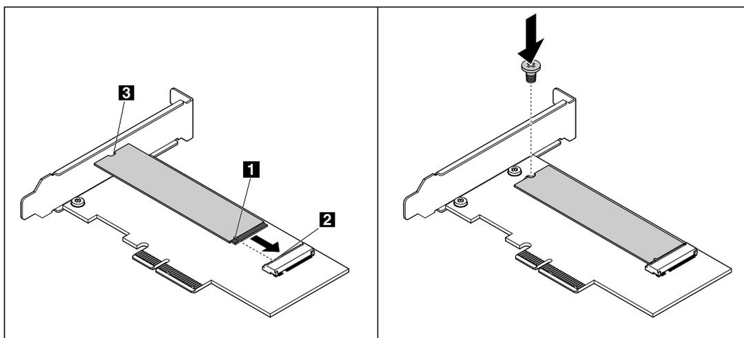
圖例 33. 安裝 M.2 固態硬碟
