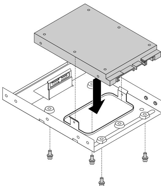
圖例 27. 將 2.5 吋主要儲存磁碟機裝入儲存裝置轉換器中
