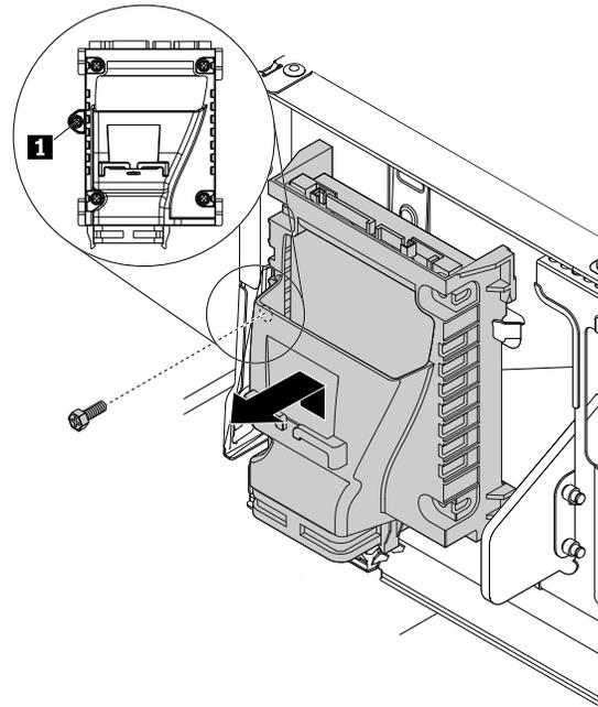
圖例 28. 卸下具備 2.5 吋次要儲存磁碟機的托架
