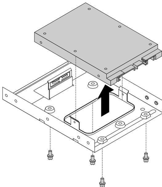
圖例 26. 從儲存裝置轉換器卸下 2.5 吋主要儲存磁碟機
