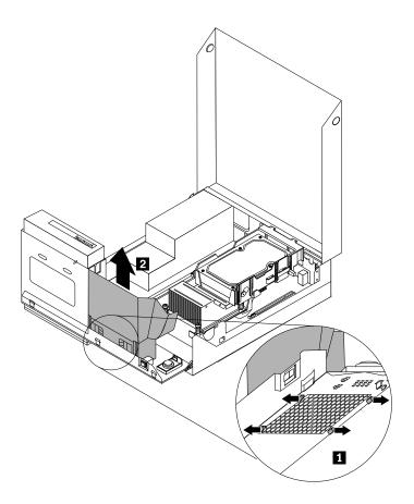
Figure 27. Removing the system fan
