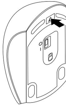
*Figure 5. Ouverture du compartiment de la batterie*
