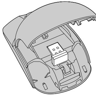
Figure 12. Stockage du dongle dans le compartiment de la batterie de la souris
