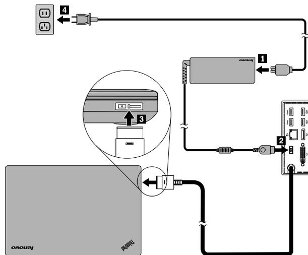
図3. ドックの電源機構およびノートブック・コンピューターへの接続
