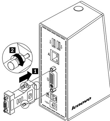
Figura 4. Utilización del adaptador de DVI-I a VGA
