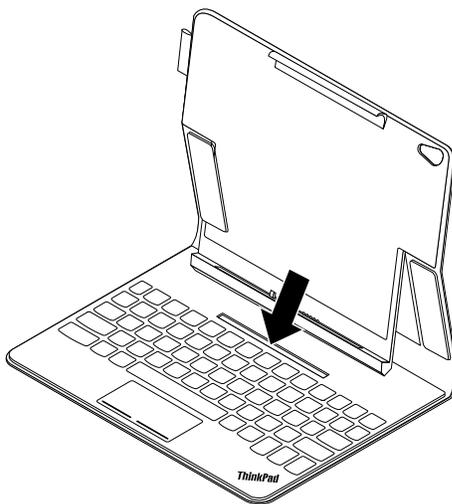
Figure 2. Alignement du logement de tablette (inférieur) et de la rainure de fixation de la tablette
