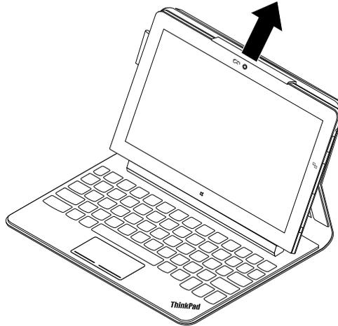
Figure 5. Libération du logement de tablette (inférieur) de la rainure de fixation de la tablette
