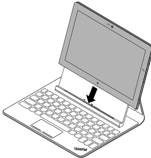
Figure 3. Alignement du connecteur clavier de la tablette avec le connecteur clavier de l'étui
