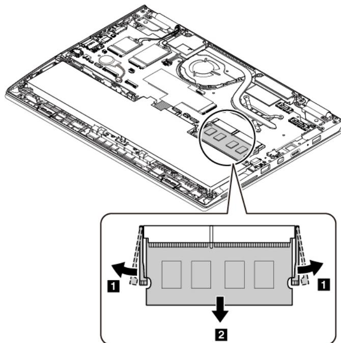
6. Inserire un nuovo modulo di memoria nello slot di memoria con un angolo di circa 20 gradi **1**. Ruotare il modulo di memoria verso il basso finché non scatta in posizione **2**. Verificare che il modulo di memoria sia installato saldamente nello slot di memoria e che non possa essere rimosso facilmente.
