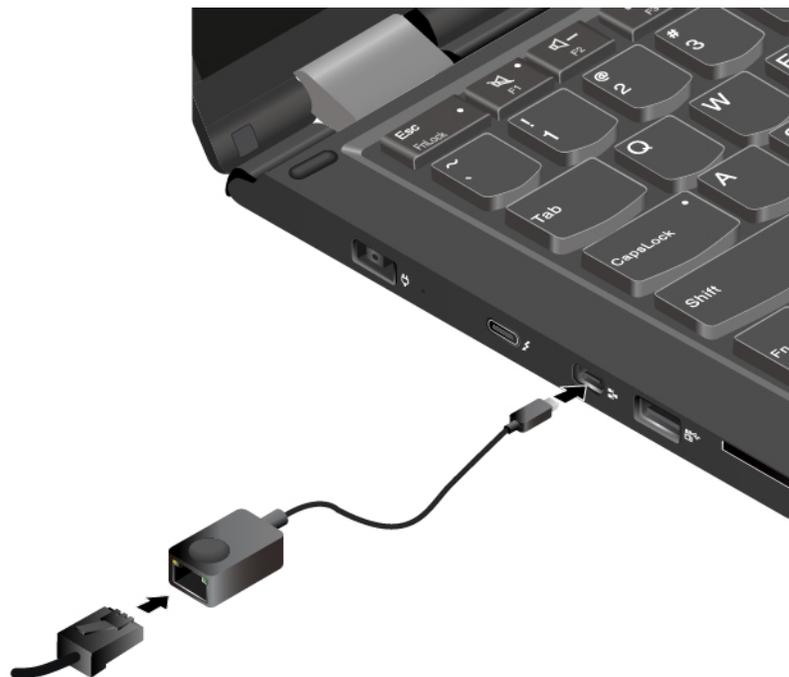
Il connettore Ethernet dispone di due indicatori che mostrano lo stato della connessione di rete. Quando l'indicatore verde è acceso, il computer è collegato a una rete LAN. Quando l'indicatore giallo lampeggia, è in corso la trasmissione dei dati.
