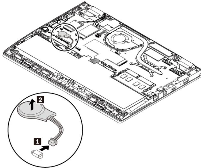
6. Installare la nuova batteria in formato moneta e collegare il connettore.
