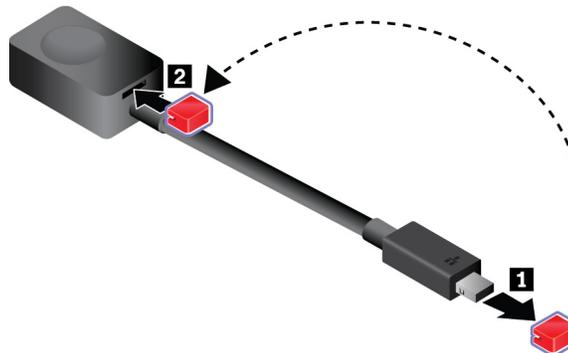
2. Collegare un'estremità dell'adattatore di prolunga Ethernet al mini-connettore Ethernet del computer. Quindi, collegare l'altra estremità a un cavo Ethernet.
