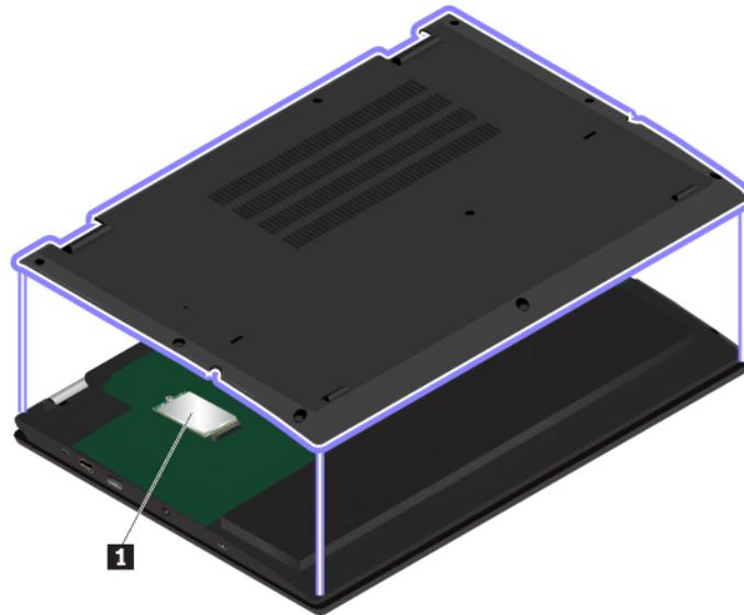
**Nota:** Per il modulo wireless installabile dall'utente, assicurarsi di utilizzare solo i moduli wireless autorizzati da Lenovo per il computer. Altrimenti, verrà visualizzato un messaggio di errore e il computer emetterà un segnale acustico quando viene acceso.
