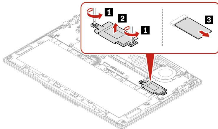
Schritt 2. Installieren Sie das M.2 Solid-State-Laufwerk und die M.2 Solid-State-Laufwerkshalterung in umgekehrter Reihenfolge.
