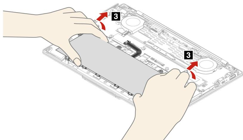
Schritt 2. Überprüfen Sie vor der Installation des internen Akkus das Akkufach und stellen Sie sicher, dass sich keine Fremdkörper oder scharfen Gegenstände darin befinden, die den Akku beschädigen könnten.
