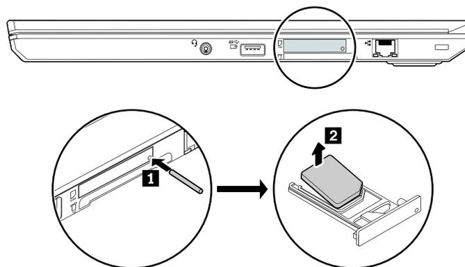
保守が終了したら、マイクロ SIM カードを取り付けたマイクロ SIM カード・トレイを元のとおりコンピュータにしっかりと取り付けてください。
