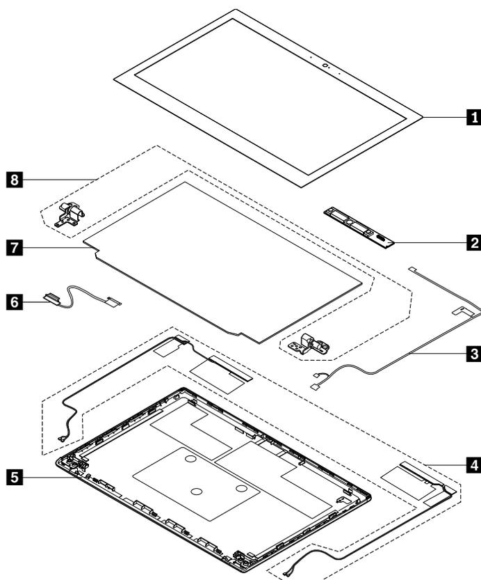
図 2. WiGig 非搭載モデルの LCD FRU
