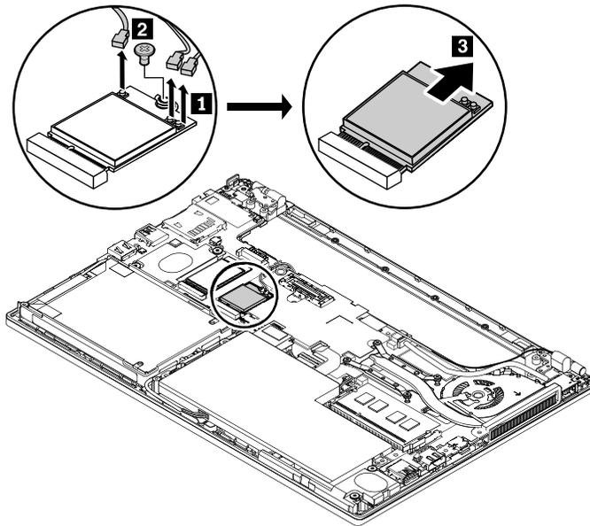
ステップ **1** で、アンテナ RF コネクター用の取り外しツールを使用してコネクターを取り外すか、図に示すように、コネクターを指でつまんで取り外します。
