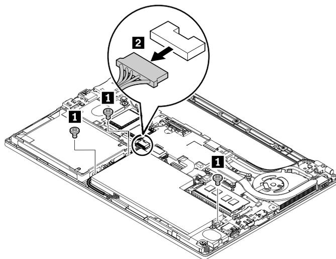
手順 **2** でバッテリー・コネクタを取り外すには、1本の指でコネクタを少し保持します。もう片方の手で、バッテリー・ケーブルを持って水平に引き出します。
