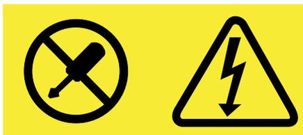
I componenti su cui è presente questa etichetta sono soggetti a voltaggio, corrente e livelli di energia pericolosi. Tali componenti non contengono parti riparabili da parte dell'utente. In caso di problemi con uno di questi componenti, contattare un tecnico di manutenzione.
