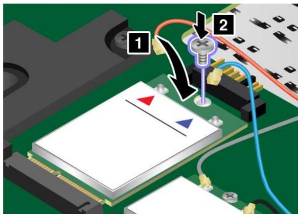
10. Branchez les câbles de l'antenne sur la nouvelle carte réseau étendu sans fil. Branchez le câble rouge sur le connecteur principal sur la carte et le câble bleu sur le connecteur auxiliaire sur la carte.
