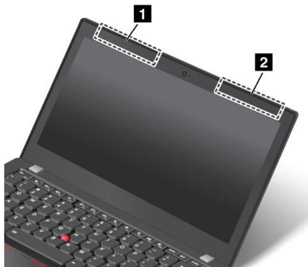
**1** Antenne réseau local sans fil (secondaire) et antenne réseau étendu sans fil (secondaire)
