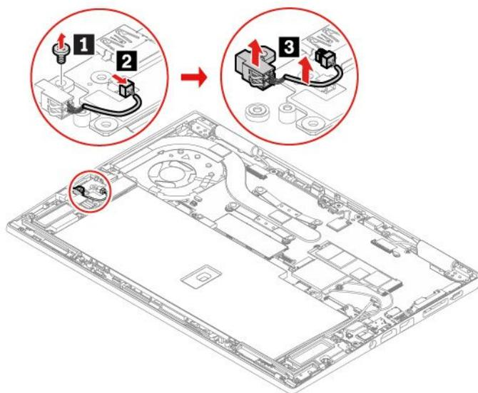
6. 将新的笔充电器安装到位 **1**。安装螺钉以固定笔充电器 **2**，然后连接接口 **3**。
