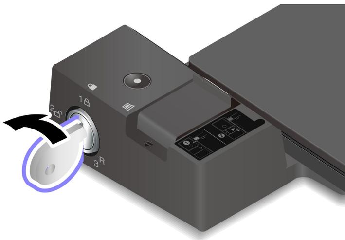
2. 朝所示方向滑动固定栓 1 以松开计算机，然后抓住计算机的两边将其卸下 2。
