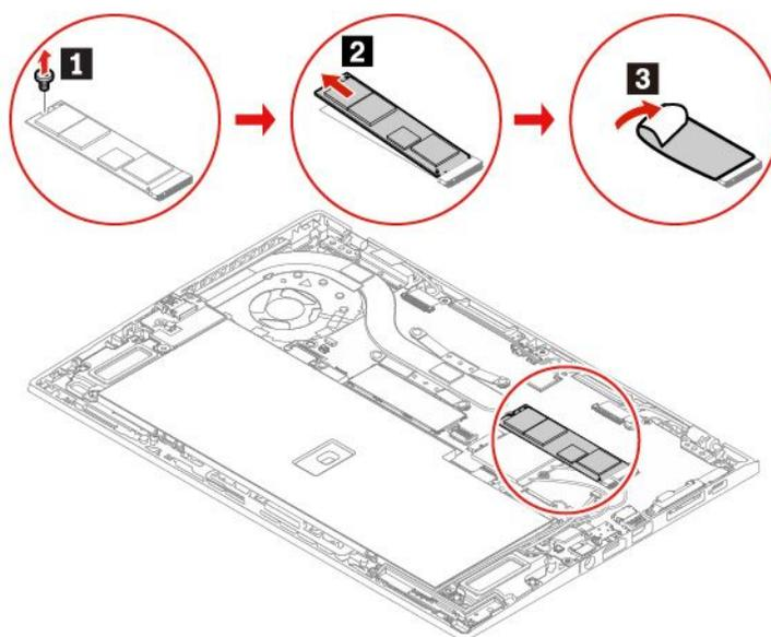
6. 安装新的 M.2 固态驱动器和新的导热垫：
