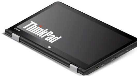
En la modalidad de tableta, el teclado y el dispositivo de área táctil se deshabilitan automáticamente. Sin embargo, puede controlar algunas funciones del sistema mediante los botones de la tableta y de la pantalla multitáctil, sin tener que utilizar el teclado y el dispositivo de área táctil. Para obtener más información, consulte “Uso de la pantalla multitáctil en ThinkPad X1 Yoga” en la página 22.
