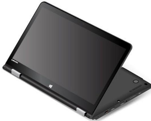
En la modalidad de pedestal, el teclado y el dispositivo de área táctil se deshabilitan automáticamente. Sin embargo, puede controlar algunas funciones del sistema mediante los botones de la tableta y de la pantalla multitáctil, sin tener que utilizar el teclado y el dispositivo de área táctil. Para obtener más información, consulte “Uso de la pantalla multitáctil en ThinkPad X1 Yoga” en la página 22.
