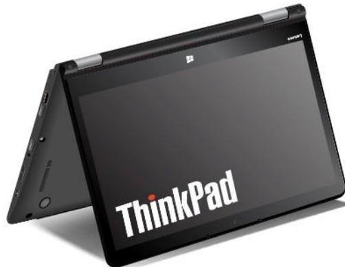
En la modalidad de lienzo, el teclado y el dispositivo de área táctil se deshabilitan automáticamente. Sin embargo, puede controlar algunas funciones del sistema mediante los botones de la tableta y de la pantalla multitáctil, sin tener que utilizar el teclado y el dispositivo de área táctil. Para obtener más información, consulte “Uso de la pantalla multitáctil en ThinkPad X1 Yoga” en la página 22.
