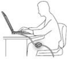
Cuando el adaptador de alimentación de CA está conectado a una toma eléctrica y al sistema, genera calor.
