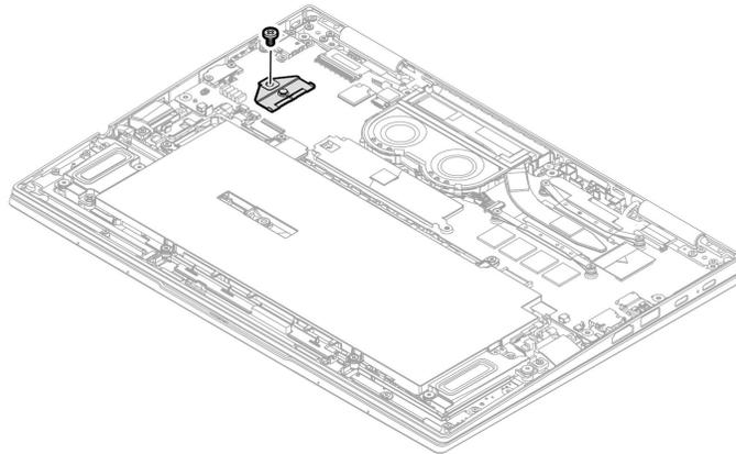
2. ワイヤレス WAN モジュールを約 20 度の角度でスロットに挿入し **1**、下方方向に倒します **2**。ねじを取り付けて、ワイヤレス WAN モジュールを固定します。 **3 4** 図のように青色のケーブルを **a** コネクターに、灰色がかった黒色のケーブルを **b** コネクターに、白色のケーブルを **c** コネクターに、オレンジ色のケーブルを **d** コネクターに接続していることを確認してください。
