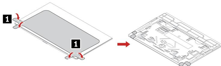
2. 図に示されているように、ジグ付きトラッカパッドを取り付けます。
