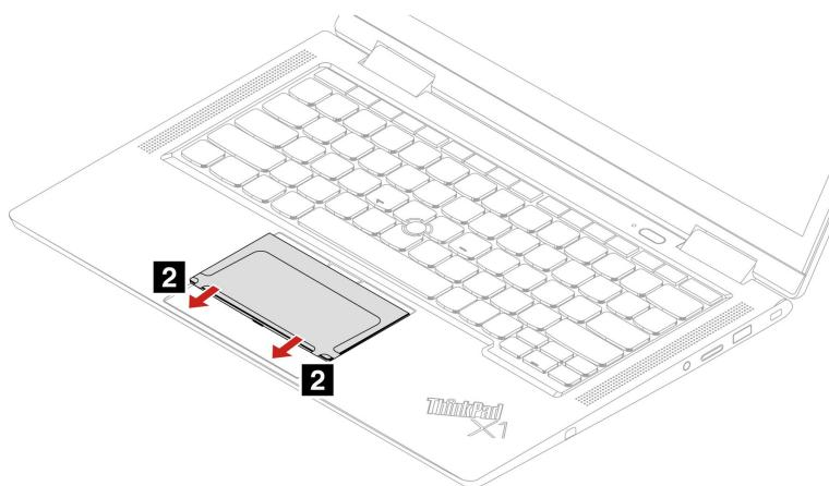
3. ねじを取り付けてトラックパッドを固定します。
