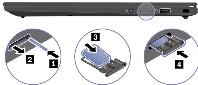
保守が終了したら、取り外した nano-SIM カードを元のとおりにコンピューターに取り付けてください。
