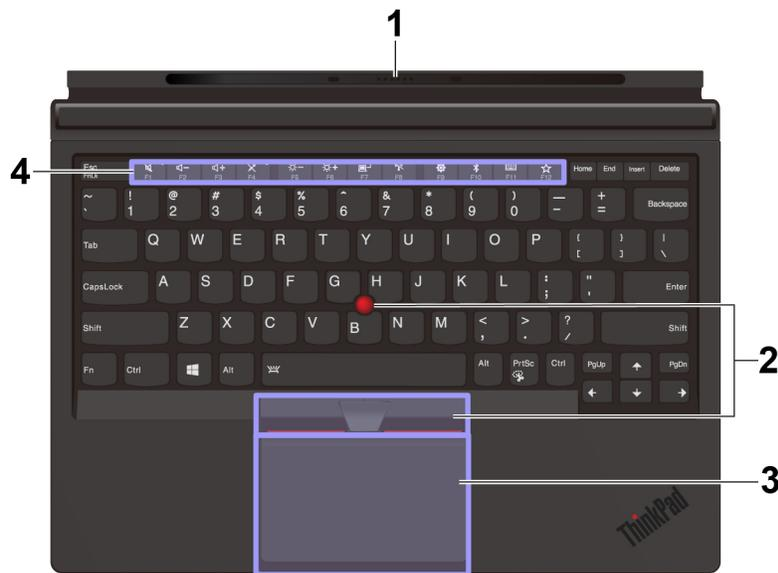
**1 Pogo-Abdeckung mit Führungsstiften:** Durch die Pogo-Abdeckung mit Führungsstiften können Sie die Tastatur magnetisch am Computer befestigen.
