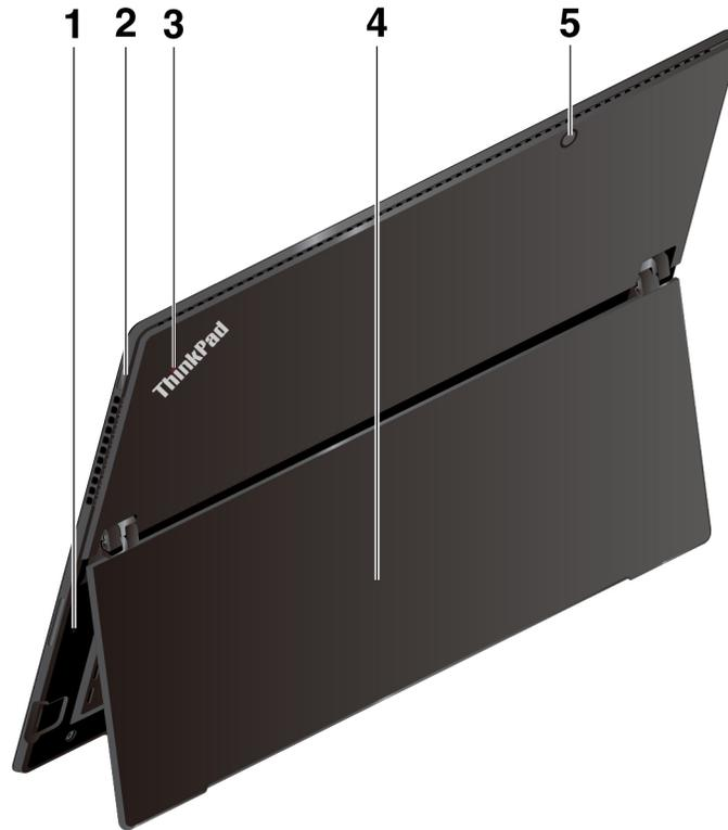
**1 Notrücksetzöffnung:** Wenn der Computer nicht mehr reagiert, entfernen Sie zuerst das Netzteil und führen Sie dann eine auseinander gebogene Büroklammer in die Notrücksetzöffnung ein, um den Computer zurückzusetzen.
