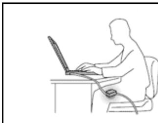
AC 電源アダプターは、コンセントおよびコンピューターとの接続中、熱を発生します。
