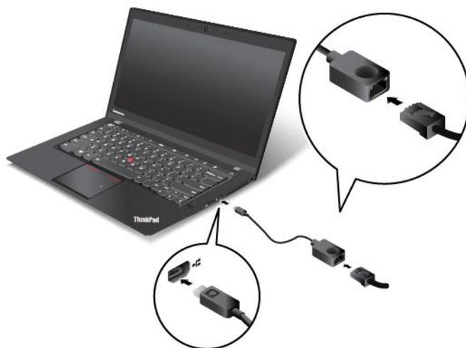
イーサネット拡張アダプターには、ネットワーク接続の状況を示す2つのインジケータがあります。左上のインジケータが緑色の場合、コンピューターがLANに接続されており、ネットワークとのセッションが使用可能であることを示しています。右上のインジケータが黄色く点滅している場合は、データが転送中であることを示しています。
