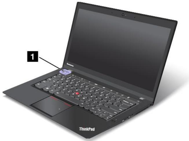
Fn キーを使用してモードを切り替えるときに表示されるモードの順序と使用可能なモードは、カスタマイズすることができます。ホーム・モードとファンクション・モードは常に使用できます。必要に応じて、Adaptive Keys をカスタマイズし、Fn キーをタップしたときに表示される切り替え順リストから Web ブラウザー・モードと Web 会議モードを削除できます。レイフラット・モードは、コンピューター画面をキーボードの相対位置に対して 180 度開いたときのみ使用できます。
