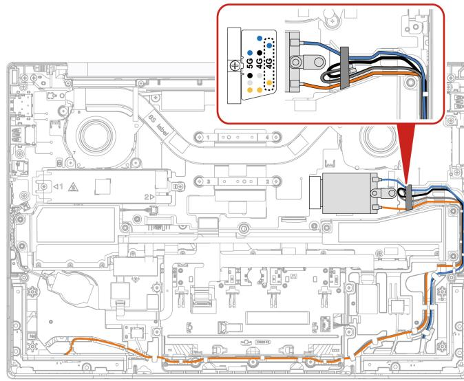
**Typ 2: Drahtloses WAN-Modul für 4G-Verbindungen mit 4 Anschlüssen**
