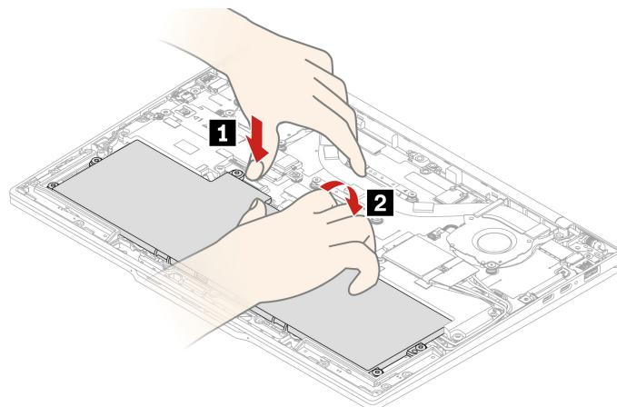
Schritt 2. Überprüfen Sie vor der Installation des internen Akkus das Akkufach und stellen Sie sicher, dass sich keine Fremdkörper oder scharfen Gegenstände darin befinden, die den Akku beschädigen könnten.
