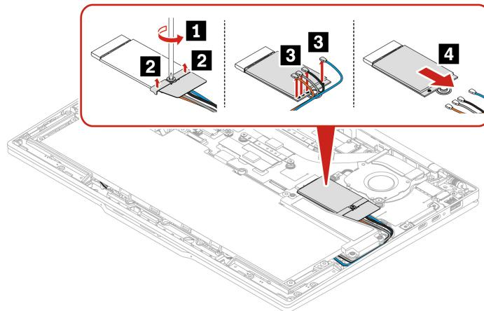
Schritt 2. Montieren Sie die Halterung und das drahtlose WAN-Modul in umgekehrter Reihenfolge.
