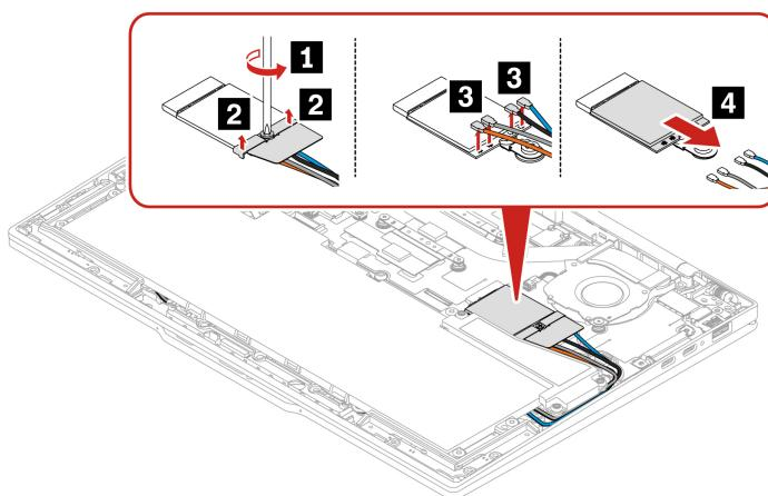
Schritt 2. Montieren Sie die Halterung und das drahtlose WAN-Modul mit seiner Halterung in umgekehrter Reihenfolge.
