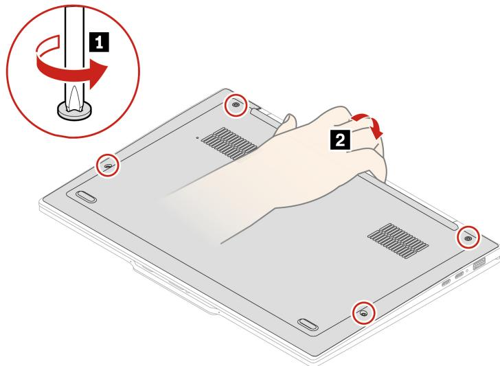
Schritt 2. Installieren Sie die Baugruppe der unteren Abdeckung in umgekehrter Reihenfolge.
