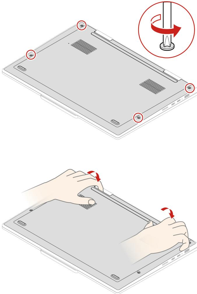
Schritt 2. Installieren Sie die Baugruppe der unteren Abdeckung in umgekehrter Reihenfolge.
