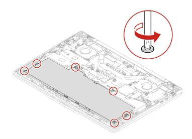
b. 下図のようにバッテリーを取り外します。
