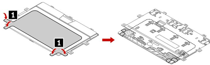
2. ジグ付きトラックパッドを取り付け、ねじを取り付けてトラックパッドを固定します。
