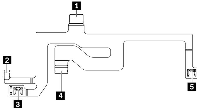
表 8. トラックパッド / 触覚タッチパッド、指紋センサー、P 型センサー・コネクタ、およびケーブル・ガイド
