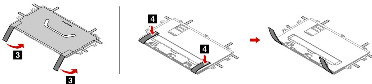
3. 触覚タッチパッドの角度を調整し、キーボードおよびキーボード・ベゼル・アセンブリーに触覚タッチパッドを取り付けます。
