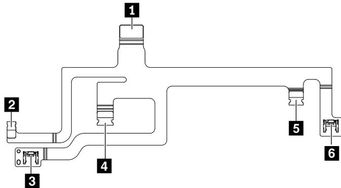
表 9. トラックパッド/触覚タッチパッド、指紋センサー、P 型センサーおよび NFC コネクター、およびケーブル・ガイド
