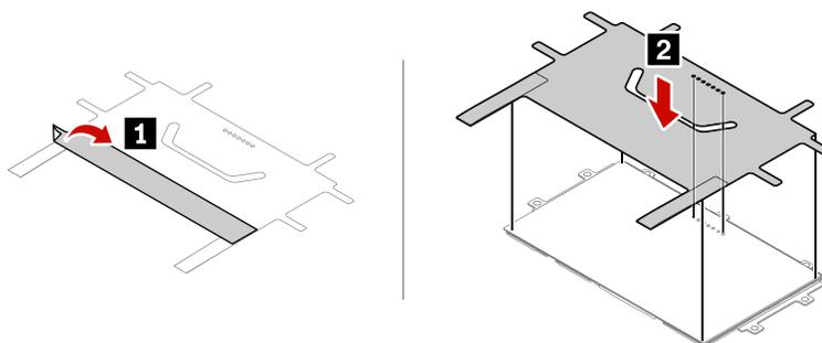
2. 図のように触覚タッチパッドを取り付け、2つの尾部を後方に折り返します。
