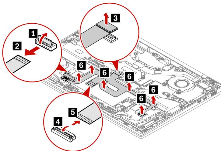
トラックパッド / 触覚タッチパッド、指紋センサー、および P センサー・ケーブルの取り外し手順
