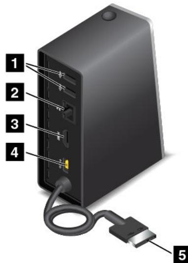
**1 Conector USB 2.0:** Utilizado para ligar dispositivos compatíveis com USB 2.0.
