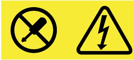
Estão presentes tensão, corrente e níveis elétricos perigosos dentro de qualquer peça que tenha esta etiqueta afixada. Não existem peças passíveis de assistência dentro destas peças. Se suspeitar de algum problema numa destas peças, contacte um técnico de assistência.
