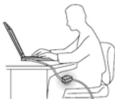
Quando o transformador está ligado a uma tomada e ao computador, é gerado calor.
