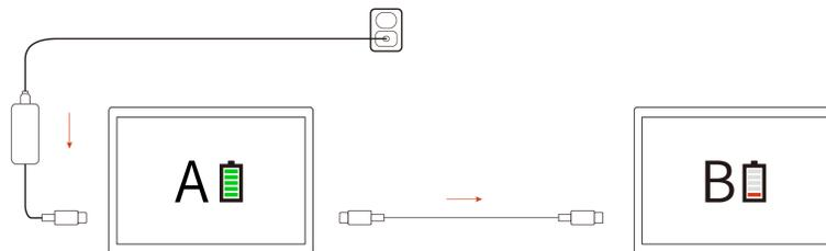
注：コンピューターの充電機能を使用した実際の充電速度は、コンピューターのバッテリー電源の残量、AC 電源アダプターのワット数、コンピューターを使用しているかどうかなど、様々な要因によって異なります。
