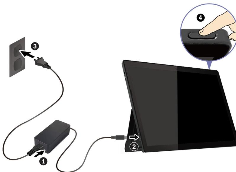
注：初めてコンピューターを使用するときは、完全に充電することをお勧めします。デスクトップの右下にある「バッテリー状況」アイコンをクリックしてバッテリーステータスをチェックします。
