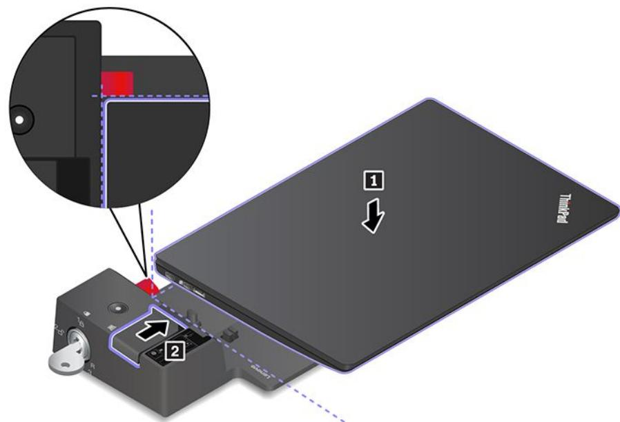
6. ドッキング状況インジケーターを確認します。コンピューターが正常にドッキングされると、ドッキング状況インジケーターが点灯します。
