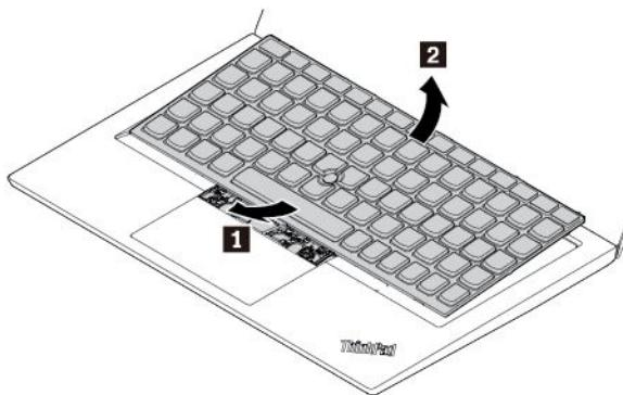
8. 図に示すようにキーボードをパームレストに乗せ、コネクターを取り外します。次に、キーボードを取り外します。
