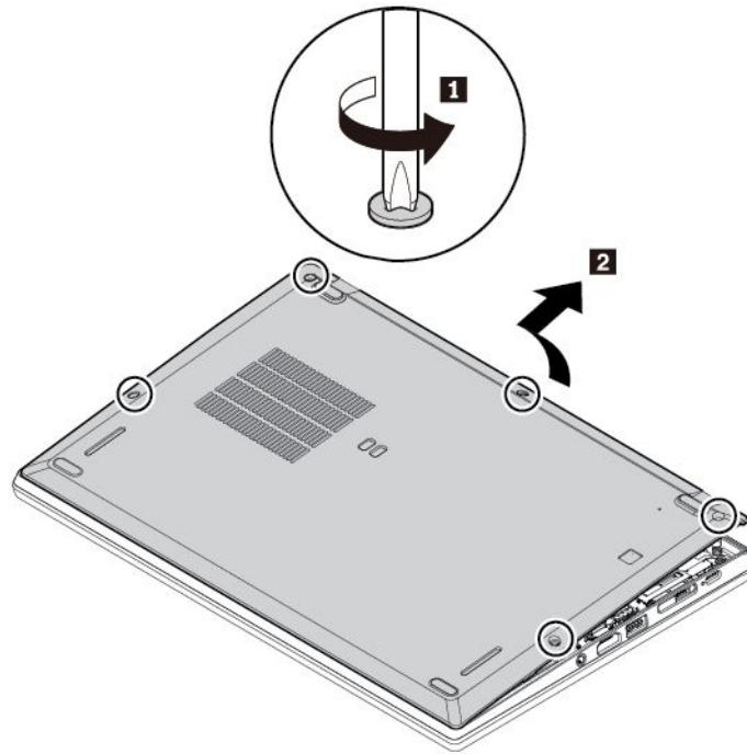
5. 新しいベース・カバー・アセンブリーを所定の位置に取り付けます **1**。図に示されているように、ベース・カバー・アセンブリーの左右の側面を押して **2**、ねじをアルファベットの昇順(aからe)に締めます **3**。
