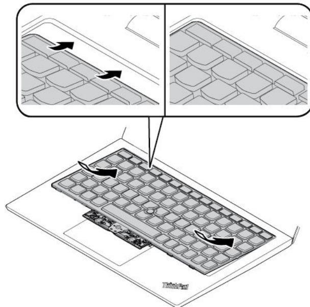
3. キーボードを矢印の方向にスライドさせます。ラッチがキーボード・フレームの下に固定されていることを確認します。
