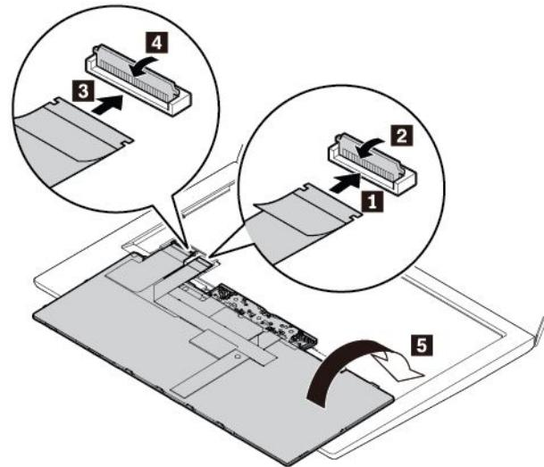
2. 図のようにキーボード・ベゼルにキーボードを挿入します。キーボードの上端(コンピューター画面に近い方の端)がキーボード・ベゼルのフレームより下にあることを確認してください。
