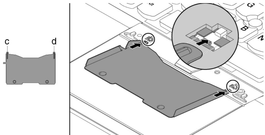
6. 図の方向にツールを回転させてキーボードを外します**1**。図の矢印**2**の方向にキーボードを押して、ラッチをキーボード・ベゼルから外します。
