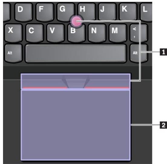
デフォルトでは、TrackPoint ポインティング・デバイスおよびトラックパッドのどちらでもタッチ・ジェスチャーが使用可能になっています。設定を変更するには、23 ページの「ThinkPad ポインティング・デバイスのカスタマイズ」を参照してください。
