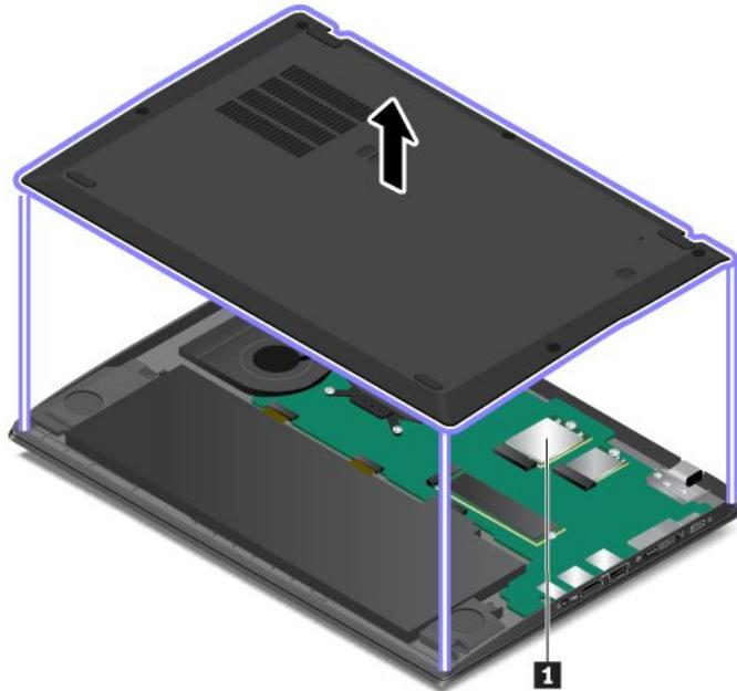
注：ユーザーによる取り付けが可能なワイヤレス・モジュールの場合は、このコンピューター・モデル向けに特にテストされた Lenovo 認定のワイヤレス・モジュールのみを使用していることを確認してください。それ以外の場合は、コンピューターの電源をオンにするとエラー・コードを示すビープ音が鳴ります。
