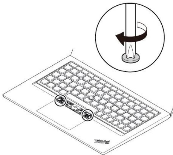
5. 新しいキーボードのパッケージから新しい TrackPoint ボタンを取り出します。図のように新しい TrackPoint ボタンを取り付けます。
