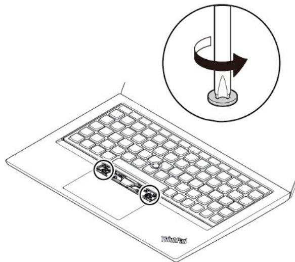
5. 図のように、タブ **c** および **d** を2つのねじ頭の側にある2つのくぼみに挿入します。
