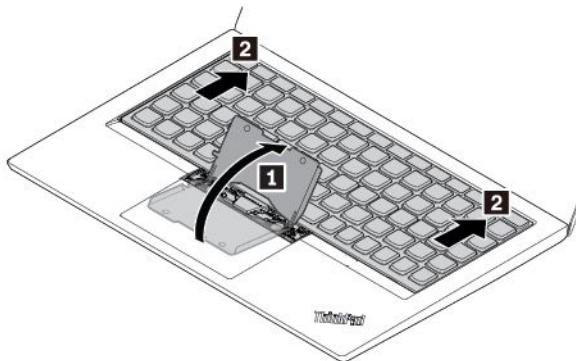
7. 矢印**1**が示すようにキーボードをわずかに上に傾けます。次に、矢印**2**で示すようにキーボードを裏返します。
