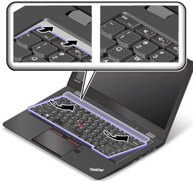
3. 確定螺絲頭都有露出。否則，將鍵盤框架向前滑動以露出螺絲頭。
