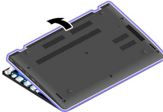
8. 鎖緊螺絲以固定底蓋組件。
