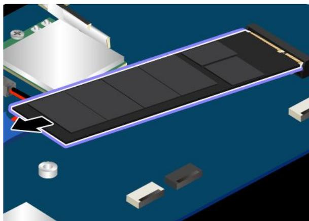
7. 將新 M.2 固態硬碟的接點邊緣與插槽中的突起部分對齊。然後小心地將 M.2 固態硬碟以大約 20 度角插入插槽。將 M.2 固態硬碟向下轉動，直到它卡入定位。請確定 M.2 固態硬碟已妥當安裝在插槽中，不會輕易脫落。
