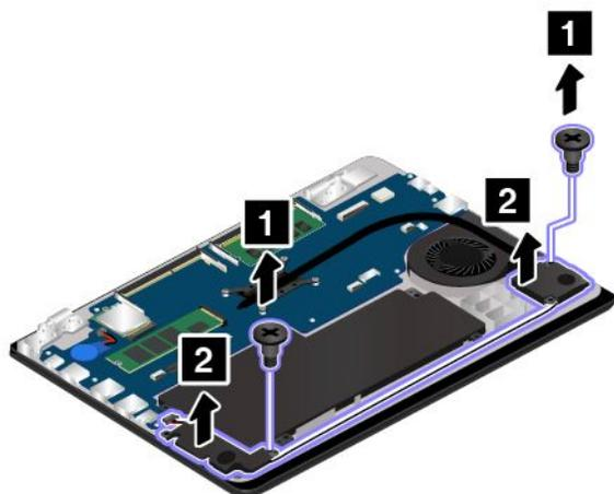
7. 將新的喇叭組件安裝在定位。然後鎖上螺絲以固定喇叭組件。
