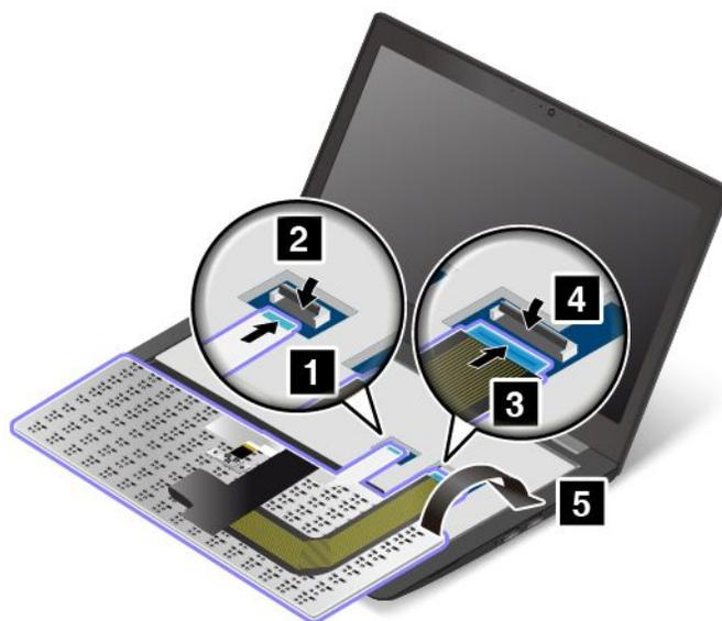
2. 如圖所示，將鍵盤插入鍵盤擋板。確定鍵盤的前緣（靠近顯示器的那一邊）在鍵盤擋板的框架下方。
