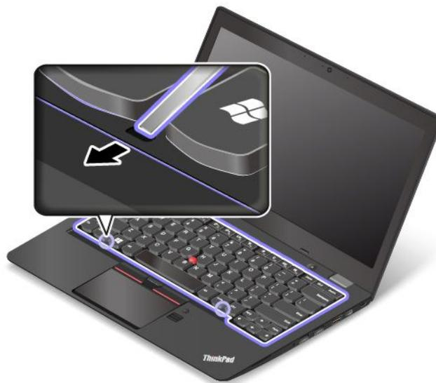
6. 如圖所示，將工具的平口端插入鍵盤側面，向後推動鍵盤框架。確定鍵盤框架和鍵盤擋板之間沒有空隙。
