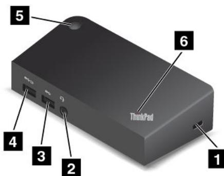
**1 安全鎖插槽：**如果要保護擴充基座避免遭竊，請購買符合這個安全鎖插槽的安全鋼纜鎖，將擴充基座鎖到固定物體上。
