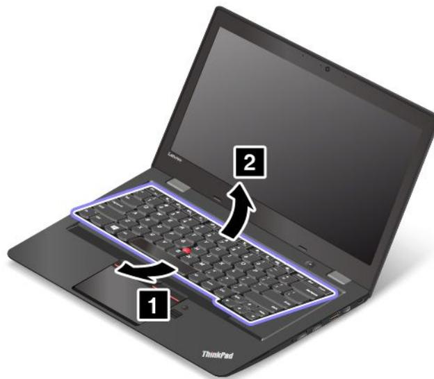
5. 將鍵盤放在置腕區上，然後拔掉接頭。然後拆下鍵盤。
