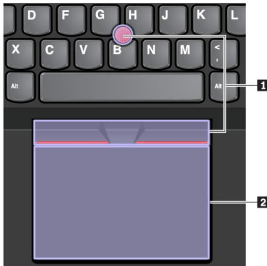
De forma predeterminada, el dispositivo de puntero de TrackPoint y el área táctil se activan con los gestos de contacto habilitados. Para cambiar la configuración, consulte “Personalización del dispositivo de puntero de ThinkPad” en la página 22.
