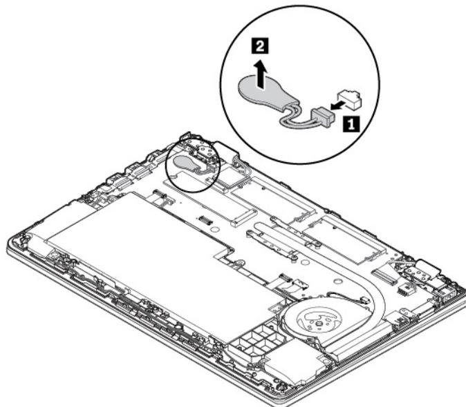
6. Instale la nueva batería plana **1** y conecte el conector **2**.
