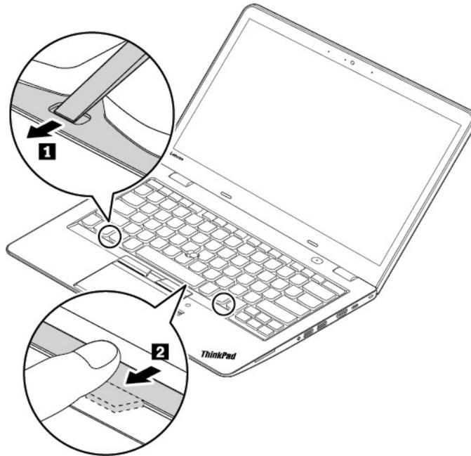
6. Inserte el extremo plano de la herramienta en los costados del teclado, como se muestra para empujar el marco del teclado hacia atrás. Asegúrese de que no quede espacio entre el marco y el bisel del teclado.
