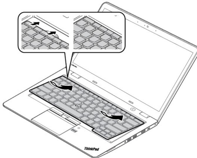
3. Asegúrese de que las cabezas de los tornillos queden completamente expuestas. De lo contrario, exponga las cabezas de los tornillos deslizando el marco del teclado hacia delante.
