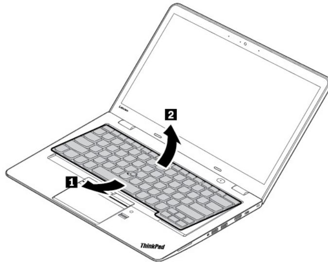
5. Coloque el teclado en el reposa manos y desconecte los conectores. Luego extraiga el teclado.
