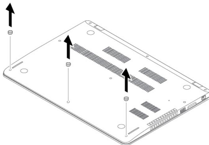
5. Suelte los tornillos que fijan el conjunto de la cubierta de la base. Abra los pestillos, como se ilustra. A continuación, extraiga el conjunto de la cubierta de la base.
