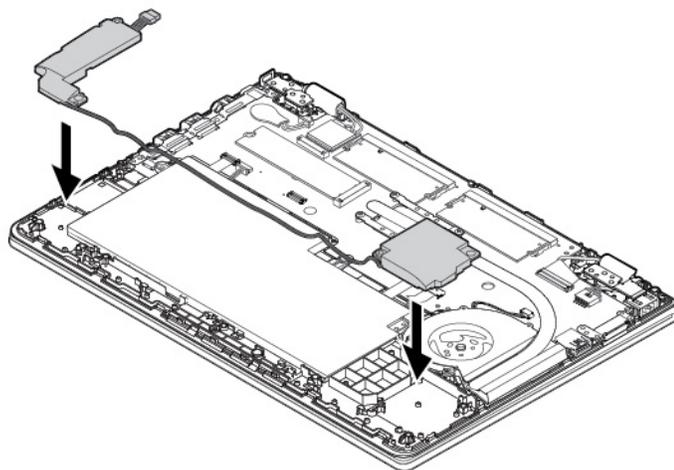
8. Luego, instale los tornillos para asegurar el conjunto de altavoz **1**. Vuelva a conectar el conector **2**.
