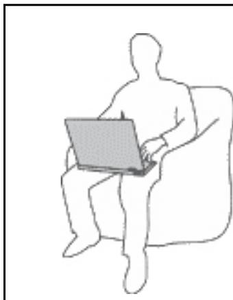
Cuando el sistema está encendido o la batería se está cargando, la base, el reposamanos y alguna otra parte del sistema pueden calentarse. La temperatura que alcanzan depende de la cantidad de actividad del sistema y del nivel de carga de la batería.
