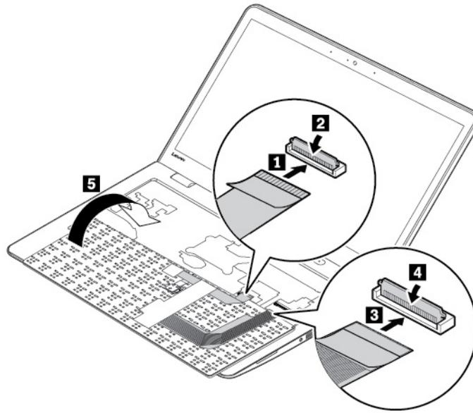
2. Inserte el teclado en el bisel del teclado, como se muestra. Asegúrese de que el borde frontal del teclado (el borde que está cerca de la pantalla) se encuentre bajo el marco del bisel del teclado.
