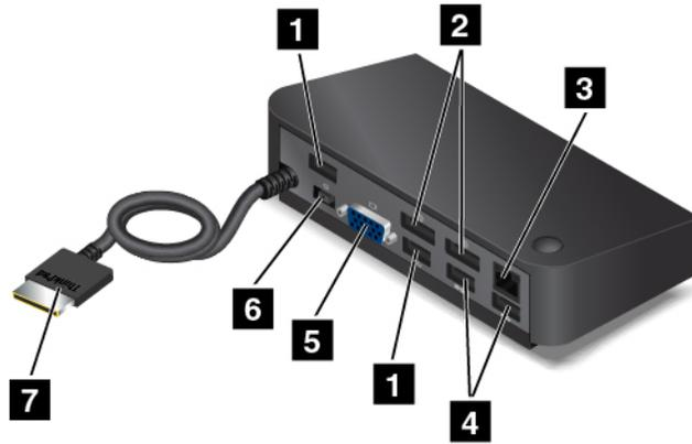
**1 Conector USB 2.0:** conecta dispositivos compatibles con USB, como un teclado USB, mouse USB, dispositivo de almacenamiento USB o una impresora USB.
