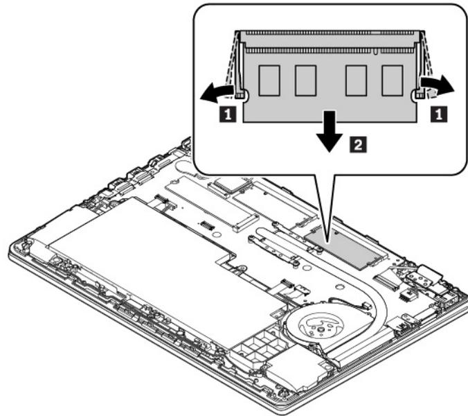
6. Inserte el nuevo módulo de memoria en la ranura de memoria, en un ángulo de aproximadamente 20 grados **1**. Gire el módulo de memoria hacia abajo hasta que encaje en su sitio **2**. Asegúrese de que el módulo de memoria instalado firmemente en la ranura y no se pueda mover con facilidad.
