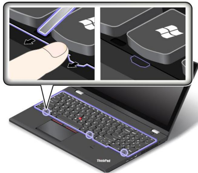
6. Regolare la struttura della tastiera in posizione con il cacciavite a testa piatta per accertarsi che tutti i fermi siano fissati sotto la mascherina della tastiera.
