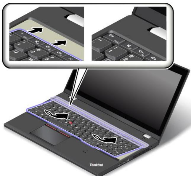
3. Scoprire le teste delle viti facendo scorrere la struttura della tastiera in avanti con il cacciavite a testa piatta. Verificare che le teste delle viti siano esposte correttamente.
