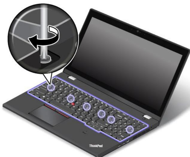
5. Far scorrere la struttura della tastiera all'indietro di 2,5 mm con il cacciavite a testa piatta. Nascondere i fermi della struttura della tastiera sotto la relativa mascherina premendo i fermi con il dito come mostrato.
