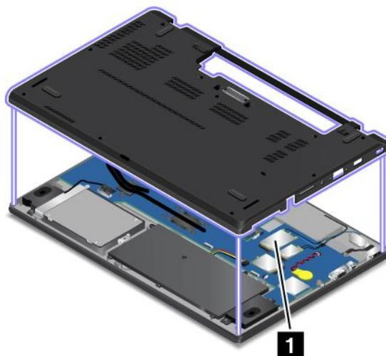
**Anmerkung:** Stellen Sie für das durch den Benutzer installierbare Modul sicher, dass Sie nur ein von Lenovo autorisiertes drahtloses Modul für den Computer verwenden. Andernfalls werden beim Einschalten des Computers eine Fehlermeldung angezeigt und akustische Signaltöne ausgegeben.
