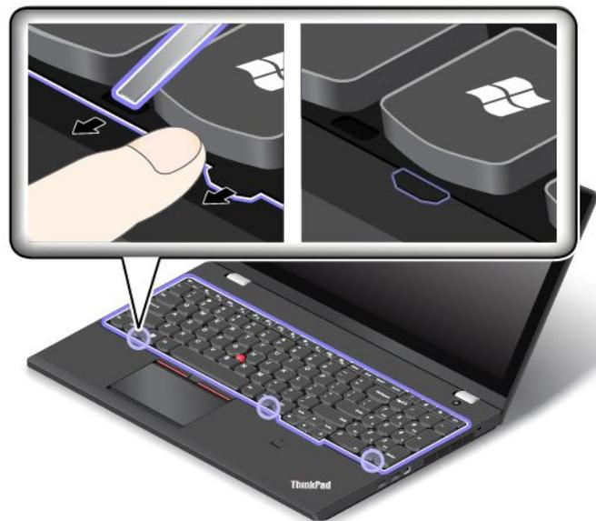
6. Passen Sie den eingesetzten Tastaturrahmen mit dem flachen Ende des Tastatur-Multifunktionswerkzeugs an und stellen Sie sicher, dass sämtliche Verriegelungen unter der Tastaturblende gesichert werden.
