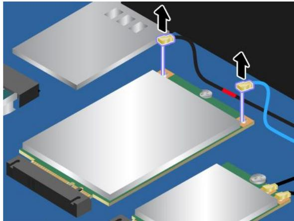
6. Entfernen Sie die Schraube. Die Karte für drahtlose WAN-Verbindungen wird aus der sicheren Stellung gelöst und dreht sich nach oben.
