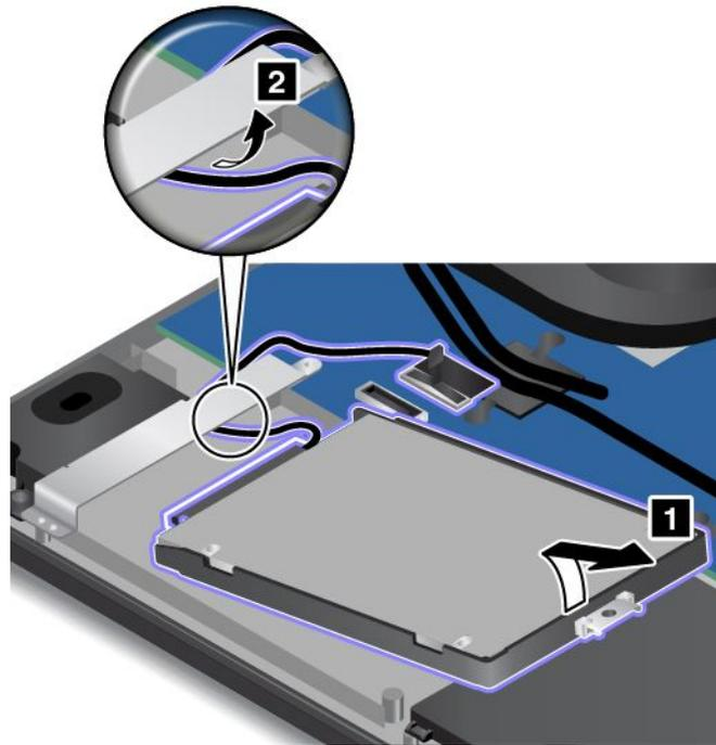
7. Ziehen Sie das Laufwerkskabel vom Speicherlaufwerk ab.
