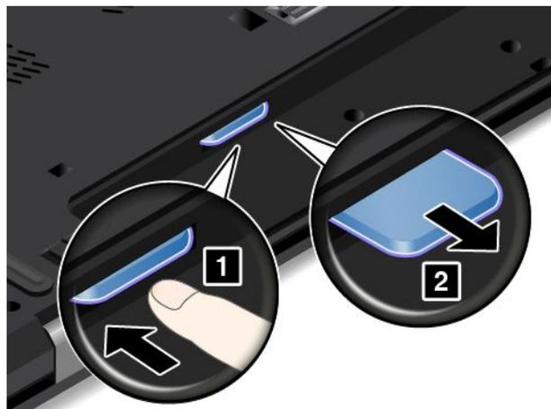
5. Stellen Sie sicher, dass die neue Micro-SIM-Karte richtig ausgerichtet ist, wie in der folgenden Abbildung dargestellt. Setzen Sie die neue Micro-SIM-Karte dann fest in den Steckplatz ein, bis sie hörbar einrastet.
