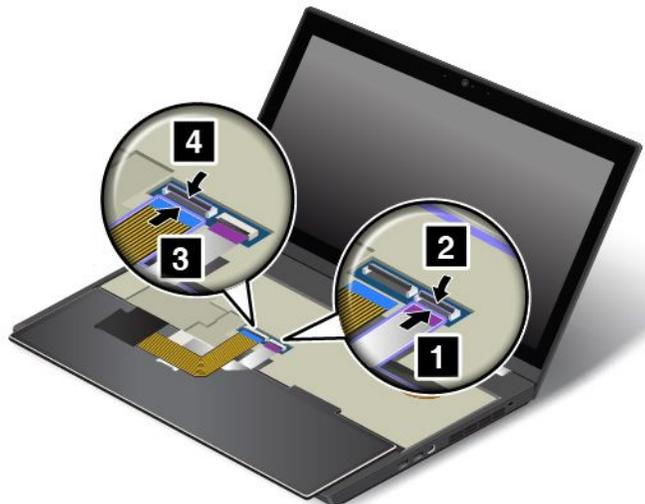
2. Führen Sie die Tastatur wie abgebildet unter den Rahmen der Tastaturblende ein. Stellen Sie sicher, dass sich die vordere Kante der Tastatur (die zum Bildschirm weisende Kante) unter dem Rahmen der Tastaturblende befindet.
