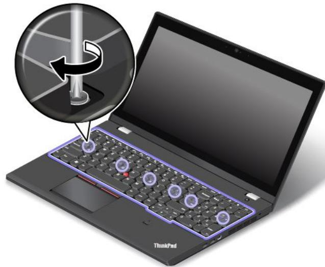
5. Schieben Sie den Tastaturrahmen mithilfe des flachen Endes des Tastatur-Multifunktionswerkzeuges um 2,5 mm nach hinten. Verbergen Sie die Verriegelungen des Tastaturrahmens unter der Tastaturblende, indem Sie die Verriegelungen wie angezeigt mit Ihren Fingern drücken.
