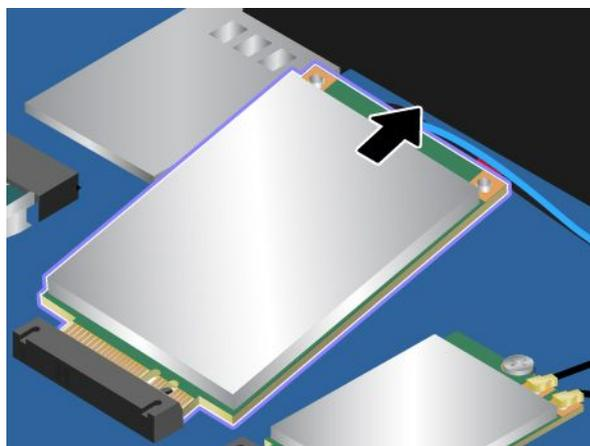
8. Richten Sie den Rand mit den Kontakten der neuen Karte für drahtlose WAN-Verbindungen mit der Einkerbung an der Aussparung des zugehörigen Steckplatzes aus. Setzen Sie dann die neue Karte für drahtlose WAN-Verbindungen vorsichtig in einem Winkel von ca. 20 Grad in den Steckplatz ein. Drehen Sie die Karte für drahtlose WAN-Verbindungen nach unten.
