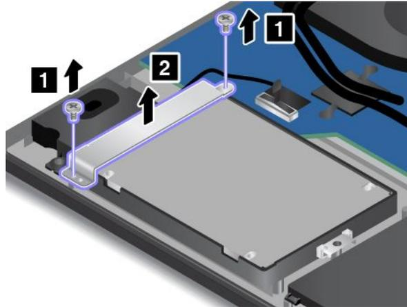
6. Setzen Sie die neue Stabilisierungsleiste des Speicherlaufwerks ein und bringen Sie die Schrauben wieder an.
