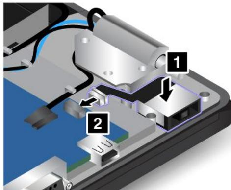
**Achtung:** Verlegen Sie das Netzeingangskabel nicht auf dem Scharnier. Andernfalls kann das Netzeingangskabel beschädigt werden, wenn die Baugruppe für die untere Abdeckung angebracht wird.
