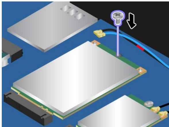
10. Schließen Sie die Antennenkabel an die Karte für drahtlose WAN-Verbindungen an. Stellen Sie sicher, dass das rot markierte Kabel am Hauptanschluss und das blaue Kabel am AUX-Anschluss der Karte für drahtlose WAN-Verbindungen angeschlossen ist.
