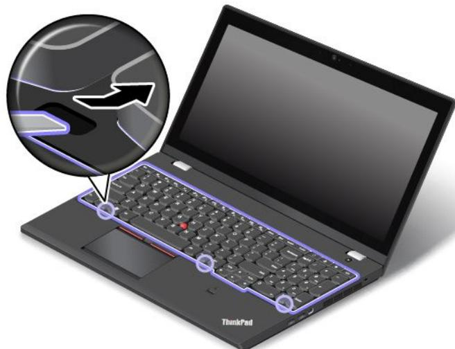
7. Lösen Sie die Schrauben, mit denen die Tastatur gesichert ist, mithilfe der Kreuzschlitzseite des Tastatur-Multifunktionswerkzeugs.
