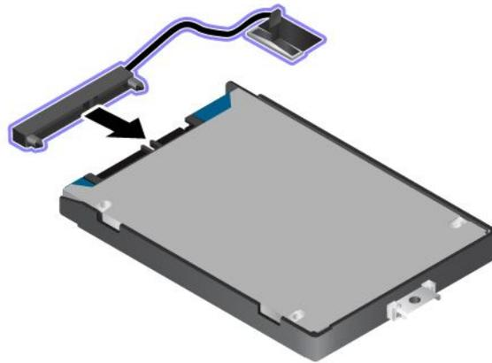
9. Verlegen Sie das Laufwerkskabel zunächst durch die Stabilisierungsleiste des Speicherlaufwerks. Installieren Sie dann das Laufwerk an der entsprechenden Position.
