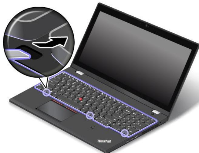
4. Ziehen Sie die Schrauben mit der Kreuzschlitzseite des Tastatur-Multifunktionswerkzeuges an, um die eingesetzte Tastatur zu sichern.
