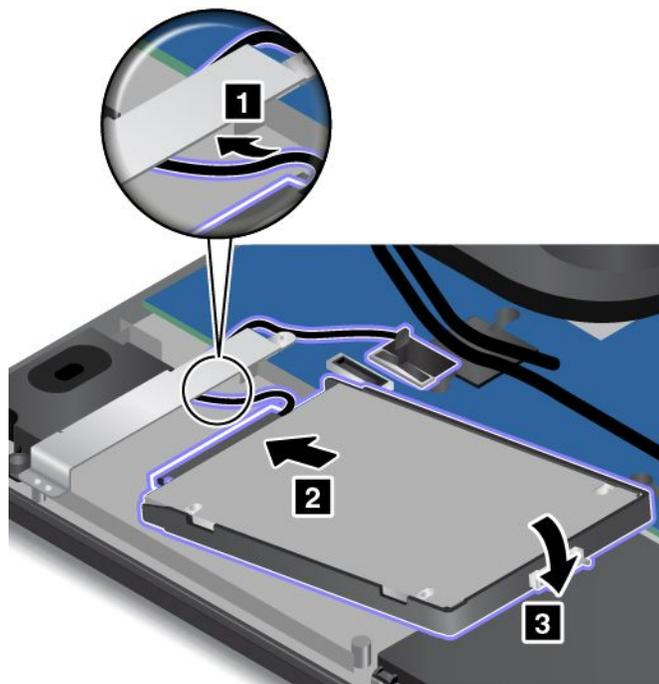
10. Setzen Sie die Schraube zur Befestigung des Speicherlaufwerks wieder ein und schließen Sie das Laufwerkskabel an die Systemplatine an.
