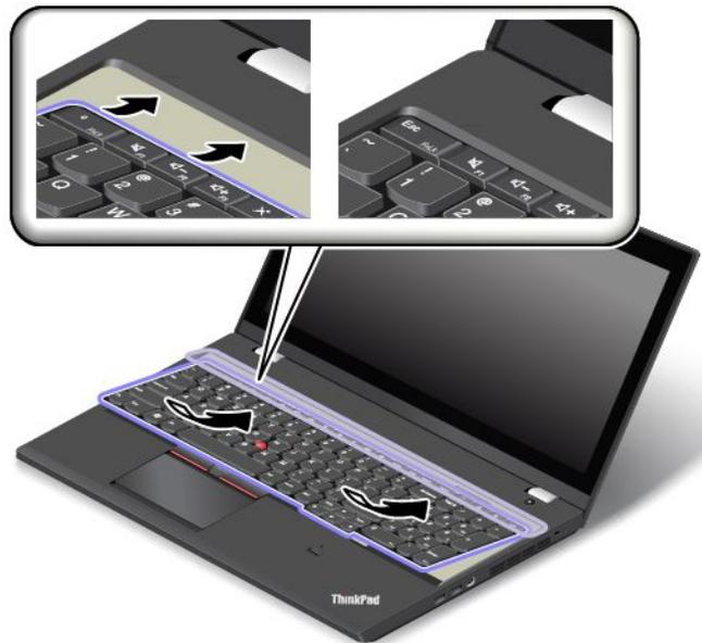
3. Legen Sie die Schraubenköpfe frei, indem Sie den Tastaturrahmen mit dem flachen Ende des Tastatur-Multifunktionswerkzeugs nach vorne schieben. Stellen Sie sicher, dass die Schraubenköpfe vollständig freigelegt sind.
