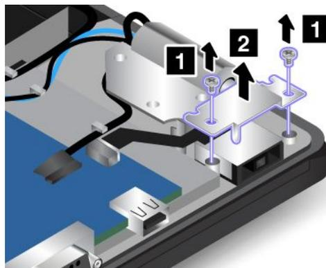
6. Ziehen Sie das Netzeingangskabel von der Systemplatine ab und entfernen Sie dann den Netzeingangskabelsatz.
