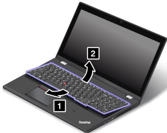
9. Legen Sie die Tastatur vorsichtig auf die Handablage und ziehen Sie die Stecker ab. Anschließend entfernen Sie die Tastatur.
