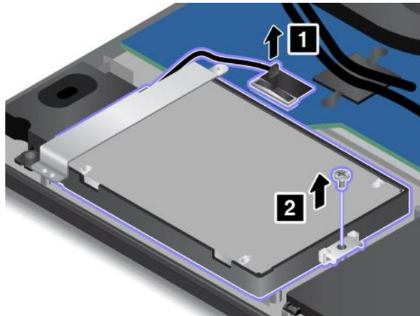
6. Heben Sie das Laufwerk auf der Seite der Schraubvorrichtung an und ziehen Sie das Laufwerk etwas aus der Laufwerksposition heraus **1**. Ziehen Sie das Laufwerkskabel vorsichtig aus der Stabilisierungsleiste des Speicherlaufwerks heraus **2** und entfernen Sie dann das Laufwerk.
