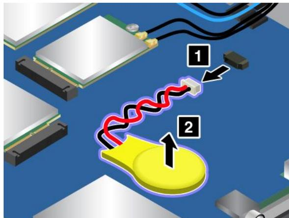
6. Setzen Sie die neue Knopfzellenbatterie **1** ein und schließen Sie dann den Stecker **2** an.
