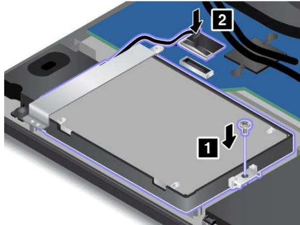
**Achtung:** Verlegen Sie das Kabel nicht auf der Stabilisierungsleiste des Speicherlaufwerks. Andernfalls kann das Kabel beschädigt werden, wenn die Baugruppe für die untere Abdeckung angebracht wird.
