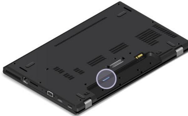
4. Wenn bereits eine Micro-SIM-Karte im Steckplatz installiert ist, drücken Sie vorsichtig auf die Micro-SIM-Karte, damit sie ausgegeben wird, und ziehen Sie sie dann aus dem Steckplatz.
