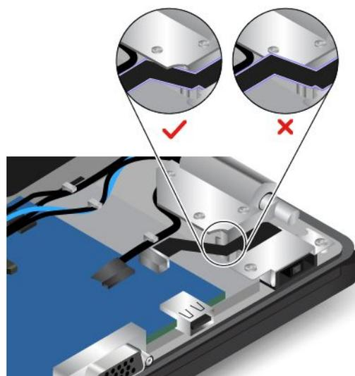
8. Bringen Sie die Halterung wieder an und befestigen Sie sie mit den Schrauben.
