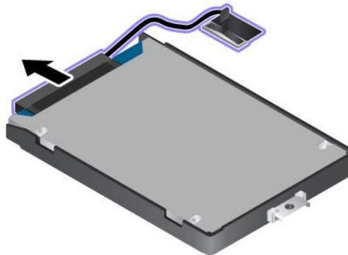
8. Schließen Sie das Laufwerkskabel an das neue Speicherlaufwerk an.
