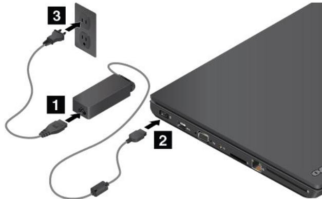
1. Schließen Sie das Netzkabel an das Netzteil an.
