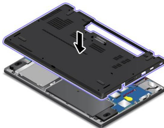
7. Ziehen Sie die Schrauben fest, um die Baugruppe für die untere Abdeckung zu fixieren.
