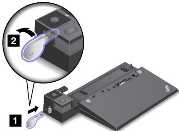
3. Richten Sie die obere linke Ecke des Computers mit der Positionsmarkierung der Andockstation aus. Setzen Sie den Computer vertikal in die Andockstation ein, bis er hörbar einrastet **1**. Drehen Sie dann den Sperrschlüssel für das System in die gesperrte Position (horizontal) **2**.
