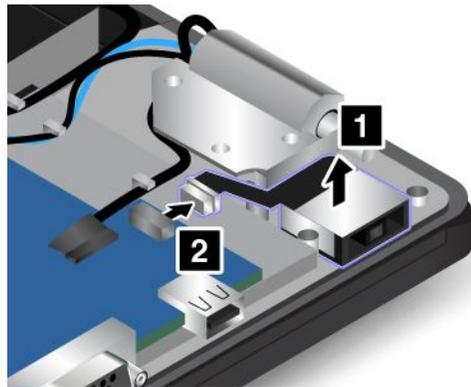
7. Setzen Sie den neuen Netzeingangskabelsatz ein und verbinden Sie das Netzeingangskabel mit der Systemplatine.
