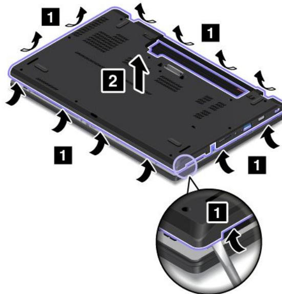
6. Bringen Sie die neue Baugruppe für die untere Abdeckung wieder an der entsprechenden Position an.
