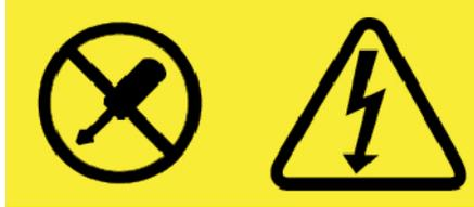
Dentro de cualquier componente que tenga adherida esta etiqueta hay niveles peligrosos de voltaje, corriente y energía. No hay piezas que requieran servicio dentro de estos componentes. Si sospecha que tiene un problema con una de estas piezas, póngase en contacto con un técnico de servicio.
