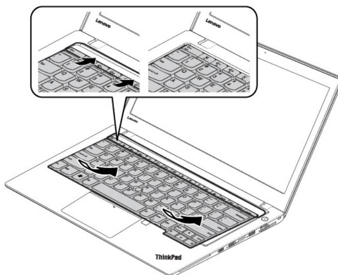
3. Asegúrese de que las cabezas de los tornillos queden completamente expuestas. De lo contrario, mueva las cabezas de los tornillos deslizando el marco del teclado hacia delante con el destornillador plano.
