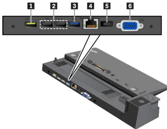
**1 Conector Always On USB 2.0:** conecta los dispositivos compatibles con USB o carga algunos dispositivos y smartphones digitales móviles.
