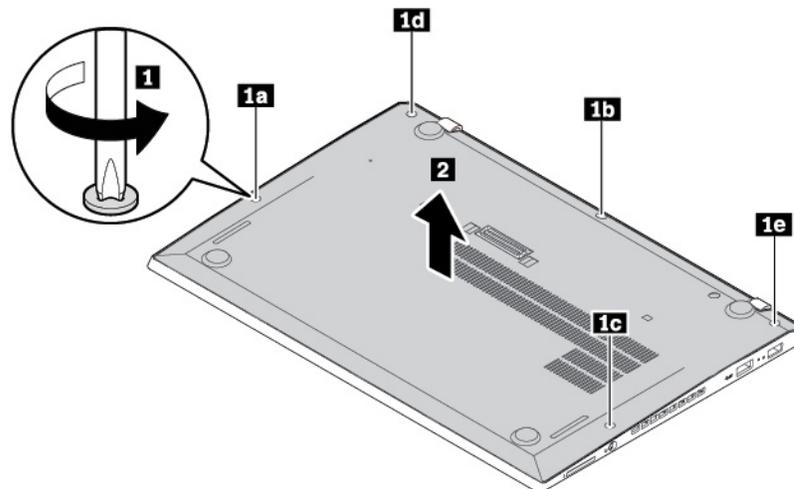
5. Instale la parte inferior del nuevo conjunto de la cubierta de la base como muestra la flecha 1 y asegúrese de que no queden espacios. A continuación, cierre la parte superior del conjunto de la cubierta de la base 2.
