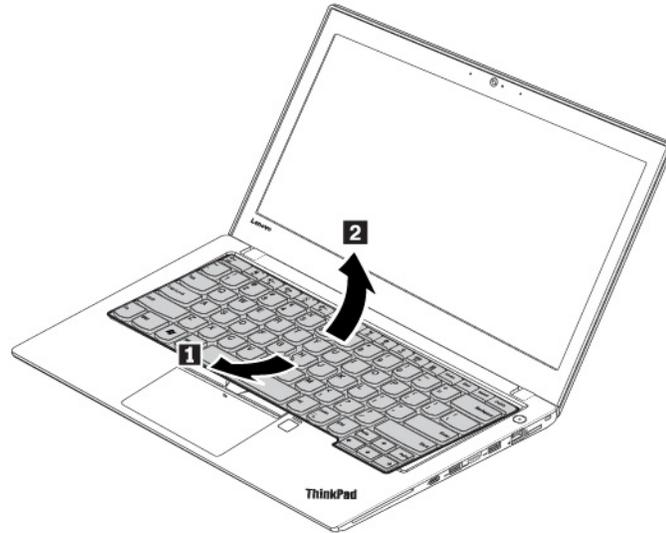
9. Coloque el teclado en el reposa manos y desconecte los conectores. Luego extraiga el teclado.
