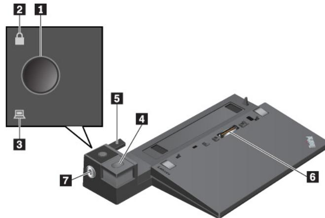
**1 Botón de inicio/apagado:** pulse el botón de inicio/apagado para encender o apagar el sistema.
