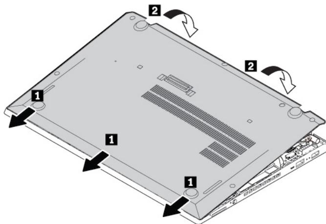
6. Empuje el conjunto de la cubierta de la base como se muestra hasta escuchar un clic.
