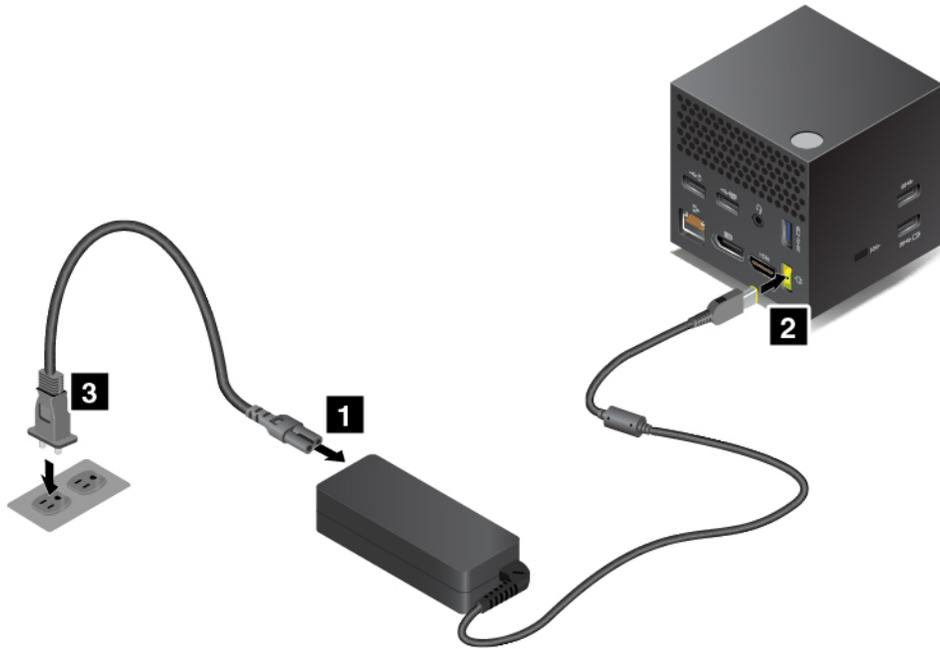
1. Conecte el cable de alimentación al adaptador de alimentación de CA.
