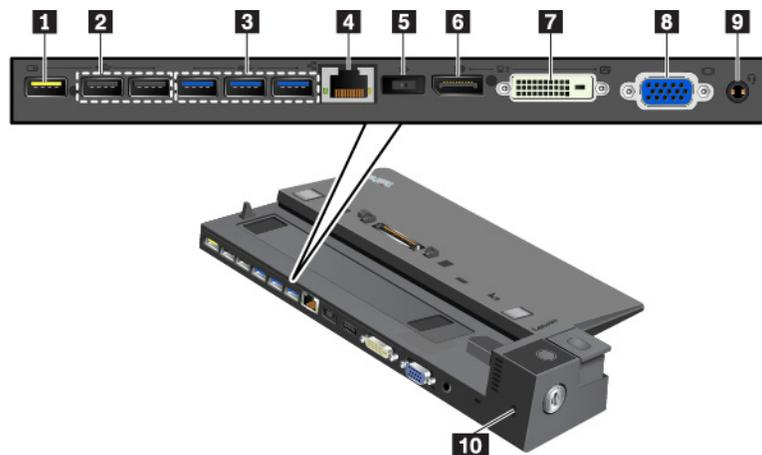
**1** **Conector Always On USB 2.0:** conecta los dispositivos compatibles con USB o carga algunos dispositivos y smartphones digitales móviles.
