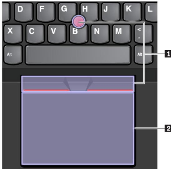
De forma predeterminada, el dispositivo de puntero de TrackPoint y el área táctil se activan con los gestos de contacto habilitados. Para cambiar la configuración, consulte “Personalización del dispositivo de puntero de ThinkPad” en la página 26.
