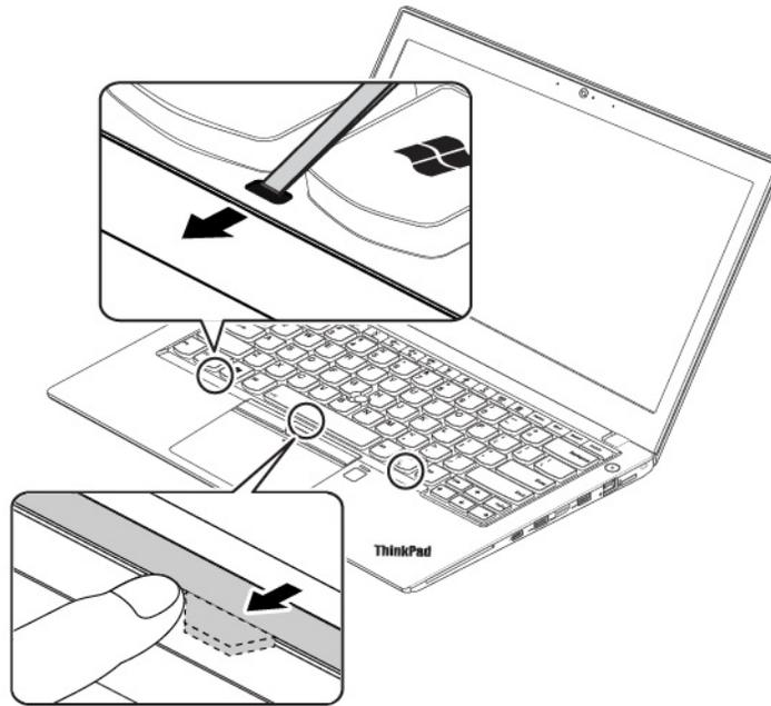
6. Inserte el destornillador plano en los costados del teclado, como se muestra para empujar el marco del teclado hacia atrás. Asegúrese de que no quede espacio entre el marco y el bisel del teclado.
