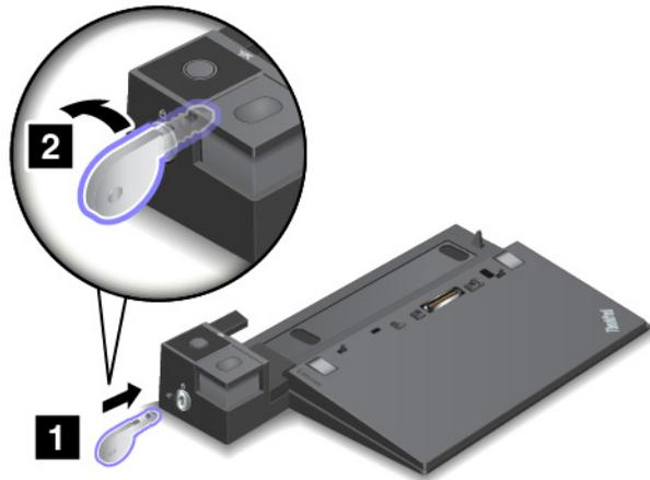
2. Conecte el equipo a la estación de acoplamiento, como se muestra, hasta escuchar un clic **1**. Gire la llave de bloqueo del sistema a la posición de bloqueo (vertical) **2**.
