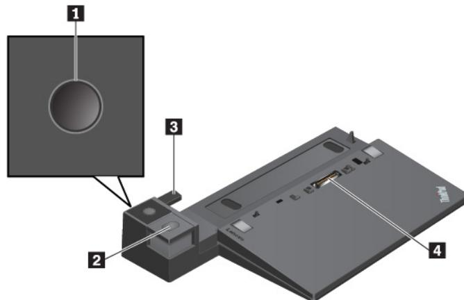
**1 Botón de inicio/apagado:** pulse el botón de inicio/apagado para encender o apagar el sistema.
