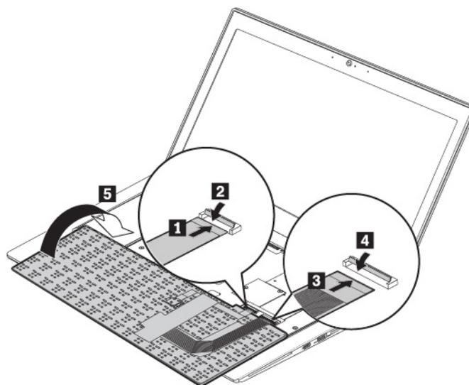
2. Inserte el teclado en el bisel del teclado, como se muestra. Asegúrese de que el borde frontal del teclado (el borde que está cerca de la pantalla) se encuentre bajo el marco del bisel del teclado.
