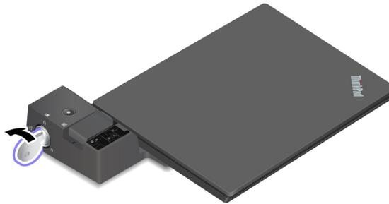
2. 朝所示方向滑动固定栓 **1** 以松开计算机，然后抓住计算机的两边将其卸下 **2**。
