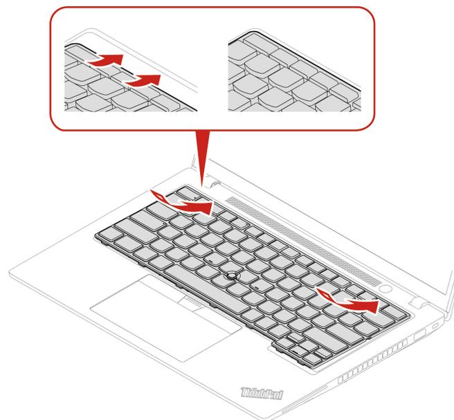
3. Schieben Sie die Tastatur in die dargestellte Richtung. Vergewissern Sie sich, dass die Verriegelungen unter dem Tastaturrahmen gesichert sind.
