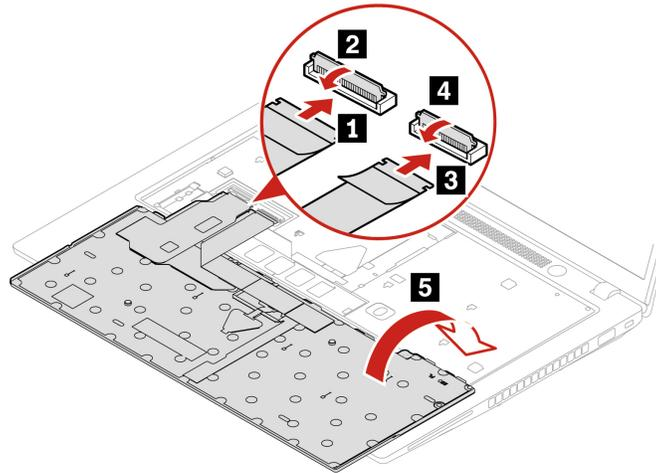
2. Setzen Sie die Tastatur wie abgebildet in die Tastaturblende ein. Vergewissern Sie sich, dass sich die obere Kante der Tastatur (die zum Bildschirm weisende Kante) unter der Tastaturblende befindet.
