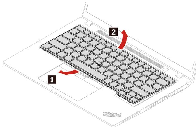
4. Legen Sie die Tastatur auf die Handablage, wie in der Abbildung dargestellt, und ziehen Sie die Steckverbinder ab. Entfernen Sie anschließend die Tastatur.
