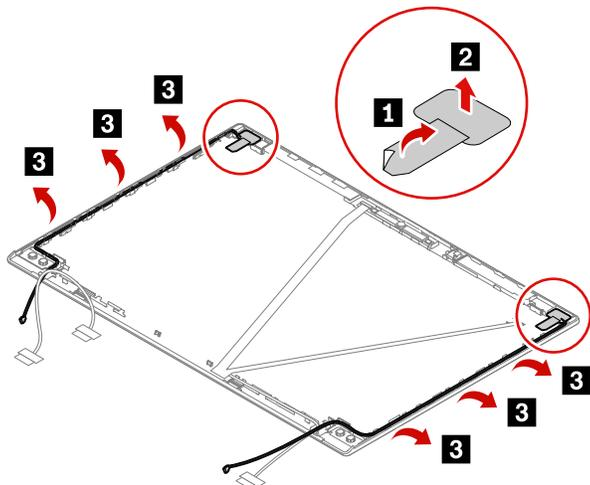
アンテナ・ケーブルを、LCD カバー・アセンブリーのケーブル・ガイドから取り外します。
