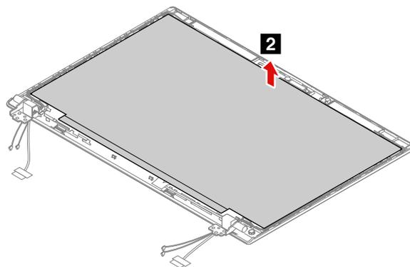
3. LCDパネルを裏返し **3**、図のようにLCDケーブルをLCDパネルから取り外します。
