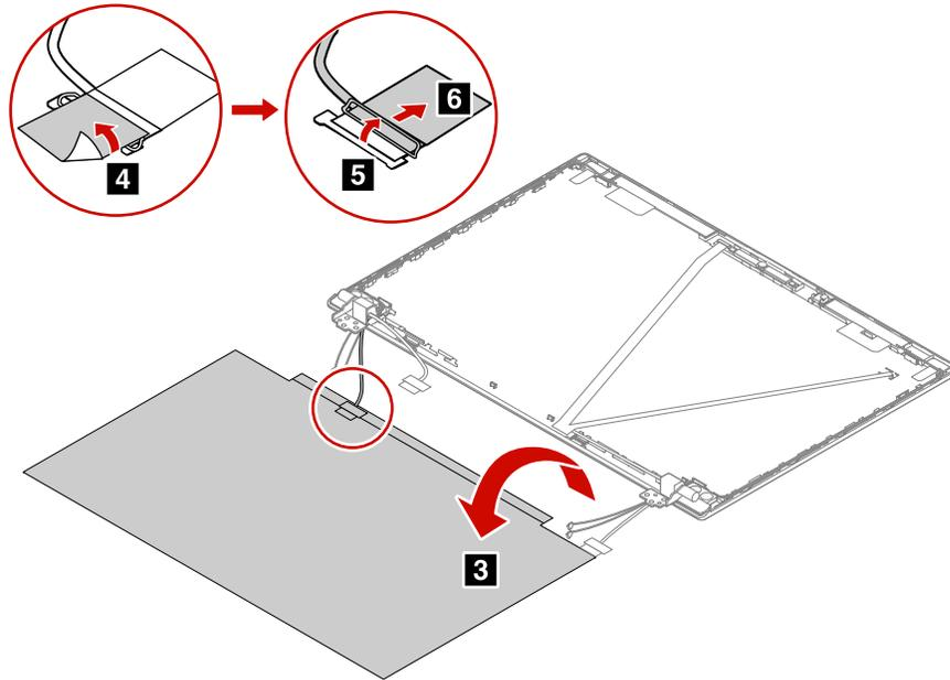
取り付け時の注意: LCD 弾性粘着テープを剥がすと、再使用はできなくなります。交換を行うには、新しい LCD 弾性接着用テープが必要です。
