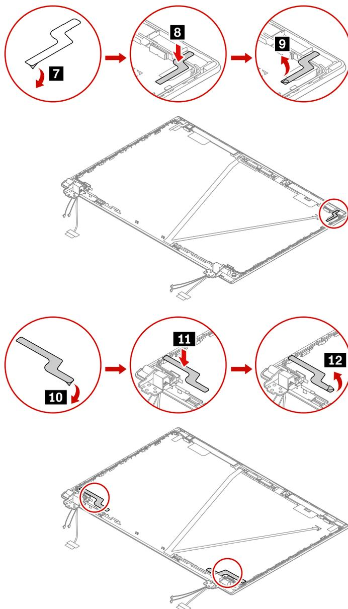
2. 図のように LCD ケーブルを LCD パネルに接続します。LCD パネルを裏返して、テープで LCD パネルを固定します。
