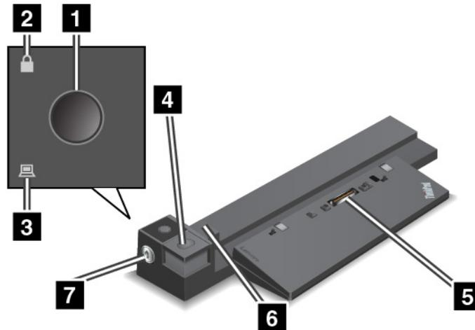
**1 Netzschalter:** Drücken Sie den Netzschalter, um den Computer ein- oder auszuschalten.
