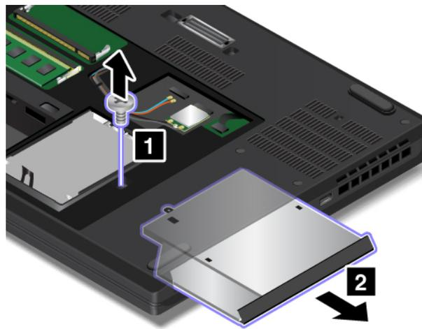
5. Setzen Sie ein neues optisches Laufwerk **1** ein und befestigen Sie es mit der Schraube **2**.
