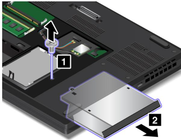
5. Lösen Sie die Schrauben **1** und öffnen Sie die Abdeckung **2**.
