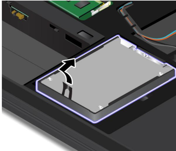
5. Setzen Sie das neue Festplattenlaufwerk mit der Halterung in das Fach ein.
