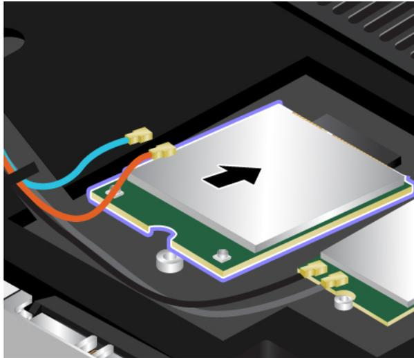
8. Bringen Sie die Schraube an, um die Karte für drahtlose WAN-Verbindungen zu befestigen.
