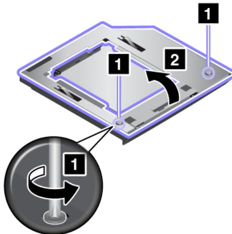
6. Nehmen Sie das Festplattenlaufwerk mit der Halterung heraus, wie in der Abbildung dargestellt.
