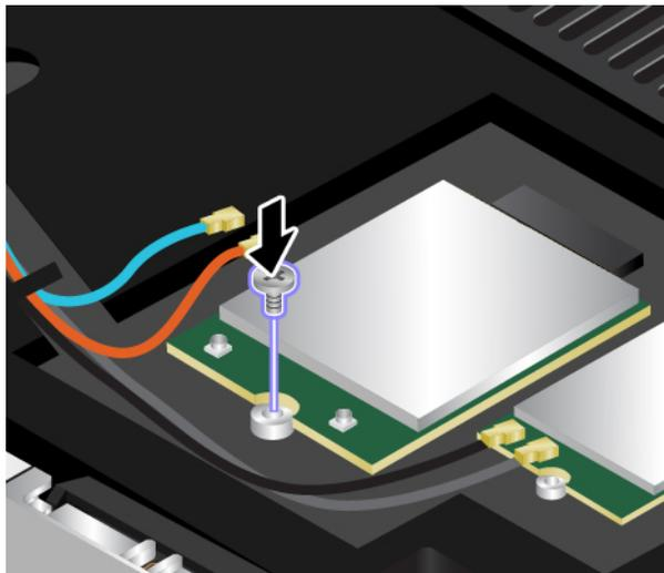
9. Schließen Sie die Kabel an die Karte für drahtlose WAN-Verbindungen an. Vergewissern Sie sich, dass das rote Kabel am Hauptanschluss und das blaue Kabel am AUX-Anschluss der Karte für drahtlose WAN-Verbindungen angeschlossen ist.
