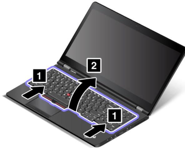
6. Legen Sie die Tastatur auf die Handablage, wie in der Abbildung dargestellt, und ziehen Sie die Steckverbinder ab. Entfernen Sie die Tastatur.
