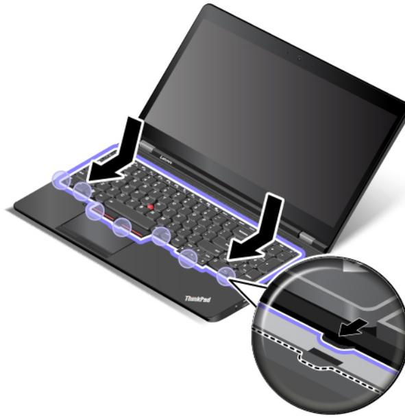
4. Schließen Sie den LCD-Bildschirm, und drehen Sie den Computer um. Bringen Sie die Schrauben an, um die Tastatur zu sichern.
