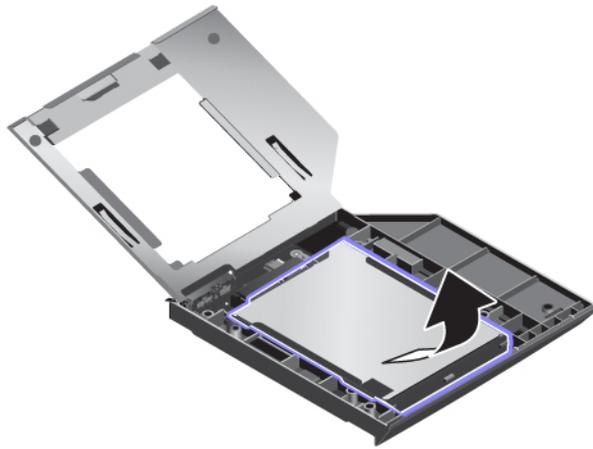
7. Setzen Sie das Festplattenlaufwerk mit der Halterung in den Festplattenlaufwerkadapter ein.
