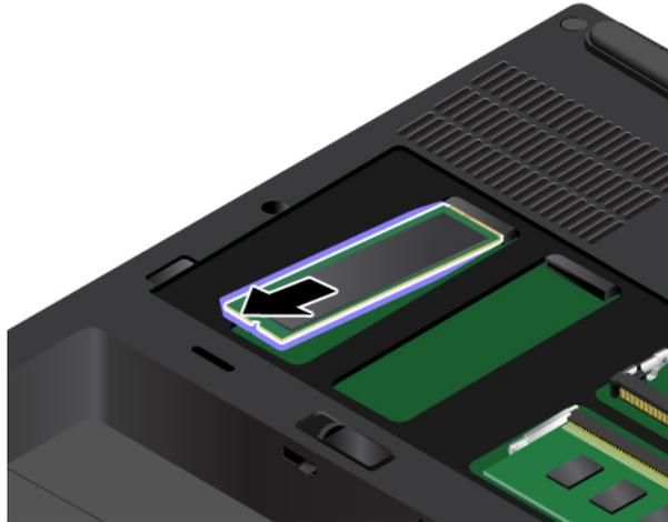
6. Richten Sie die Kante mit den Kontakten des neuen M.2-Solid-State-Laufwerks an der Aussparung des zugehörigen Steckplatzes aus. Setzen Sie dann das M.2-Solid-State-Laufwerk vorsichtig in einem Winkel von ca. 20 Grad in den Steckplatz ein **1**. Drehen Sie das M.2-Solid-State-Laufwerk nach unten **2**.
