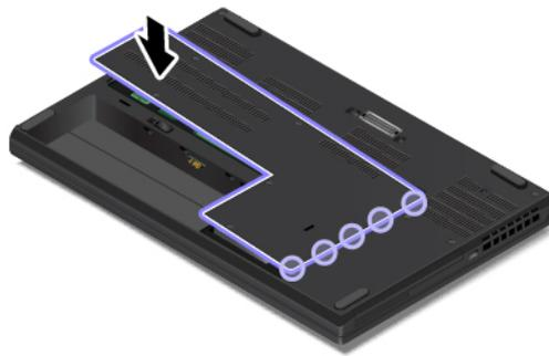
6. Ziehen Sie die Schrauben fest, um die untere Abdeckung zu befestigen.
