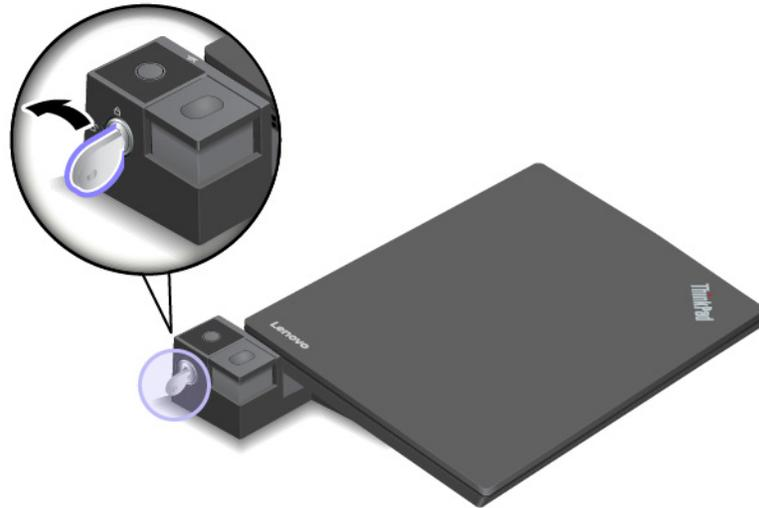
3. Drücken Sie die Entnahmetaste, um den Computer **1** zu entnehmen. Halten Sie den Computer an beiden Seiten und entfernen Sie ihn **2**.
