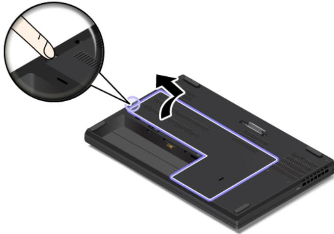
5. Bringen Sie die neue untere Abdeckung an, wie in der Abbildung dargestellt. Vergewissern Sie sich, dass die Verriegelungen der unteren Abdeckung unter der Baugruppe der Grundplattenabdeckung gesichert sind.
