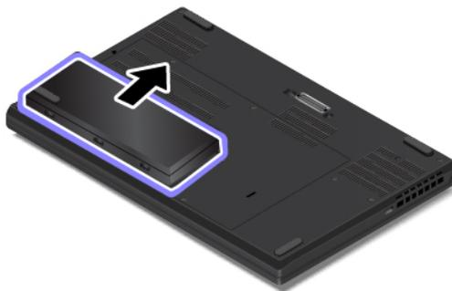
4. Setzen Sie entsprechend der Abbildung einen neuen Akku ein. Stellen Sie sicher, dass der Akku fest in seiner Position eingesetzt ist.
