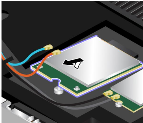
7. Richten Sie den Rand mit den Kontakten der neuen Karte für drahtlose WAN-Verbindungen mit der Einkerbung an der Aussparung des zugehörigen Steckplatzes aus. Setzen Sie dann die neue Karte für drahtlose WAN-Verbindungen vorsichtig in einem Winkel von ca. 20 Grad in den Steckplatz ein. Drehen Sie die Karte für drahtlose WAN-Verbindungen nach unten.
