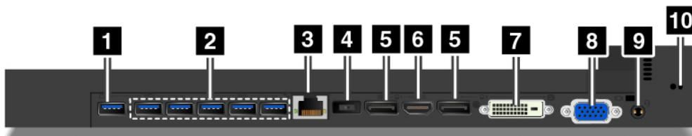
**1 Always On USB-Anschluss:** Zum Anschließen von USB-kompatiblen Einheiten oder zum Aufladen einiger digitaler Mobileinheiten und Smartphones.
