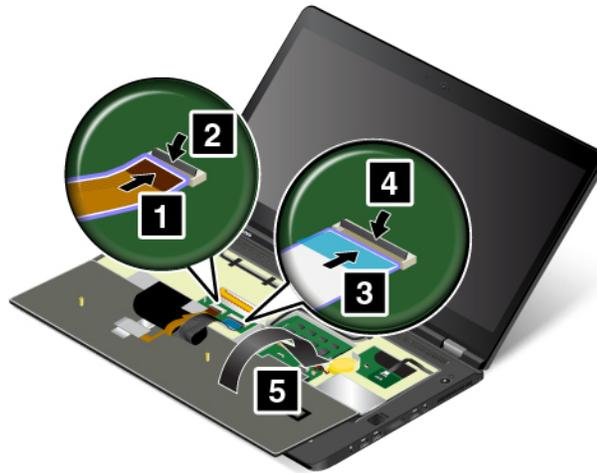
2. Setzen Sie die Tastatur wie abgebildet ein. Vergewissern Sie sich, dass sich die vordere Kante der Tastatur (die zum Bildschirm weisende Kante) unter der Tastaturblende befindet.
