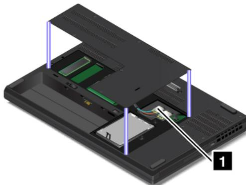
**Anmerkung:** Stellen Sie beim drahtlosen Modul, das vom Benutzer installiert werden kann, sicher, dass Sie nur ein von Lenovo autorisiertes drahtloses Modul verwenden, das speziell für dieses Computermodell getestet wurde. Andernfalls wird der Computer beim Einschalten eine Sequenz von Fehlercode-Signaltönen ausgegeben.
