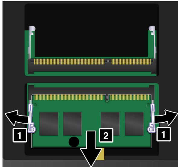
5. Setzen Sie das Speichermodul in einem Winkel von etwa 20 Grad in den Speichersteckplatz ein **1**. Klappen Sie das Speichermodul nach unten, bis es hörbar einrastet **2**. Stellen Sie sicher, dass das Speichermodul fest im Speichersteckplatz installiert ist und nur schwer bewegt werden kann.
