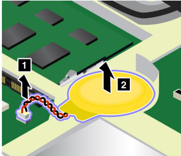
7. Setzen Sie die neue Knopfzellenbatterie **1** ein und schließen Sie dann den Stecker **2** an.
