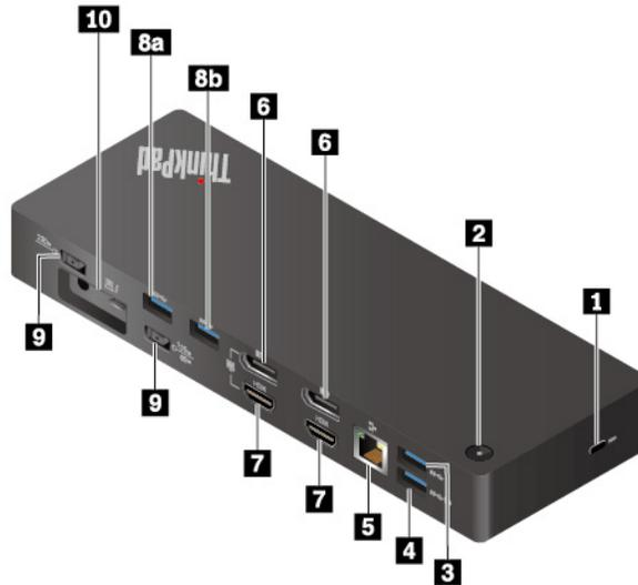
**1 Schlitz für Sicherheitsschloss:** Zum Schutz vor Diebstahl können Sie das Dock mit einer Sicherheitskabelverriegelung, die in den Schlitz für die Sicherheitsverriegelung am Dock passt, an Arbeitsplatz, Tisch oder einer anderen Haltevorrichtung anschließen.
