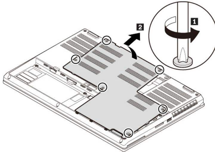
5. Befestigen Sie die neue untere Abdeckung **1**. Ziehen Sie die Schrauben fest, um die untere Abdeckung **2** zu befestigen.
