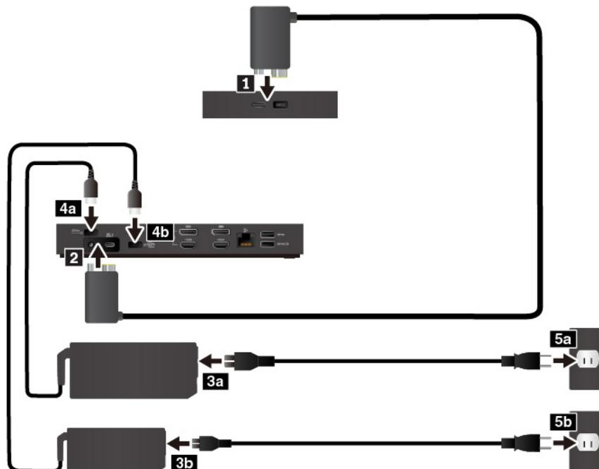
1. Schließen Sie das eine Ende des Thunderbolt 3 Workstation-Kabels an den Computer an **1**.
