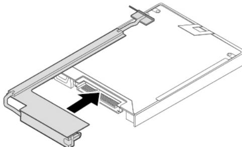
10. Setzen Sie das neue Speicherlaufwerk **1** das Fach ein und drehen Sie das Laufwerk nach unten **2**. Stellen Sie sicher, dass das neue Speicherlaufwerk eingerastet ist. Schließen Sie anschließend den Anschluss an die Systemplatine an **3**.
