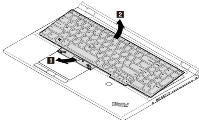
7. Legen Sie die Tastatur auf die Handablage, wie in der Abbildung dargestellt, und ziehen Sie die Steckverbinder ab. Anschließend entfernen Sie die Tastatur.
