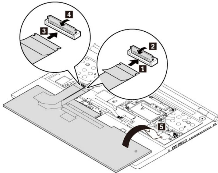
2. Setzen Sie die Tastatur wie abgebildet in die Tastaturblende ein. Vergewissern Sie sich, dass sich die vordere Kante der Tastatur (die zum Bildschirm weisende Kante) unter der Tastaturblende befindet.
