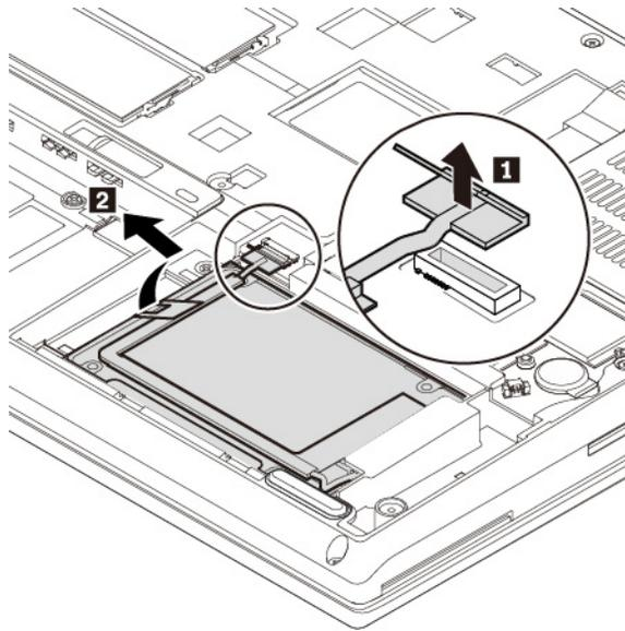
6. Ziehen Sie das Kabel wie dargestellt vom internen Speicherlaufwerk ab.
