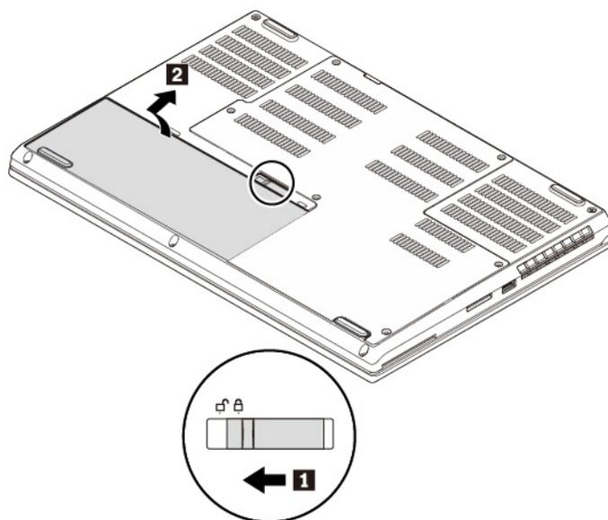
4. Setzen Sie einen neuen Akku ein **1** und drücken Sie ihn hinein, bis er hörbar einrastet **2**. Stellen Sie sicher, dass sich die Akkuverriegelung in der gesperrten Position befindet.
