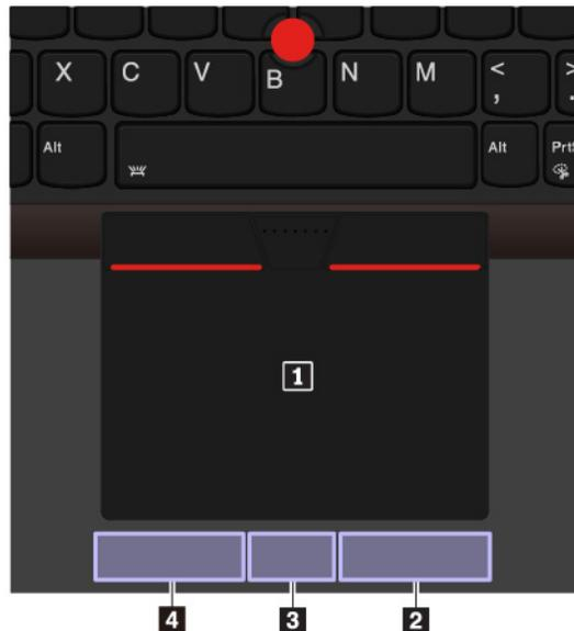
Wenn die Trackpad-Oberfläche ölig oder fettig ist, schalten Sie den Computer zunächst aus. Wischen Sie die Trackpad-Oberfläche anschließend vorsichtig mit einem weichen, fusselreien Tuch ab, das mit lauwarmem Wasser oder einer für Computer geeigneten Reinigungsflüssigkeit befeuchtet wurde.
