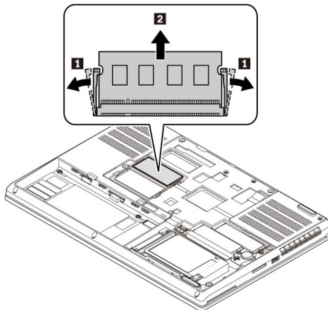
7. Setzen Sie das neue Speichermodul in einem Winkel von etwa 20 Grad in den Speichersteckplatz ein **1**. Klappen Sie das Speichermodul nach unten, bis es hörbar einrastet **2**. Stellen Sie sicher, dass das Speichermodul fest im Speichersteckplatz installiert ist und nur schwer bewegt werden kann.
