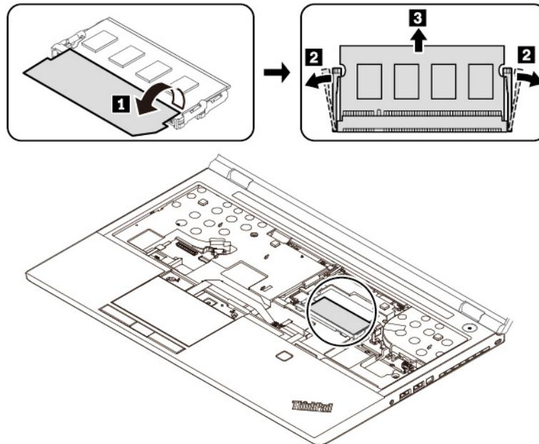
6. Setzen Sie das neue Speichermodul in einem Winkel von etwa 20 Grad in den Speichersteckplatz ein **1**. Klappen Sie das Speichermodul nach unten, bis es hörbar einrastet **2**. Stellen Sie sicher, dass das Speichermodul fest im Speichersteckplatz installiert ist und nur schwer bewegt werden kann.
