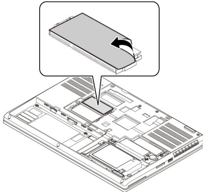
6. Öffnen Sie die Verriegelungen an beiden Seiten des Speichersteckplatzes gleichzeitig **1** und entfernen Sie das Speichermodul **2**.
