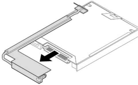
7. Entfernen Sie die Halterung wie dargestellt vom internen Speicherlaufwerk.
