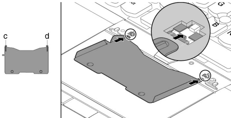
5. Drehen Sie das Werkzeug in die Richtung, wie in der Abbildung dargestellt, um die Tastatur freizugeben **1**. Schieben Sie die Tastatur in die durch die Pfeile **2** gekennzeichnete Richtung, um die Verriegelungen von der Tastaturblende freizugeben.
