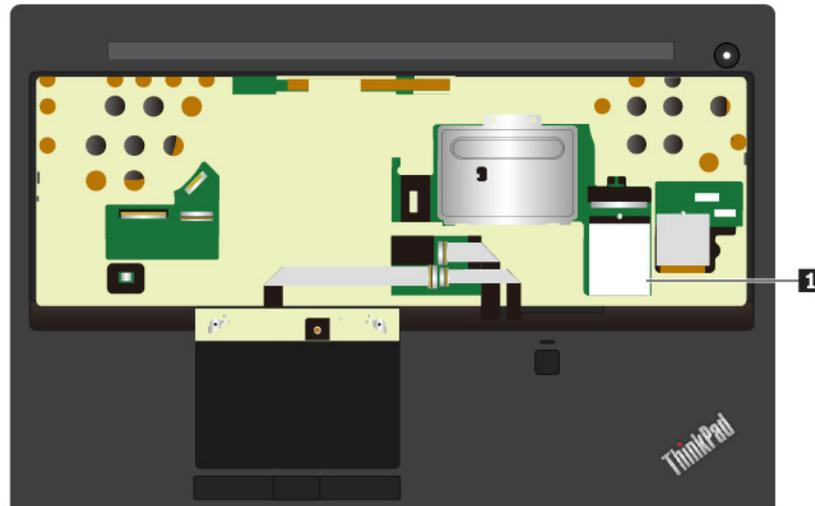
**Anmerkung:** Stellen Sie für das durch den Benutzer installierbare Modul sicher, dass Sie nur ein von Lenovo autorisiertes drahtloses Modul verwenden, das speziell für dieses Computermodell getestet wurde. Andernfalls wird der Computer beim Einschalten eine Sequenz von Fehlercode-Signaltönen ausgegeben.
