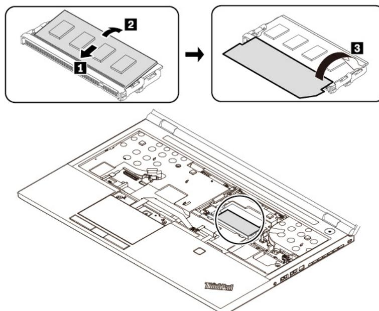
7. Installieren Sie die Schutzhalterung **1**. Stellen Sie sicher, dass die beiden Bohrungen in der Halterung mit den kleinen Laschen am Speichersteckplatz ausgerichtet sind **2**. Befestigen Sie die Schutzhalterung wieder mit der Schraube **3**.
