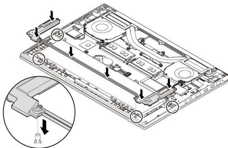
8. ケーブルを図のように配線し、スピーカー・アセンブリのコネクターを接続します。
