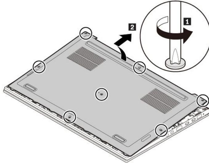
5. 図のように新しい下部カバーを取り付け、ねじを締めます。
