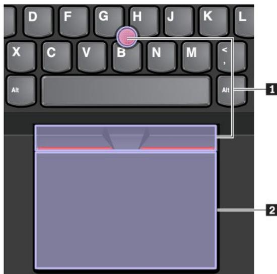
デフォルトでは、TrackPoint ポインティング・デバイスおよびトラックパッドのどちらでもタッチ・ジェスチャーが使用可能になっています。設定を変更するには、21 ページの「ThinkPad ポインティング・デバイスのカスタマイズ」を参照してください。
