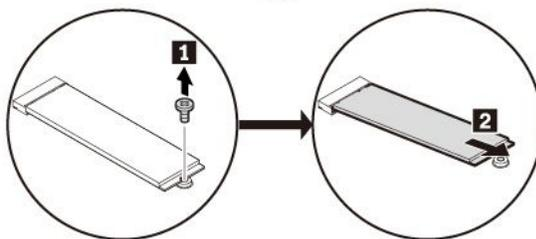
6. 新しい M.2 ソリッド・ステート・ドライブの接続部分を、スロットのキーと合わせます。次に、新しい M.2 ソリッド・ステート・ドライブを約 20 度の角度でスロットに慎重に挿入します。M.2 ソリッド・ステート・ドライブを倒してねじを取り付けます。
