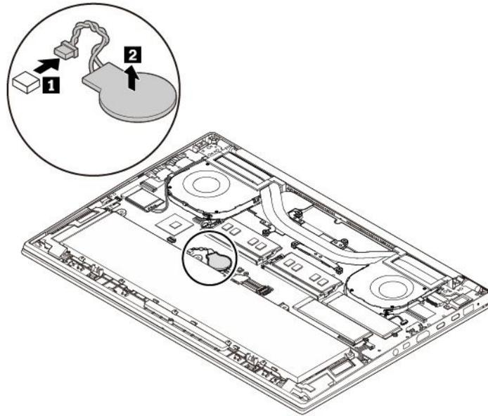
6. 新しいコイン型電池を取り付け、コネクタを取り付けます。
